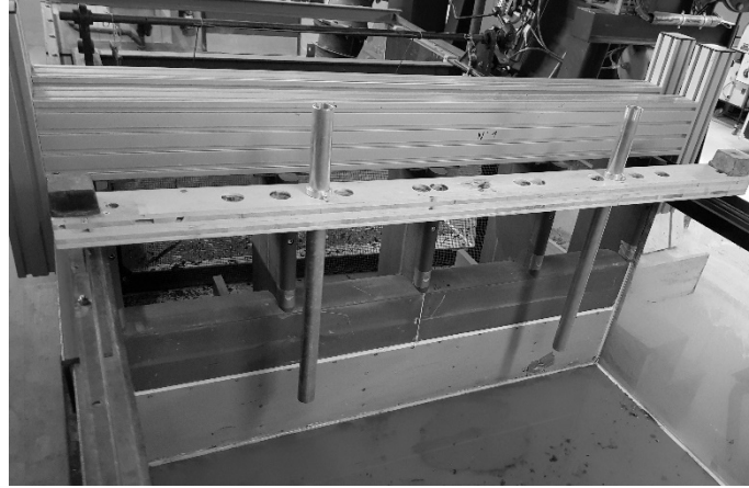
Figure 11. Exemple de râtelier partiel en amont du déversoir (Figure 19).
