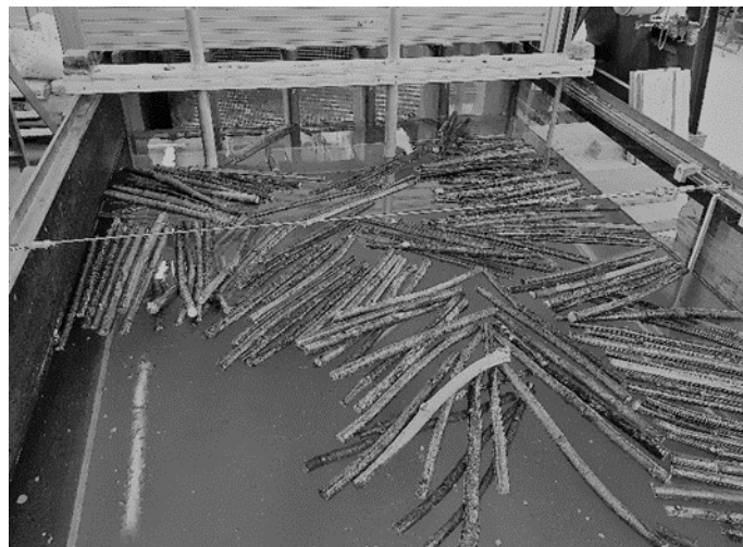
Figure 35. Blocage contre les barres du râtelier partiel (Test 211).
