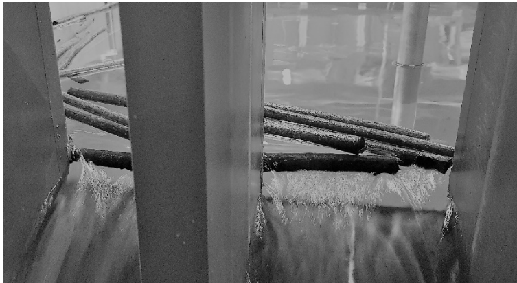
Figure 22. Bois bloqués contre les piliers alors que le mouvement de rotation avait été initié par la barre du râtelier partiel (libre de blocage, en arrière-plan, Test 6, position 1 « distant »).
