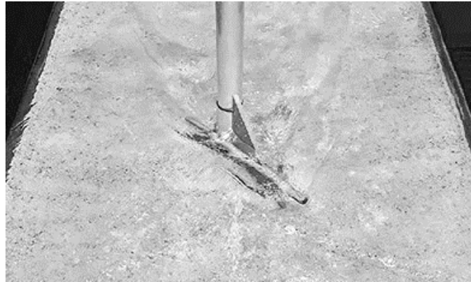
Figure 7. Exemple de configuration d'ailettes sur pilier testée par Schalko et al. (2020).
