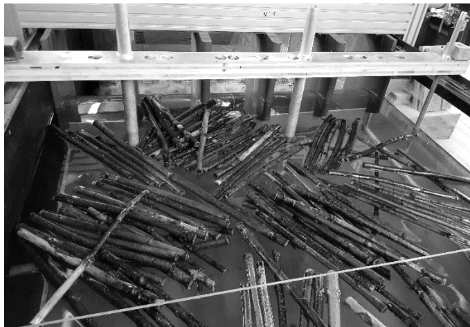
Figure 57. Blocage de bois flottants contre le râtelier et les piliers avec un tapis retenu à l'amont (Test 509).
