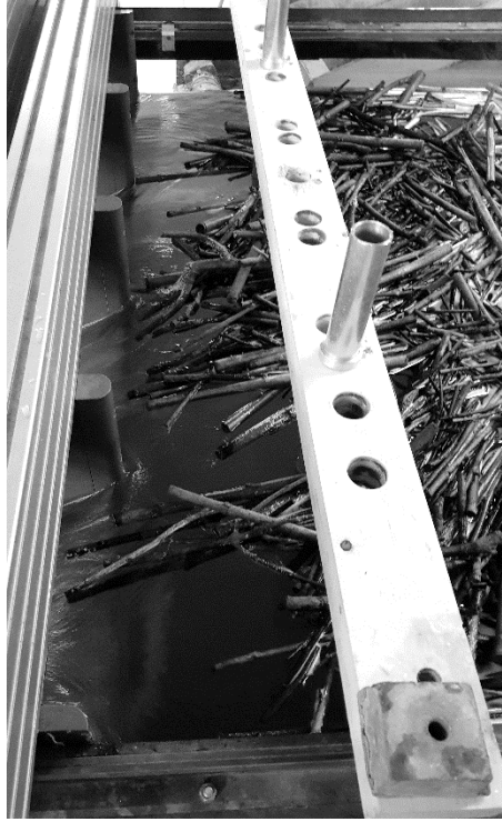
Figure 49. Avancement des troncs contre les piliers du déversoir (Test 284).
