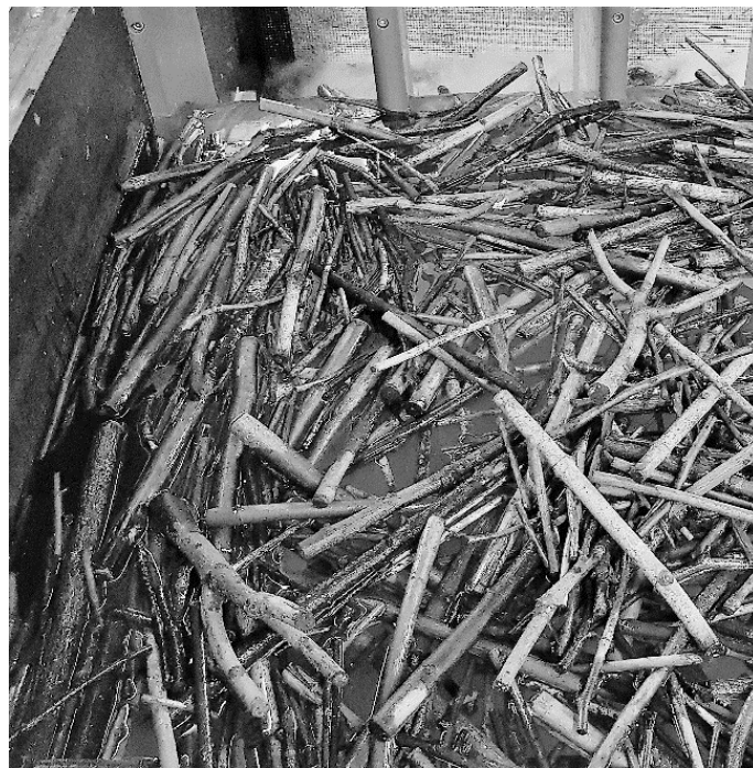
Figure 14. Alignement des bois flottants à proximité de la paroi (Test 302).
