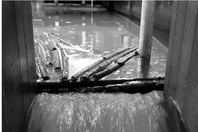
Figure 56. Blocage de troncs perpendiculaires aux piliers avec petite accumulation en amont (Test 488, vue depuis l'aval).
