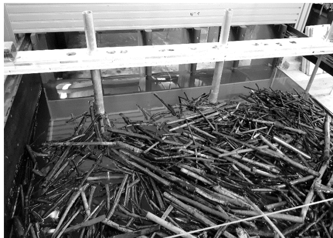
Figure 48. Blocage des troncs contre les barres du râtelier avec un déversoir libre (Test 284).
