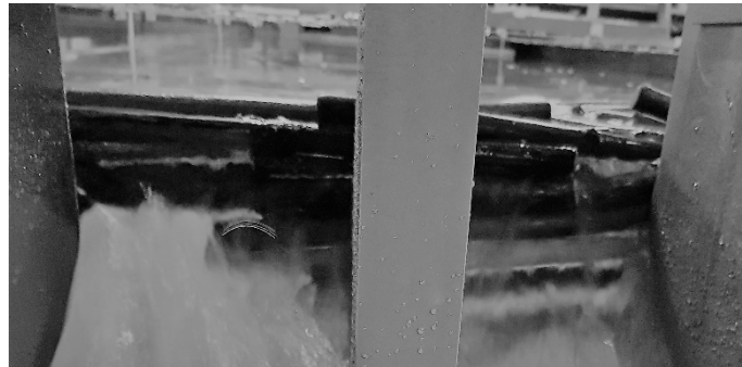
Figure 24. « Mur » de bois contre les piliers (Test 112, position 4 sans râtelier).
