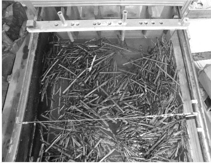
Figure 58. Tapis de bois flottants retenu contre le râtelier (Test 473).
