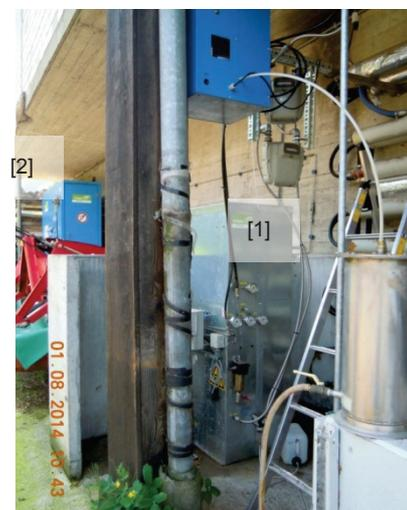
Abbildung 7: Erstes Funktionsmuster [1] im Betrieb, im Hintergrund der Hochdruckspeicher [2]
