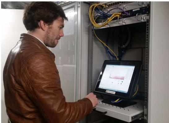
Abbildung 10: Industrie-PC mit Eigenverbrauchsmanager-Software zur Steuerung aller Verbraucher in einem Gebäude (Quelle: Smart Energy Control)
