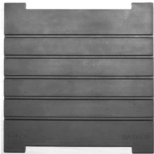
Abbildung 7-1: Zwischenlage für UIC60-Versuch
