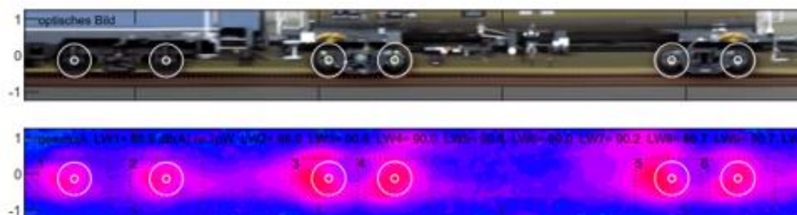
Abbildung 3-4: Rollgeräusch beim Kesselwagen mit 80 km/h aus Mikrofonarraymessungen A-bewertete Quellenintensitäten (PROSE)
