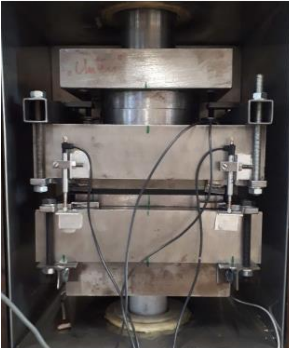
Abbildung 10-3: Testaufbau für statische und niederfrequente Tests
