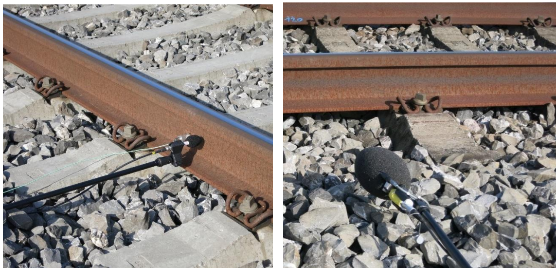
Abbildung 6-1: Messung Schienenschall über Schallintensitäten - zwei Verfahren (PROSE 2017)
