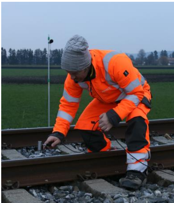
Messung der TDR an den Abschnitten im Dezember 2019
