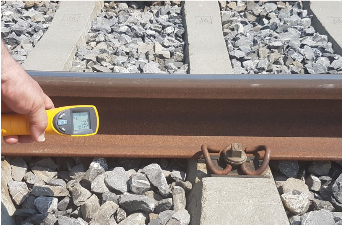
Schientemperatur während TDR Messung am 26.06.2020 um 12.30
