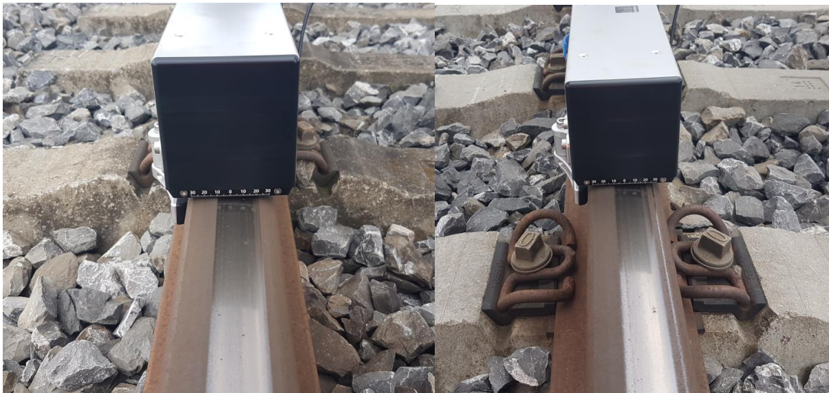
Schienenrauheitsmessung im Dezember 2019 und Fahrspiegel
