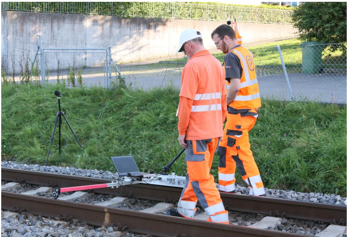
Rauheitsmessung am Versuchsabschnitt Bogen Riedmatt
