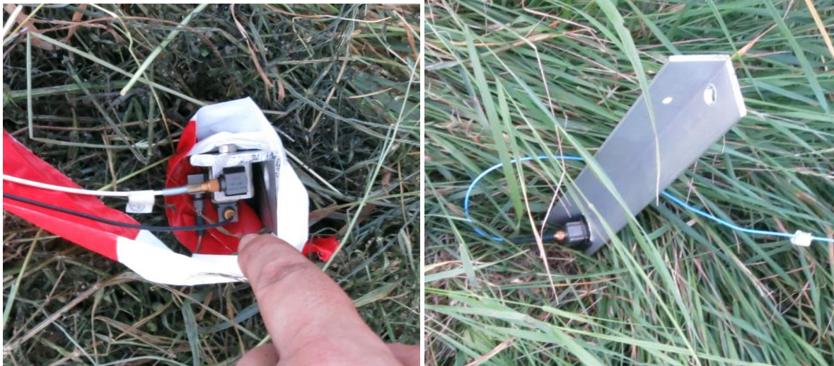
Triaxiale Sensoren für die Erschütterungsmessung an einem Aluminiumwinkel im Erdboden
