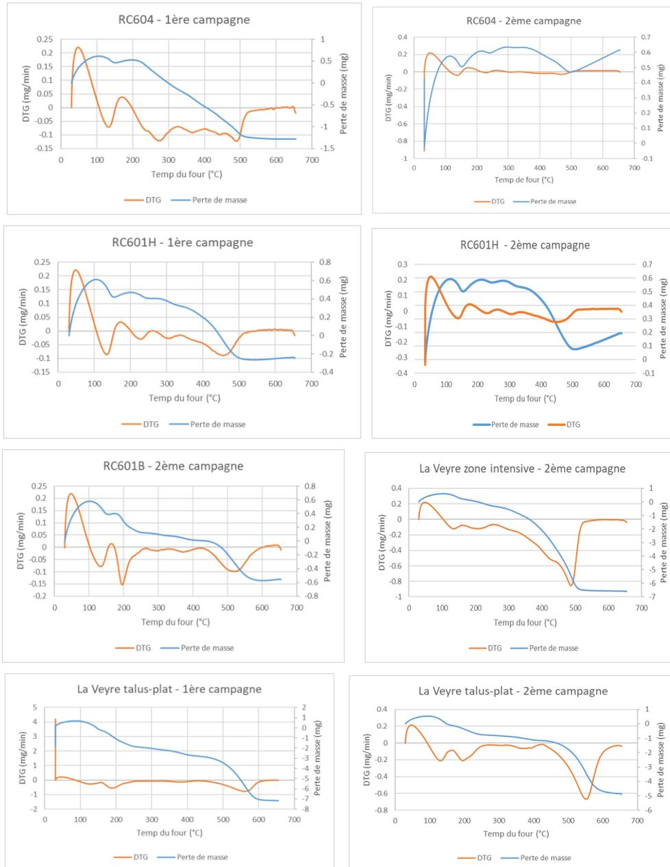
Figure 26 : Thermogrammes des analyses ATG pour la perte de masse et DTG des plastiques
