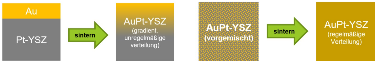
Abbildung 9: Bisherige Sintervariante (links) und neue Sintervariante (rechts)
