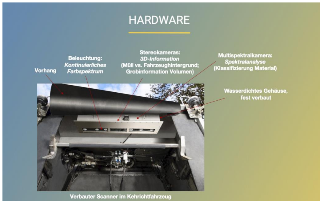
Abbildung 4: Aufbau technische Komponenten Grüngutscanner
