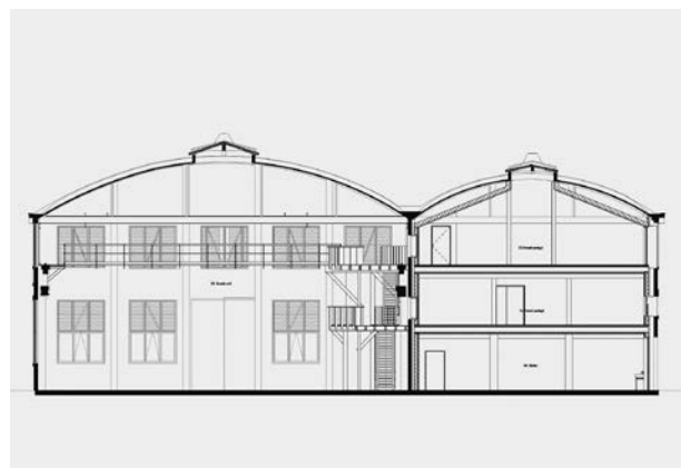
4 Querschnitt der Grande Halle mit den baulichen Eingriffen.
