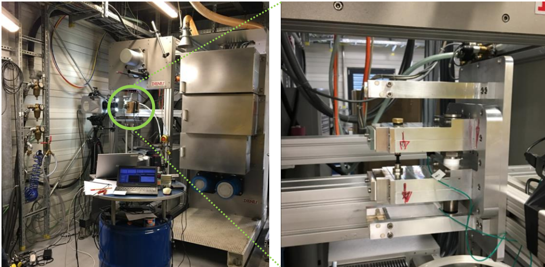
Abbildung 21: Testaufbau am ITA (links) mit Tandemkonfiguration des Oszillators montiert (rechts).
