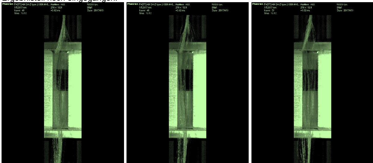
Abbildung 8: Typische Standbilder der Hochgeschwindigkeitsaufnahmen. Framerate: 50'000 fps, Abstand der Bilder 0.1 ms.
