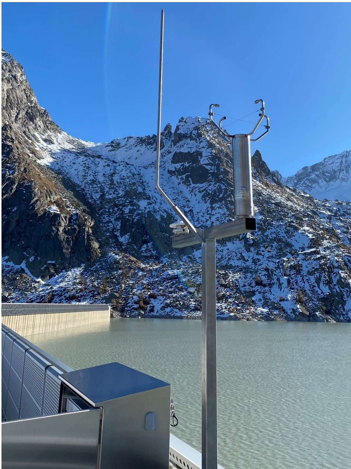
Abbildung 3 Wetterstation bei GAK 3 mit Windmesser, Pyranometer und Si-Einstrahlungssensor (an Südseite GAK erkennbar)
