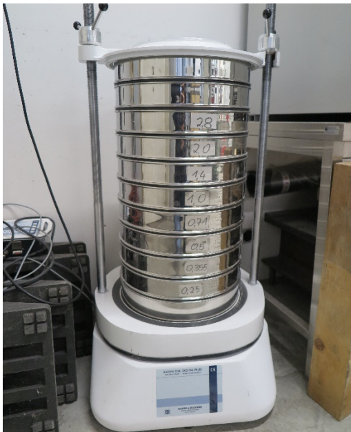
Abbildung 26: Analysensiebmaschine EML 450 Digital Plus T der Marke Haver & Boecker
