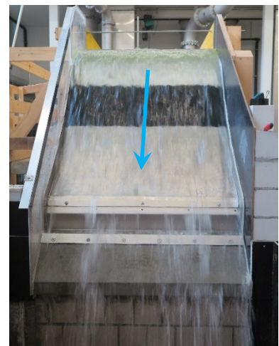
c) \frac{3}{4} Abklebung 300 l/s \hat{=} 269 l/s.lfm 9-10 l/s Überfall
