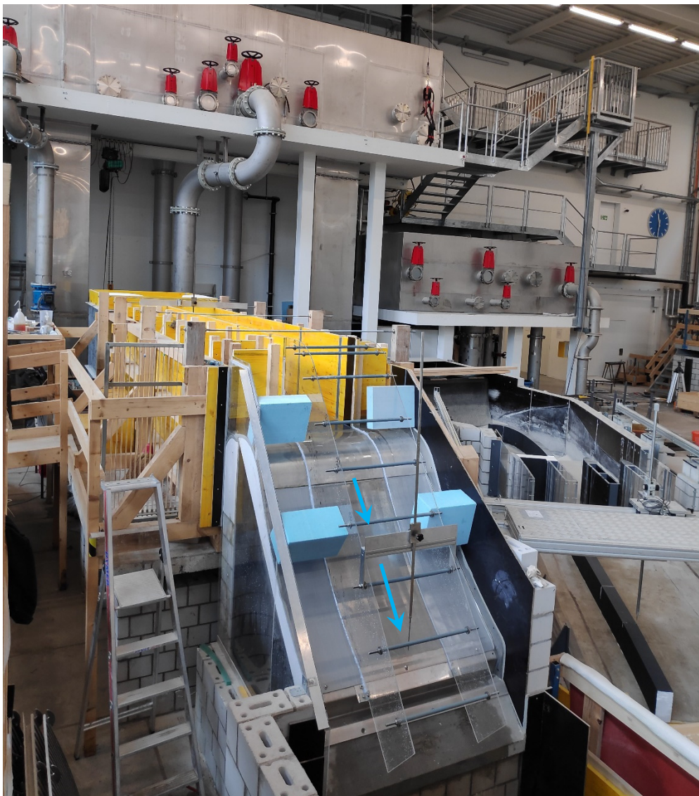
Abbildung 21: Versuchsstand auf 0.5 m verschmälert, blaue Pfeile zeigen die Fließrichtung an
