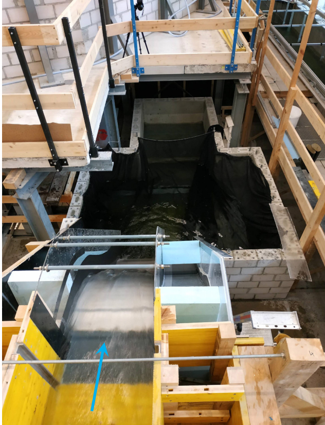
Abbildung 33: Zulauf, Wehr und Kolk mit Netz
