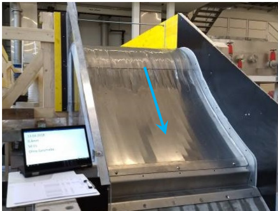
a) Spaltweite 0.4 mm
