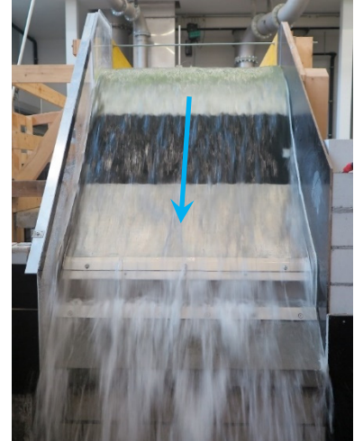
f) 300 l/s \hat{=} 269 l/s.lfm Überfall: 30 l/s Schluckvermögen um 10 % reduziert
