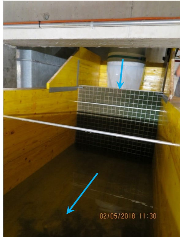
Abbildung 28: Die blauen Pfeile markieren die Fließrichtung des Wassers. a) Geschiebeauffangsack beim Triebwasserablauf b) Wasserkreislauf Unterbecken/Rücklauf. c) Trocknungsöfen
