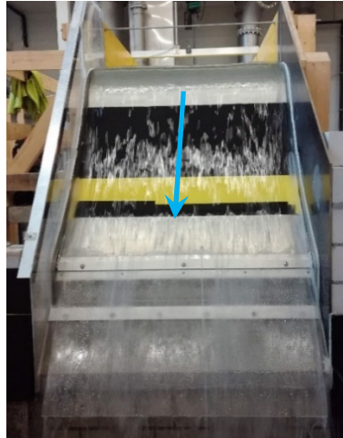
e) \frac{3}{4} Abklebung 100 l/s \triangleq 90 l/s.lfm 20 l/s Überfall
