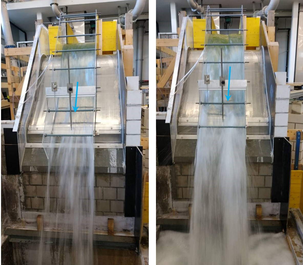
Abbildung 46: Klarwasserversuche am Rechen Sb18 1.0 von Wild Metal GmbH auf der verschmälerten Anlage, blaue Pfeile markieren die Fließrichtung. a) mit Durchfluss 400 l/s.lfm b) mit Durchfluss 600 l/s.lfm.
