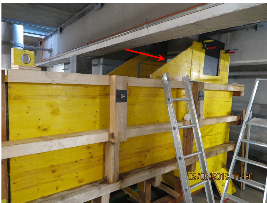
a) b) Abbildung 19: Zulaufstrecke der Versuchsanlage. Die blauen Pfeile markieren die Fließrichtung. a) Frontansicht, im Hintergrund befindet sich die Einlaufwanne aus Stahl. Eine hellblaue Styroporplatte schwimmt an der Wasseroberfläche und dient der Wasserberuhigung. b) Aufsicht mit Überfall und eingesetztem Coanda-Rechen.
