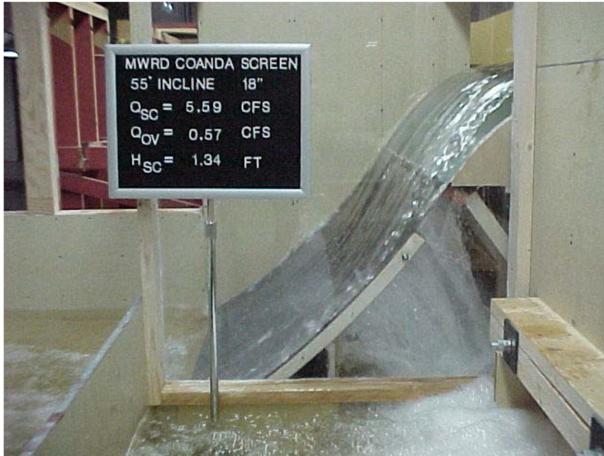
Abbildung 10: Modellversuch am Coanda-Rechen im Bureau of Reclamation, Denver, Colorado (USA) (Wahl, 2003)
