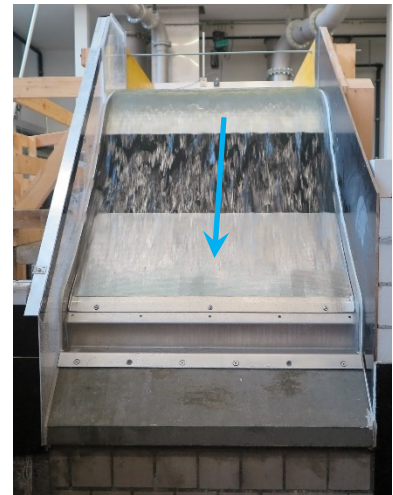
c) 150 l/s \triangleq 134.5 l/s.lfm kein Überfall
