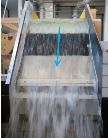
d) \frac{1}{2} Abklebung 300 l/s \triangleq 269 l/s.lfm 30 l/s Überfall
