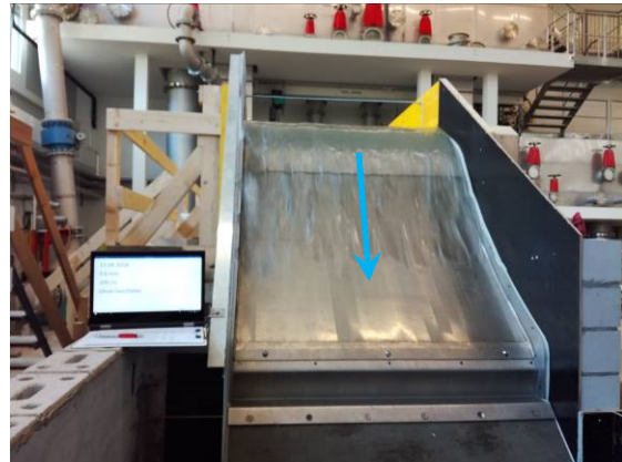
b) Spaltweite 0.6 mm
