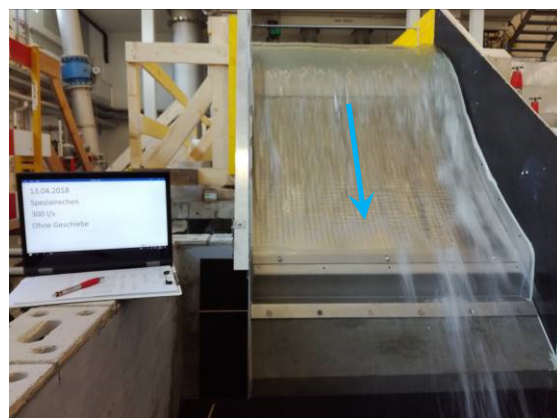
f) Durchfluss 269 l/s.lfm, Überfall 20 l/s
