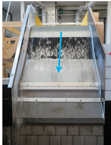
b) 100 l/s \triangleq 89.7 l/s.lfm kein Überfall
