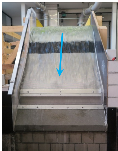
b) \frac{1}{4} Abklebung 300 l/s \hat{=} 269 l/s.lfm 1-2 l/s Überfall
