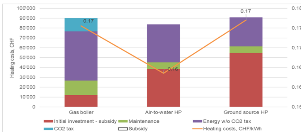
Figure 15 : Coûts de chauffage dans un bâtiment unifamilial pour une chaudière à gaz (à gauche), une chaudière air/eau (au milieu) et une chaudière géothermique (à droite). Le graphique à barres représente les investissements et la ligne orange les coûts de chauffage
