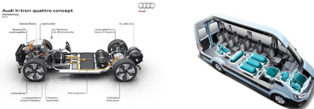
Abbildung 3: Einbauorte mit unterschiedlichen Bauraumanforderungen: Einbau des Luftkompressors unter der Motorhaube (links, Quelle: Audi) mit Anforderung an Kompaktheit im Gesamtvolumen; Einbau des gesamten Brennstoffzellensystems inklusive Kompressor im Zwischenboden (rechts, Quelle: Hyundai) mit Anforderung dass der Luftkompressor einen möglichst geringen Durchmesser aufweisen soll.
