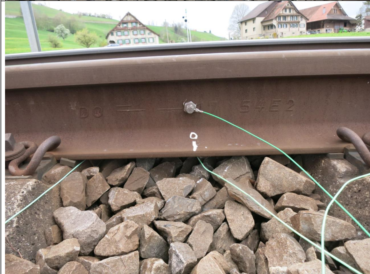
28.04.2021 Km 6.4 Beschleunigungs- sensoren
