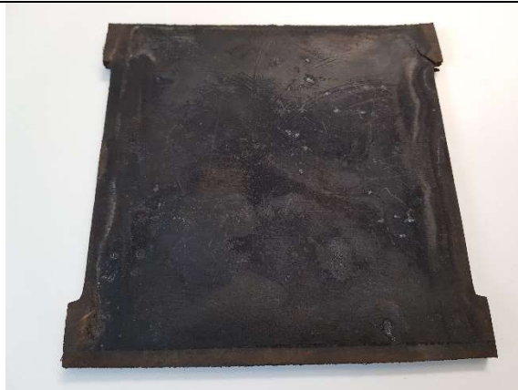
Bild 5: Ausgebaute Zw mit Rissen
