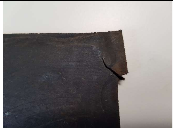
Bild 6: Zw-Riss bei einspringender Ecke
