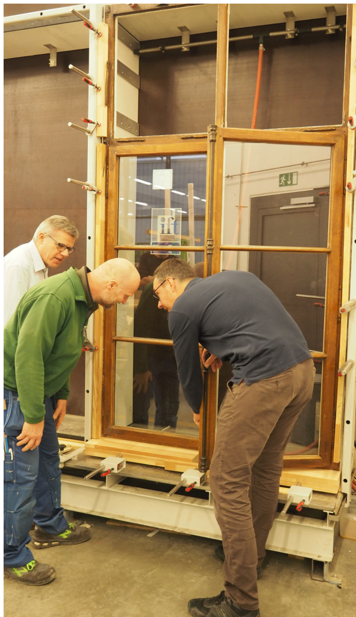
La rénovation économe en énergie des fenêtres historiques d'un bâtiment classé à Bâle a été évaluée. En installant un vitrage isolant sous vide tout en préservant le châssis des fenêtres historiques, l'isolation thermique peut être améliorée d'un facteur 3 (réduction de la valeur U de 4,9 à 1,5). Photo: Martin Gruber
