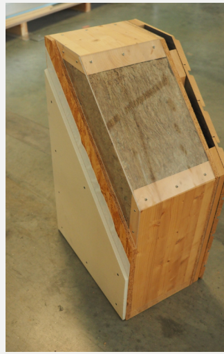
Un élément mural conventionnel avec isolation en laine de roche (à gauche) est nettement plus large que le nouvel élément avec isolation en aérogel. Photos: Martin Gruber
