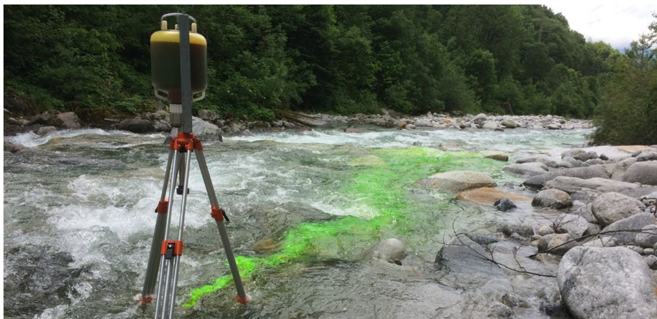
Mesures de débit par traçage (urarine) dans les petits cours d'eau, ici dans la Mera à Soglio (GR)
