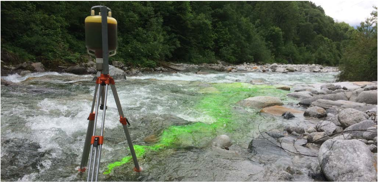
Abflussmessung in kleineren Flüssen mit Tracern (Uranin). Hier an der Mera in Soglio (GR)
