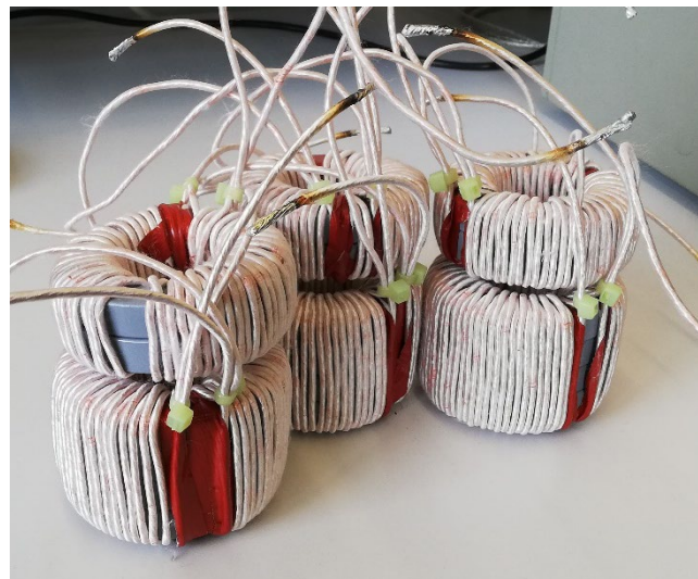
Abbildung 8: Die fertig gewickelten Induktivitäten L_1 und L_2 .
