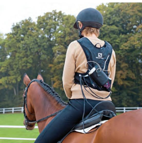
Die Messmatte unter dem Sattel ist über ein Kabel mit dem Datenlogger im Rucksack der Reiterin verbunden.
