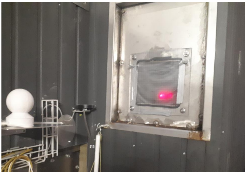
Abbildung 14: Kontrollöffnung mit dem Laser auf der Elektrode
