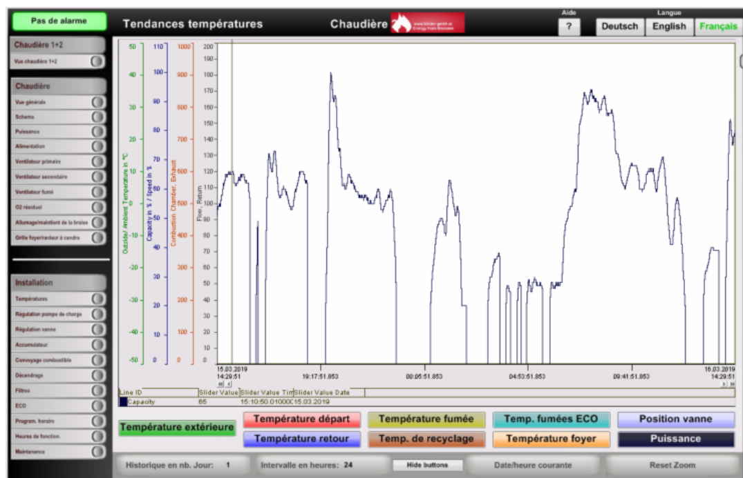
Abbildung 15: Lastschwankungen beim Kessel bis September 2020
