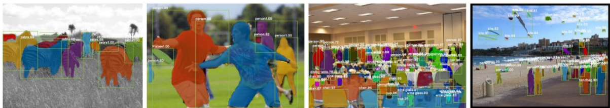
Abbildung 3: Binärmasken in der automatischen Instanzsegmentierung mit Mask R-CNN (übernommen von Farooq, 2018).
