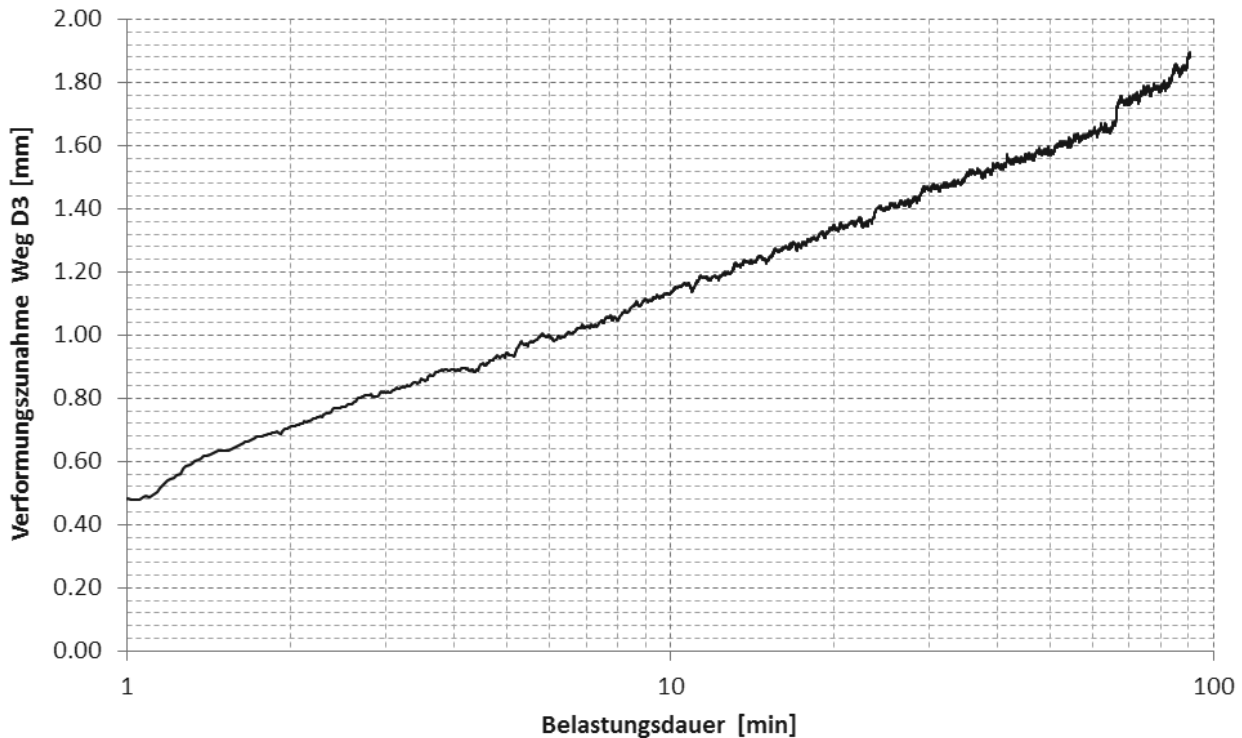
Abb. 4.30: Versuch am Prüfkörper des Herstellers PS: Zunahme der Durchbiegung im Punkt D3 während der 90 Minuten dauernden Belastung mit der 3-fachen Gebrauchslast.
