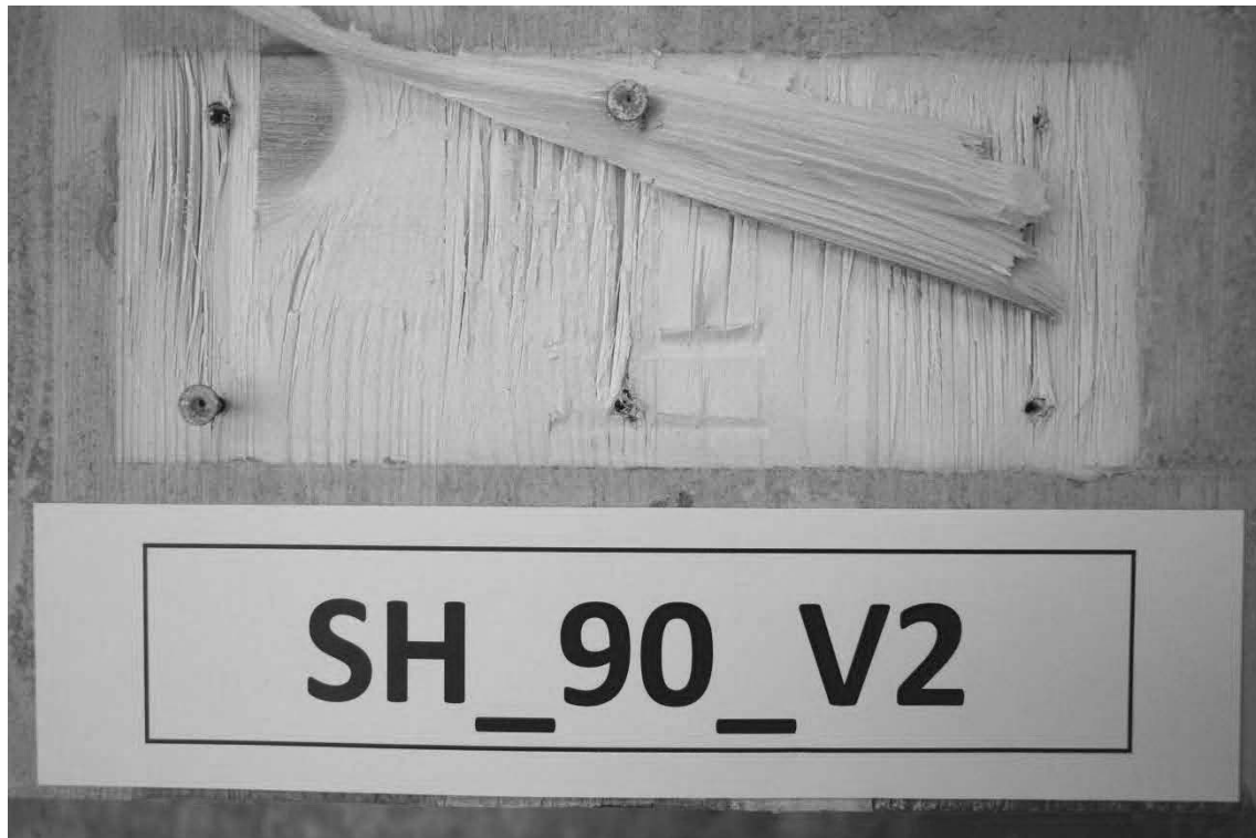
Abb. D.20: Hersteller B, Schubnocken zusätzlich verschraubt mit 6 Schrauben, Prüfkörper 2, MHP Seite 1.
