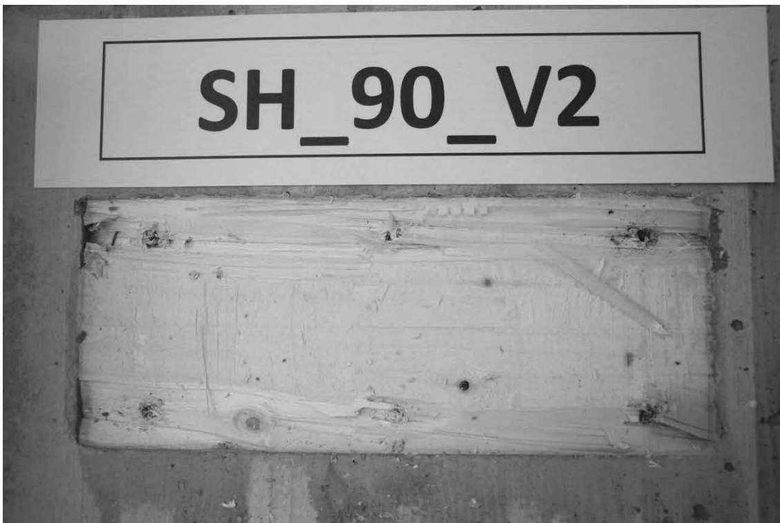
Abb. D.23: Hersteller B, Schubnocken zusätzlich verschraubt mit 6 Schrauben, Prüfkörper 2, Nocken Seite 2.
