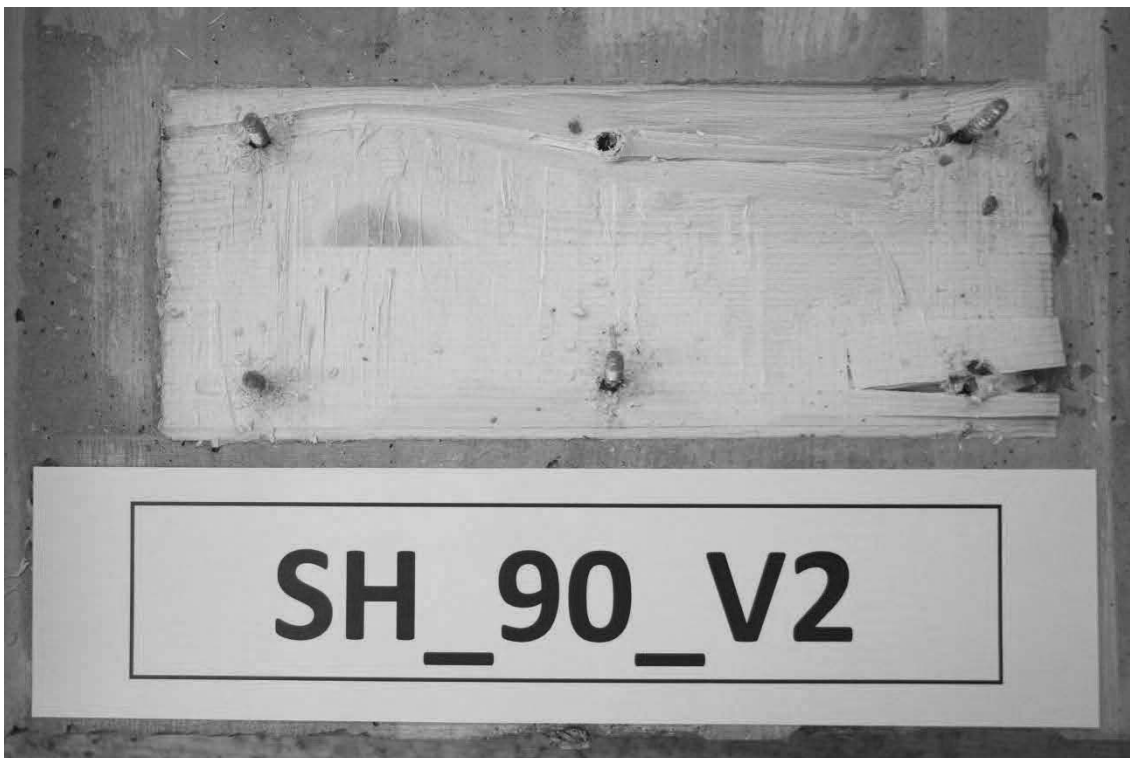
Abb. D.22: Hersteller B, Schubnocken zusätzlich verschraubt mit 6 Schrauben, Prüfkörper 2, Nocken Seite 1.
