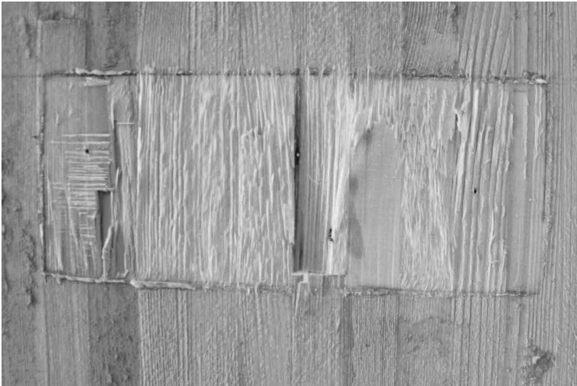
Abb. D.5: Hersteller A, Schubnocken ohne zusätzliche Verschraubung, Prüfkörper 3, MHP Seite 1.
