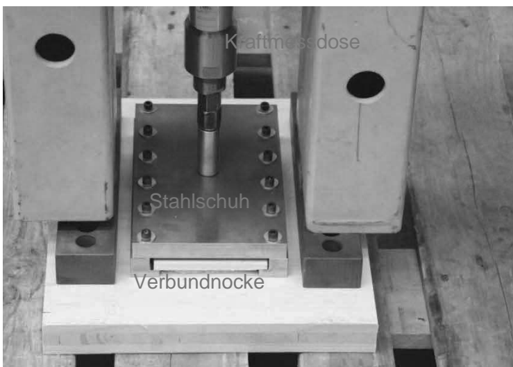
Abb. 2.4: Komponenten der Prüfeinrichtung für die Haftzugversuche.
