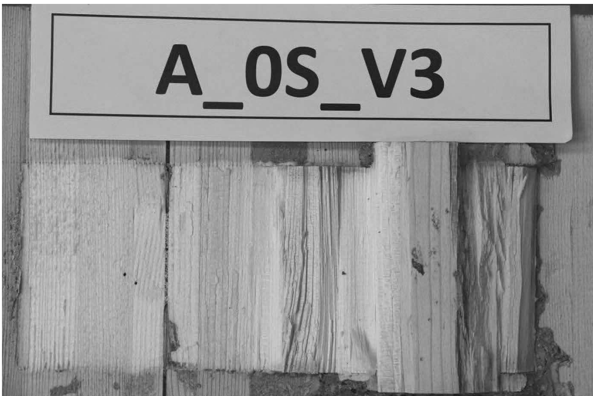
Abb. A.5: Hersteller A, Schubnocken ohne zusätzliche Verschraubung, Prüfkörper 3, obere Nocken.
