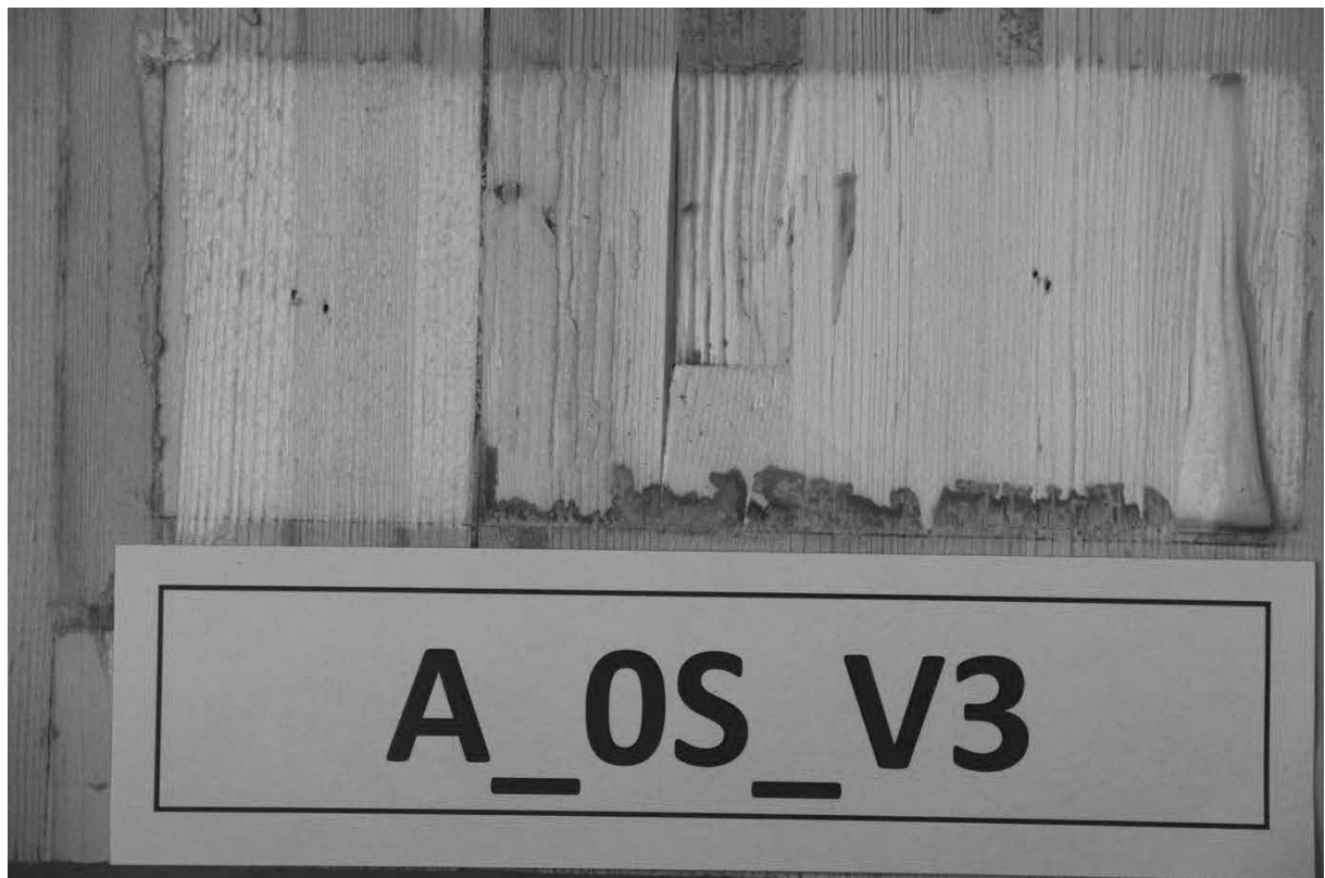
Abb. A.6: Hersteller A, Schubnocken ohne zusätzliche Verschraubung, Prüfkörper 3, untere Nocken.
