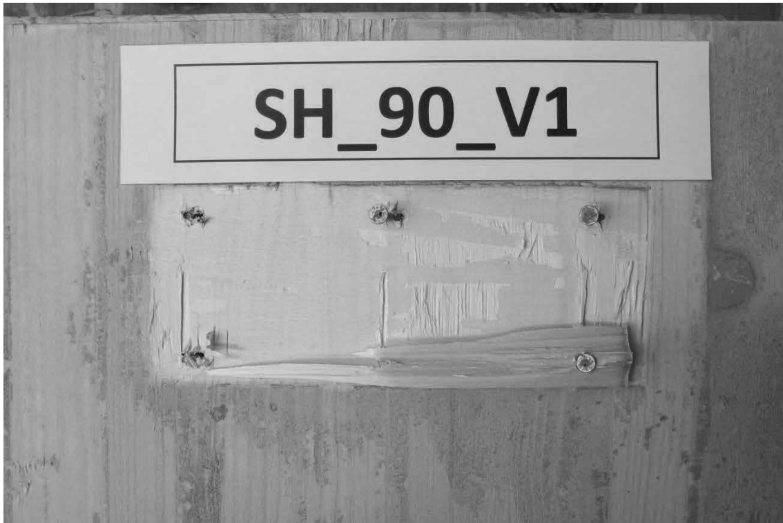
Abb. D.16: Hersteller B, Schubnocken zusätzlich verschraubt mit 6 Schrauben, Prüfkörper 1, MHP Seite 1.
