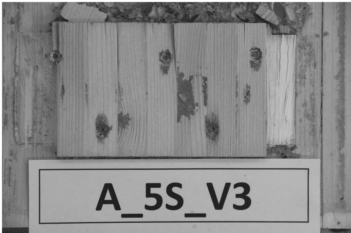
Abb. A.18: Hersteller A, Schubnocken zusätzlich verschraubt mit 5 Schrauben, Prüfkörper 3, untere Nocken.
