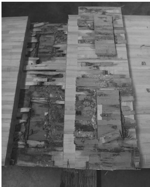
Abb. 4.33: Geöffneter Prüfkörper des Herstellers PS: Seite mit zusätzlich verschraubten Schubnocken.
