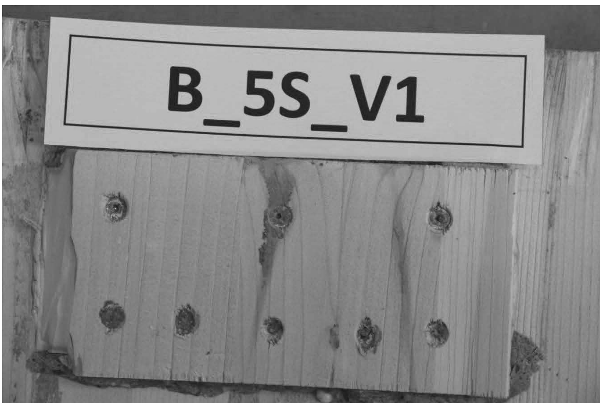
Abb. A.31: Hersteller B, Schubnocken zusätzlich verschraubt mit 5 Schrauben, Prüfkörper 1, obere Nocken.
