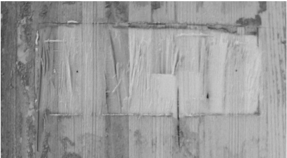
Abb. D.10: Hersteller A, Schubnocken ohne zusätzliche Verschraubung, Prüfkörper 4, MHP Seite 2.
