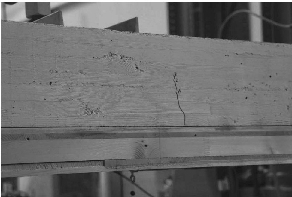
Abb. 4.56: Rissbildung während der 480-minütigen Belastung mit der 3-fachen Gebrauchslast im Bereich des später im Bruchversuchs aufgetretenen Bruch.
