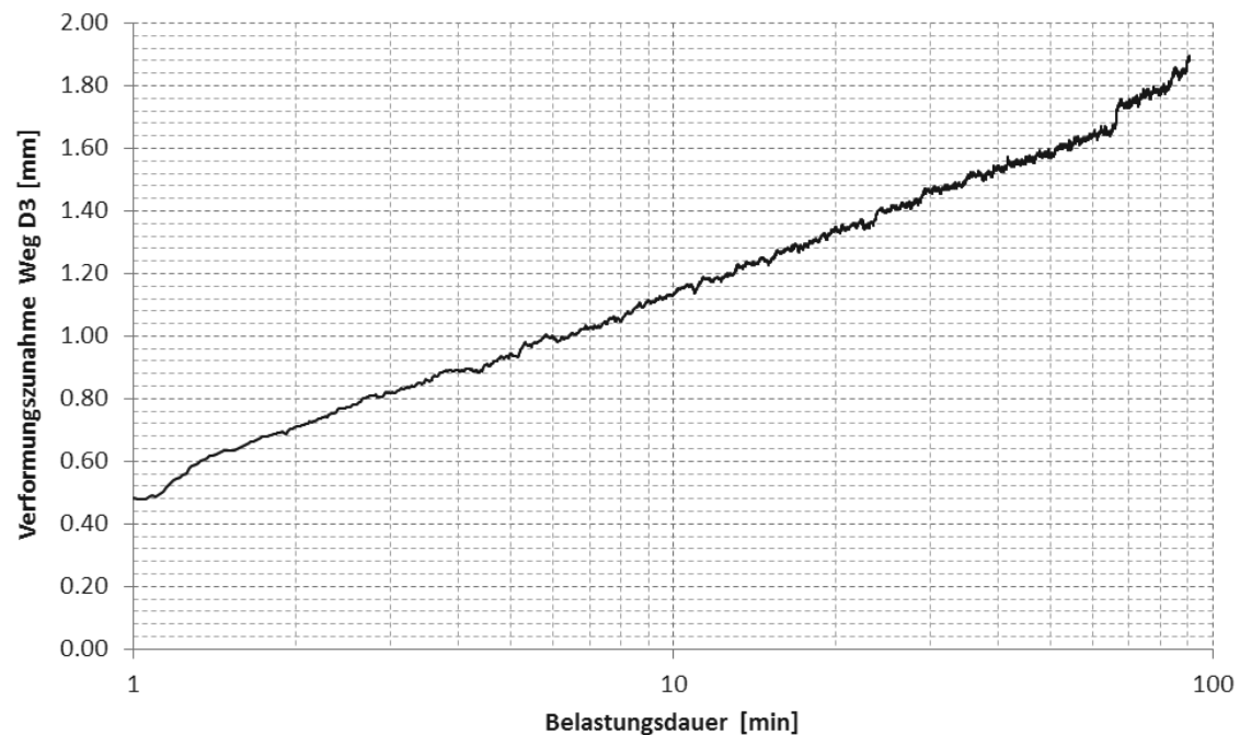
Abb. 4.29: Versuch am Prüfkörper des Herstellers PS: Zunahme der Durchbiegung im Punkt D3 während der 90 Minuten dauernden Belastung mit der 1 Gebrauchslast.
