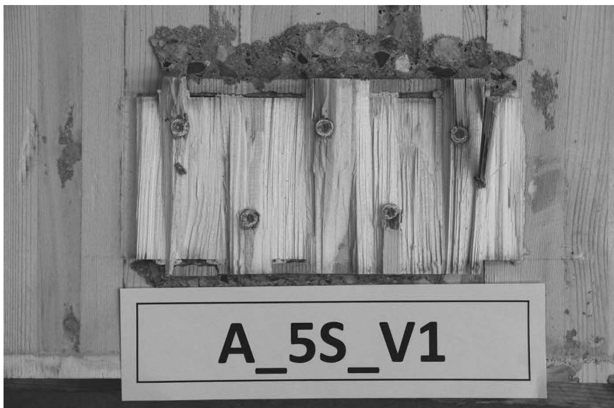
Abb. A.14: Hersteller A, Schubnocken zusätzlich verschraubt mit 5 Schrauben, Prüfkörper 1, untere Nocken.
