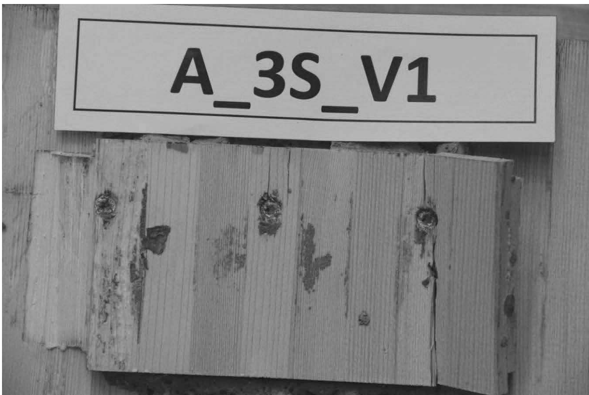
Abb. A.7: Hersteller A, Schubnocken zusätzlich verschraubt mit 3 Schrauben, Prüfkörper 1, obere Nocken.
