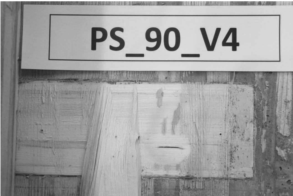
Abb. D.11: Hersteller A, Schubnocken ohne zusätzliche Verschraubung, Prüfkörper 4, Nocken Seite 1.
