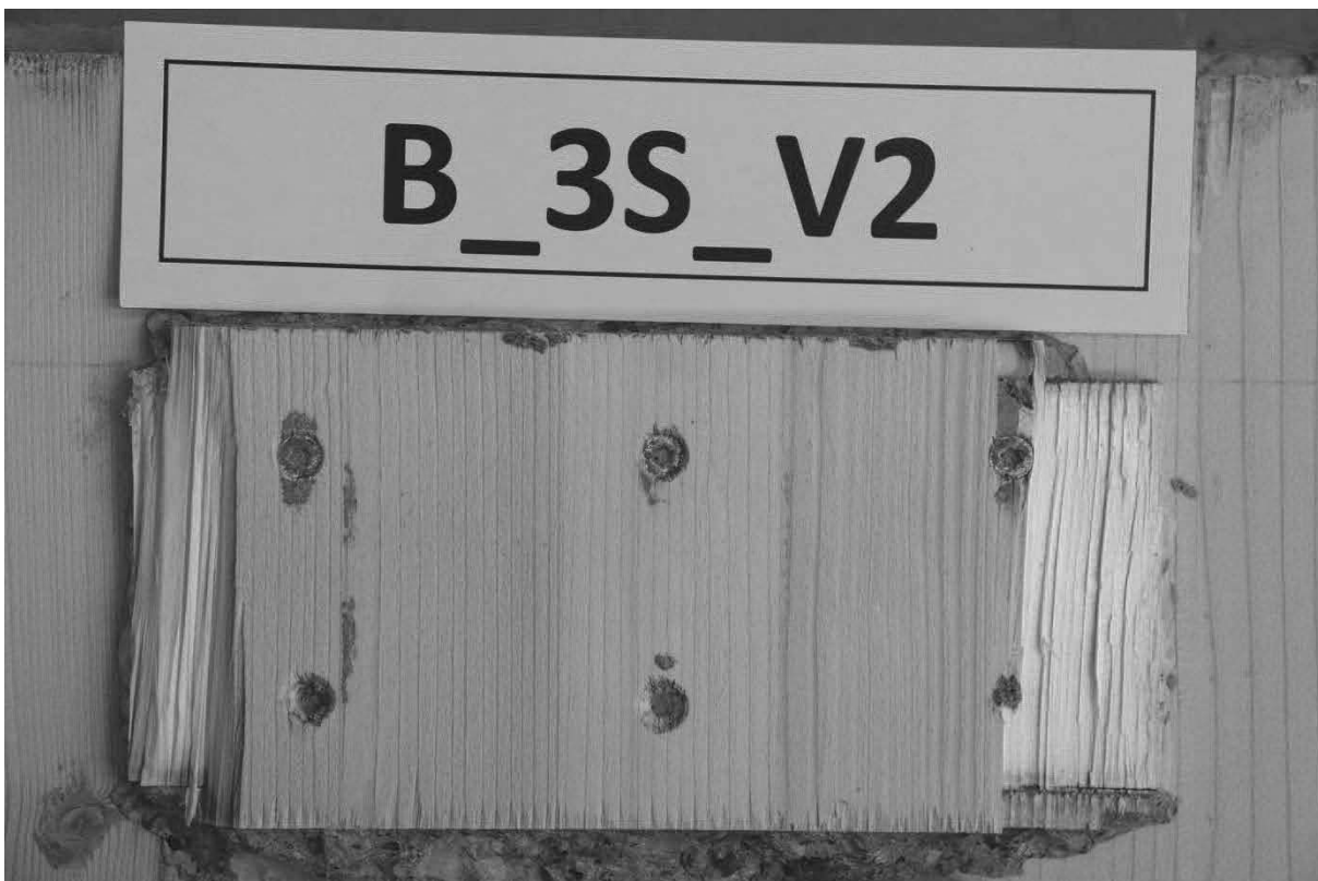
Abb. A.27: Hersteller B, Schubnocken zusätzlich verschraubt mit 3 Schrauben, Prüfkörper 2, obere Nocken.
