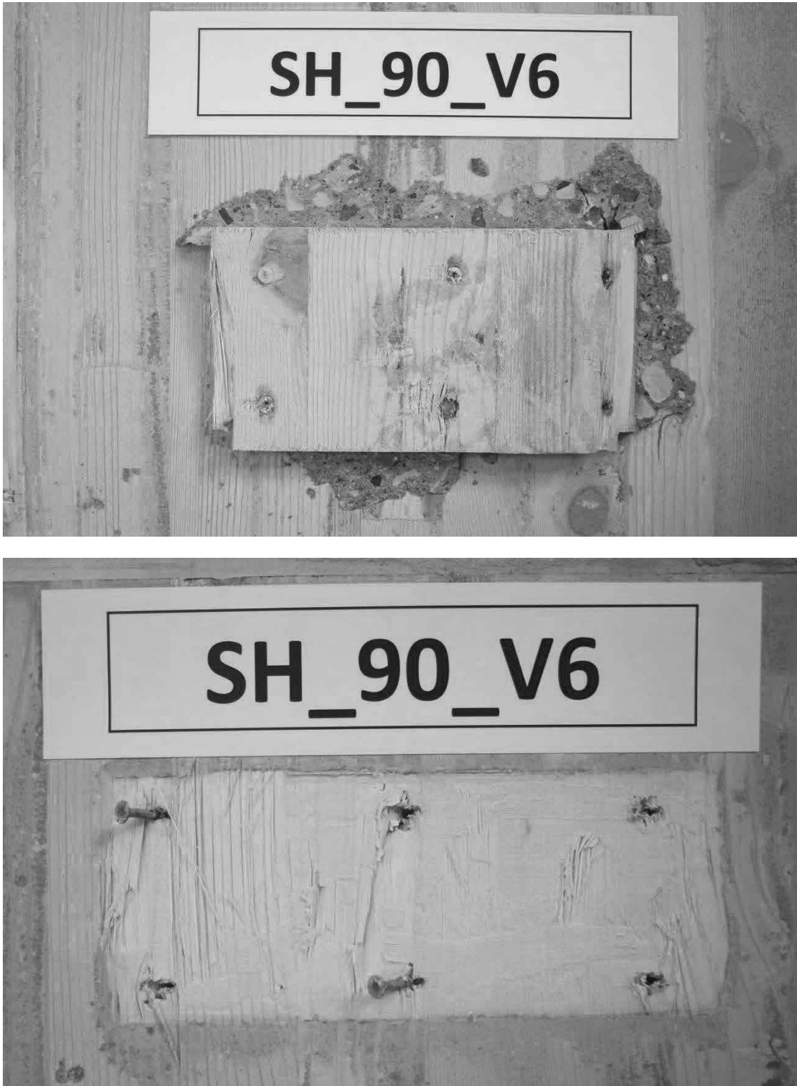
Abb. D.29: Hersteller B, Schubnocken zusätzlich verschraubt mit 6 Schrauben, Prüfkörper 6, MHP Seite 1.
