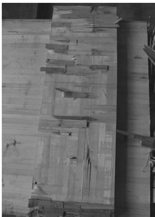
Abb. 4.34: Geöffneter Prüfkörper des Herstellers PS: Seite mit unverschraubten Schubnocken.
