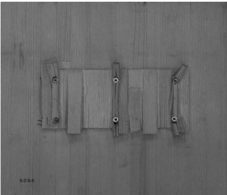
Abb. 2.10: Typischer Querkzugbruch einer geklebten und verschraubten Schubnocke - Prüfkörper S-Z-S-5 (Hersteller PS).
