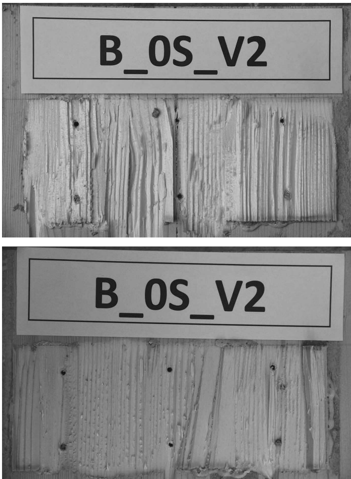
Abb. A.21: Hersteller B, Schubnocken ohne zusätzliche Verschraubung, Prüfkörper 2, obere Nocken.
