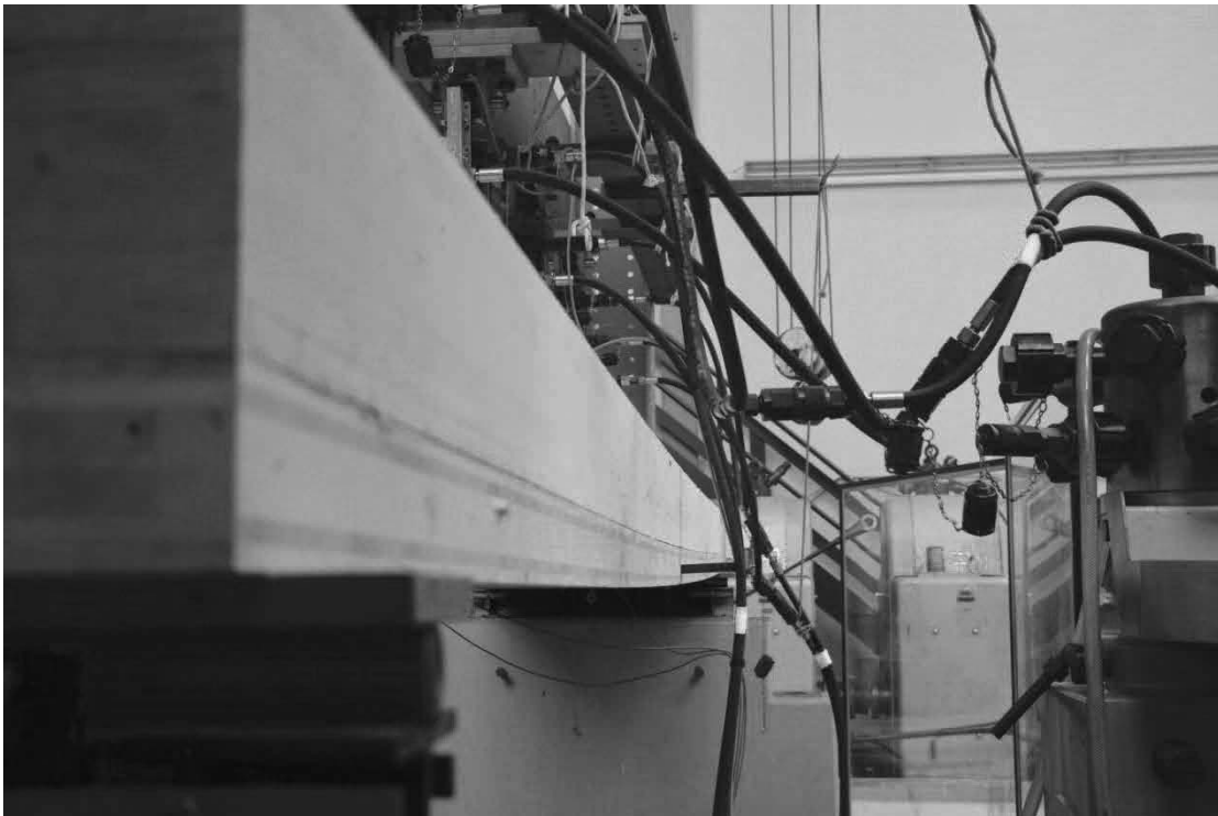
Abb. 4.48: Versuch am Prüfkörper des Herstellers SH: Durchbiegung nach der 8 Stunden dauernden Belastung mit der 3-fachen Gebrauchslast.
