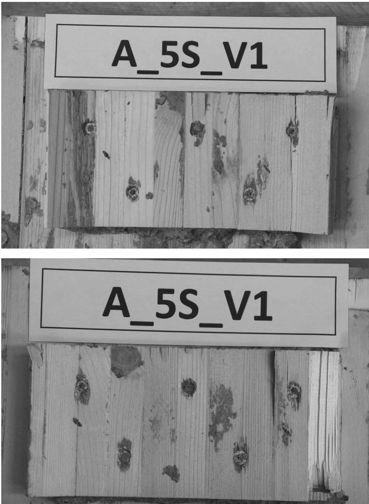
Abb. A.13: Hersteller A, Schubnocken zusätzlich verschraubt mit 5 Schrauben, Prüfkörper 1, obere Nocken.
