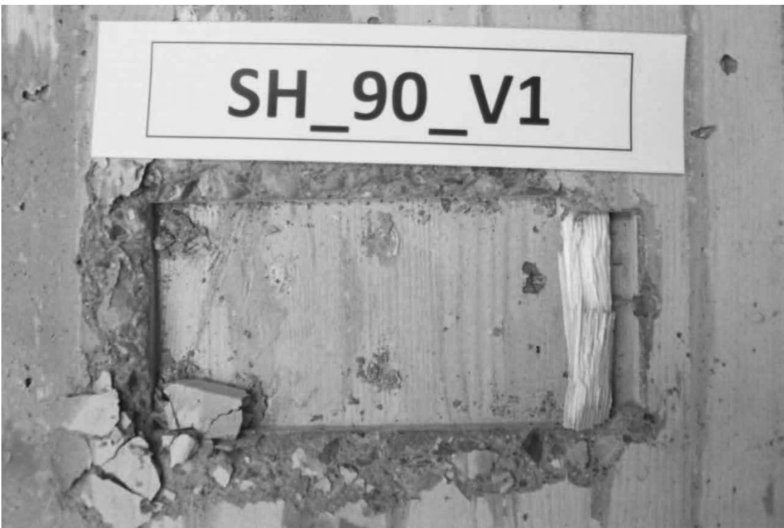
Abb. D.19: Hersteller B, Schubnocken zusätzlich verschraubt mit 6 Schrauben, Prüfkörper 1, Nocken Seite 2.
