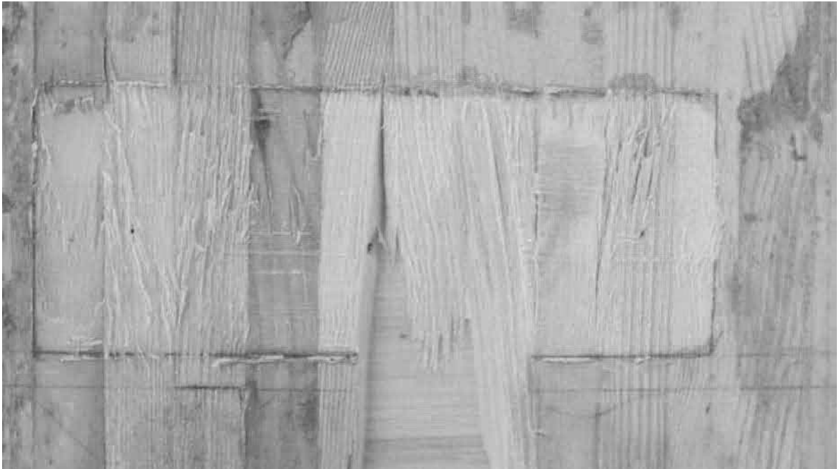
Abb. D.9: Hersteller A, Schubnocken ohne zusätzliche Verschraubung, Prüfkörper 4, MHP Seite 1.
