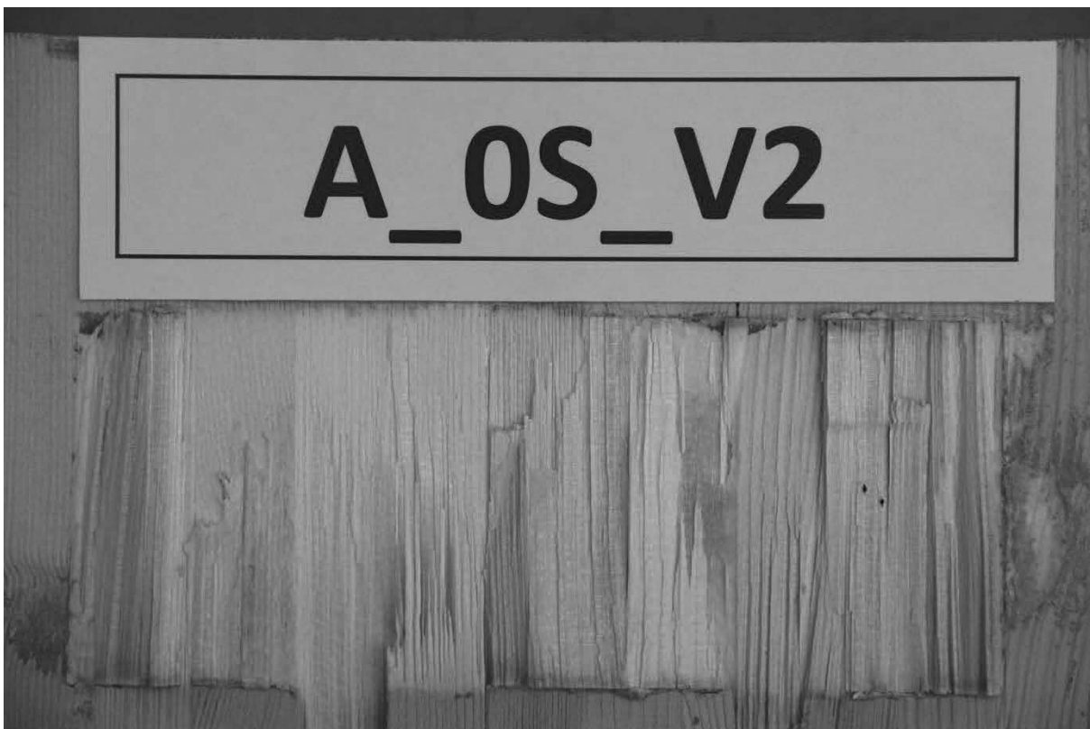
Abb. A.3: Hersteller A, Schubnocken ohne zusätzliche Verschraubung, Prüfkörper 2, obere Nocken.
