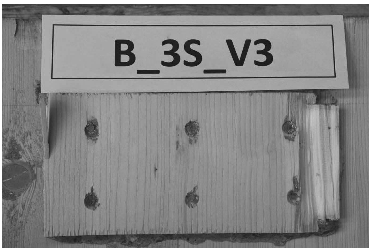
Abb. A.29: Hersteller B, Schubnocken zusätzlich verschraubt mit 3 Schrauben, Prüfkörper 3, obere Nocken.
