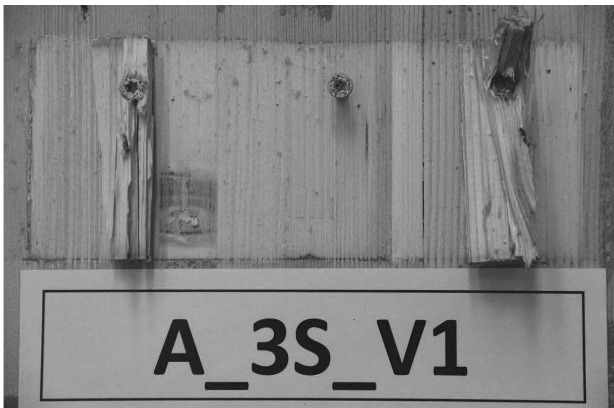
Abb. A.8: Hersteller A, Schubnocken zusätzlich verschraubt mit 3 Schrauben, Prüfkörper 1, untere Nocken.
