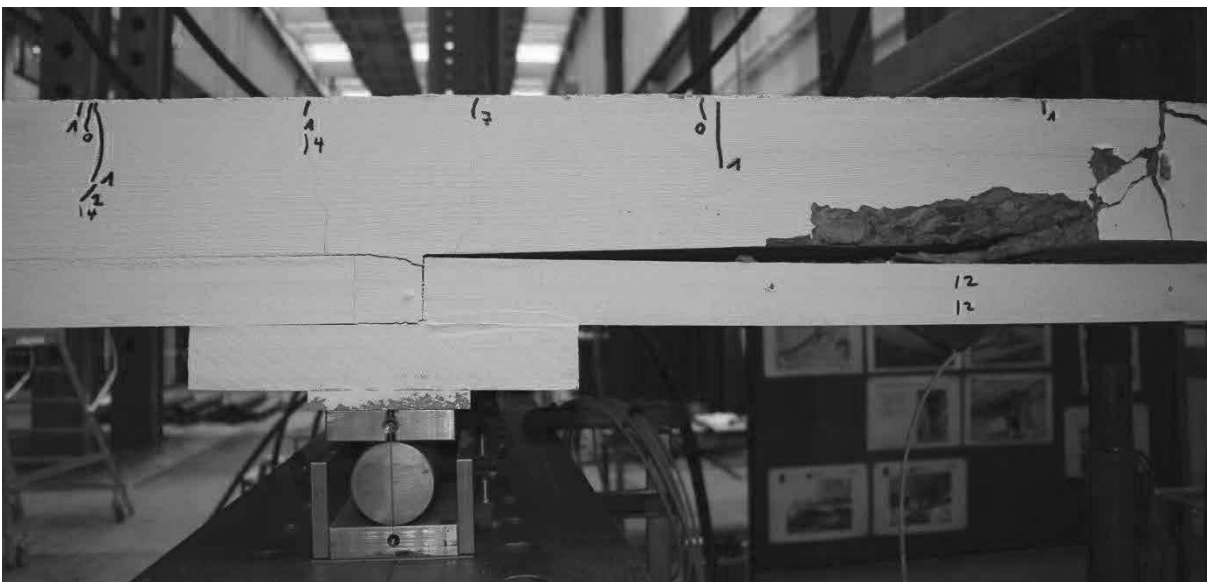
Abb. 5.33: Detailaufnahme (Längsseite) des Bruchs des Prüfkörpers mit mittigem Stoss.
