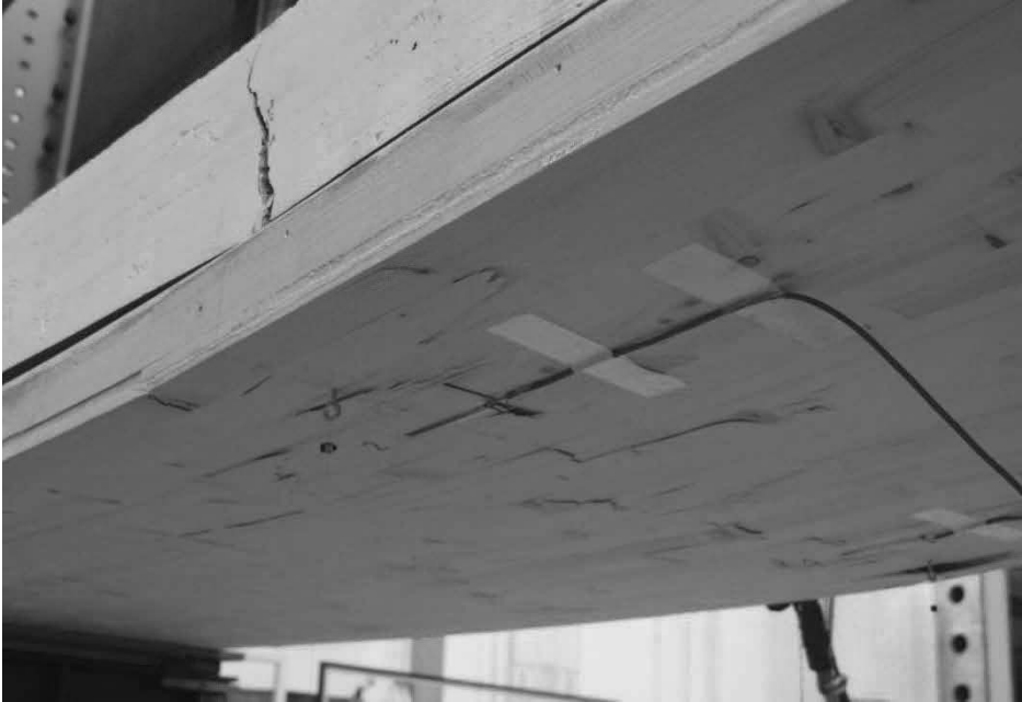
Abb. 4.49: Zugbruch der äussersten Lage der MHP in einer Zone, welche bereits vor dem Versuch Aufsplitterungen aufwies (siehe Abb. 4.18).
