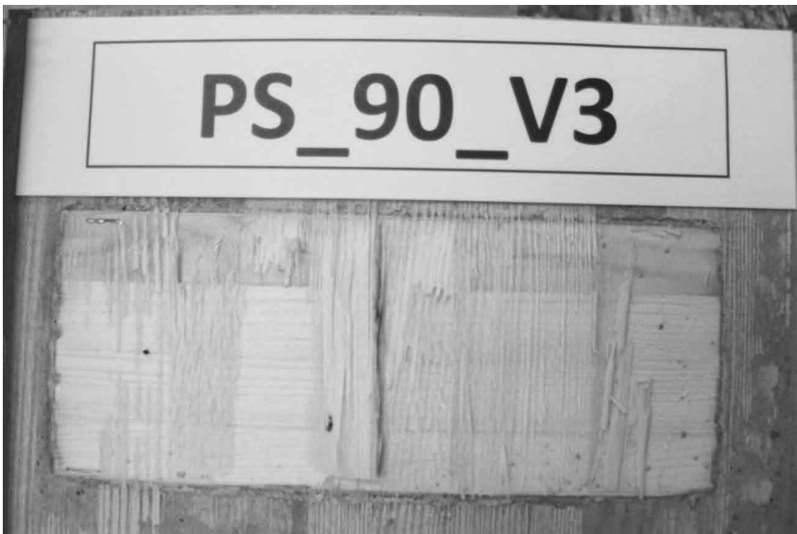
Abb. D.7: Hersteller A, Schubnocken ohne zusätzliche Verschraubung, Prüfkörper 3, Nocken Seite 1.
