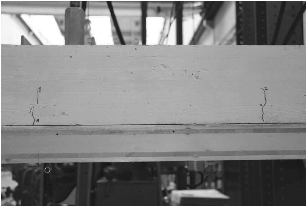
Abb. 4.57: Rissbildung während der 480-minütigen Belastung mit der 3-fachen Gebrauchslast in Spannweitenmitte. Die Abb. 4.56 zeigt dieselbe Prüfkörperseite wie die Abb. 4.57.
