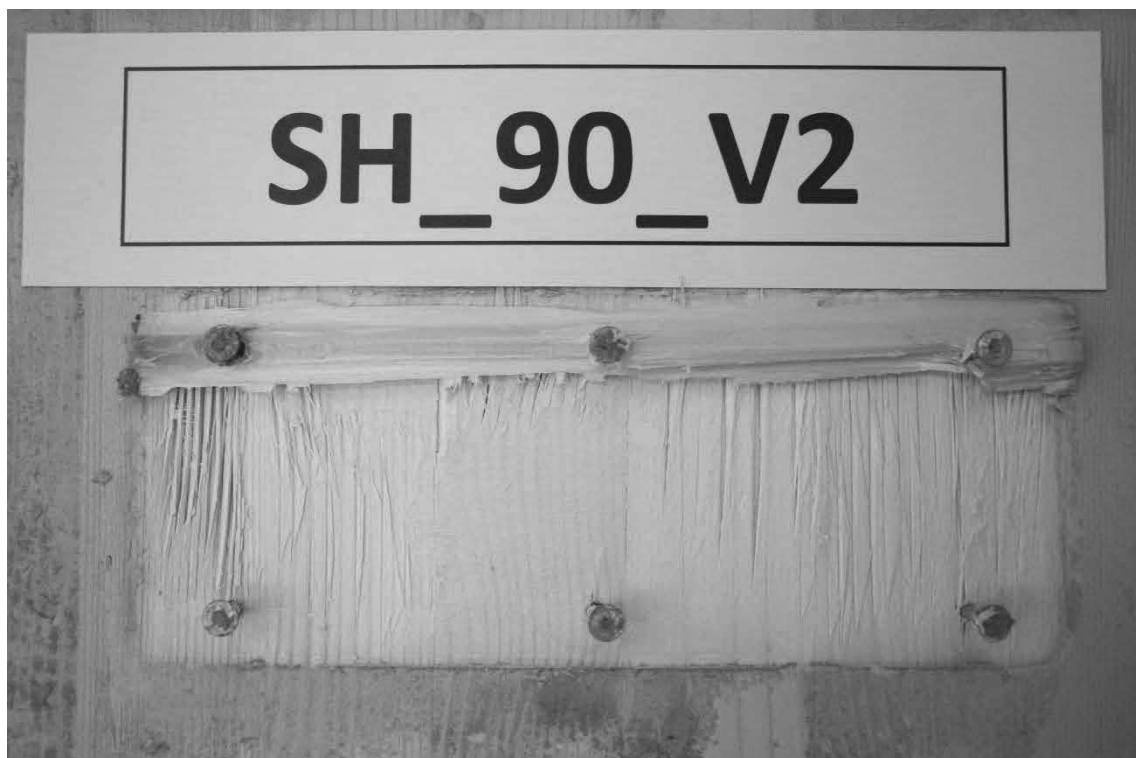
Abb. D.21: Hersteller B, Schubnocken zusätzlich verschraubt mit 6 Schrauben, Prüfkörper 2, MHP Seite 2.
