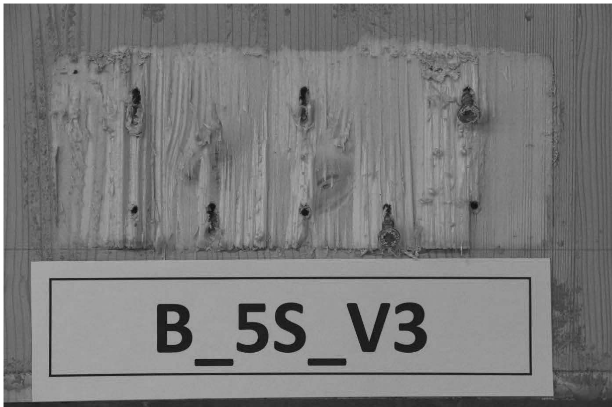
Abb. A.36: Hersteller B, Schubnocken zusätzlich verschraubt mit 5 Schrauben, Prüfkörper 3, untere Nocken.
