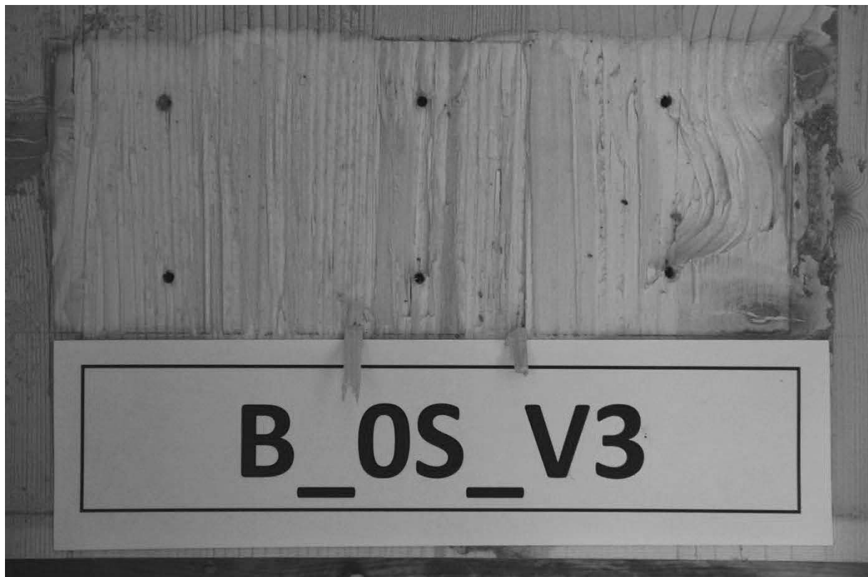
Abb. A.24: Hersteller B, Schubnocken ohne zusätzliche Verschraubung, Prüfkörper 3, untere Nocken.
