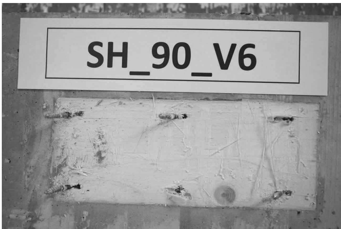
Abb. D.31: Hersteller B, Schubnocken zusätzlich verschraubt mit 6 Schrauben, Prüfkörper 6, Nocken Seite 1.
