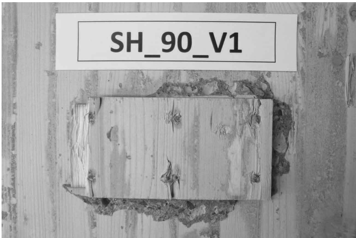
Abb. D.17: Hersteller B, Schubnocken zusätzlich verschraubt mit 6 Schrauben, Prüfkörper 1, MHP Seite 2.
