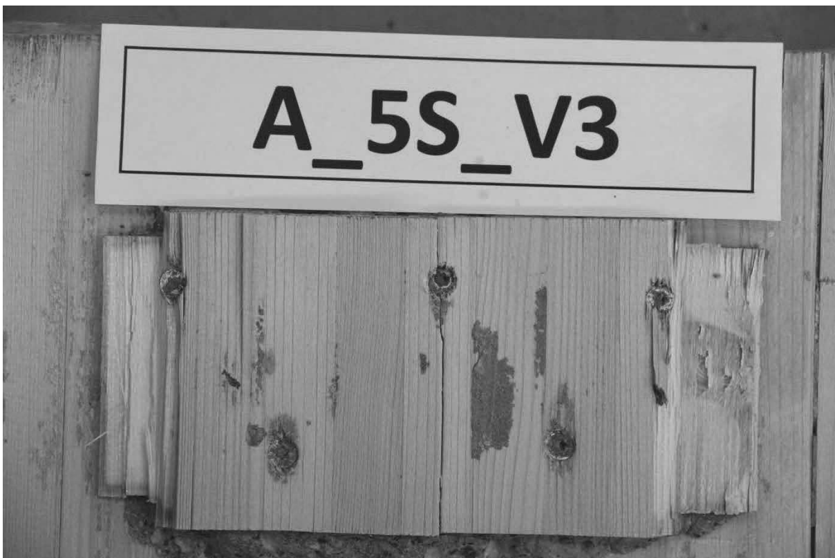
Abb. A.17: Hersteller A, Schubnocken zusätzlich verschraubt mit 5 Schrauben, Prüfkörper 3, obere Nocken.
