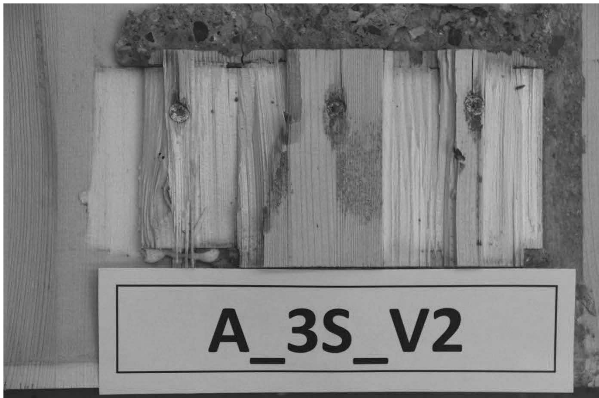
Abb. A.10: Hersteller A, Schubnocken zusätzlich verschraubt mit 3 Schrauben, Prüfkörper 2, untere Nocken.
