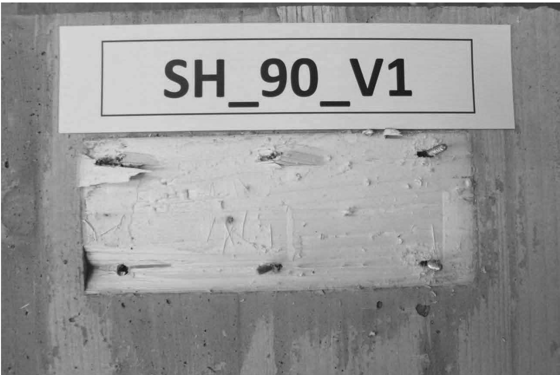
Abb. D.18: Hersteller B, Schubnocken zusätzlich verschraubt mit 6 Schrauben, Prüfkörper 1, Nocken Seite 1.
