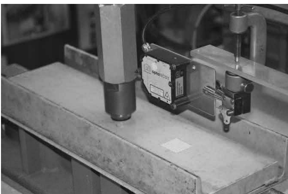
Abb. 5.14: Messung der Durchbiegung an der Stelle D5 bzw. D6 mit einem Lasersensor des Typs optoNCDT 2200 (Log. Nr. 30.332 bzw. 30.333).
