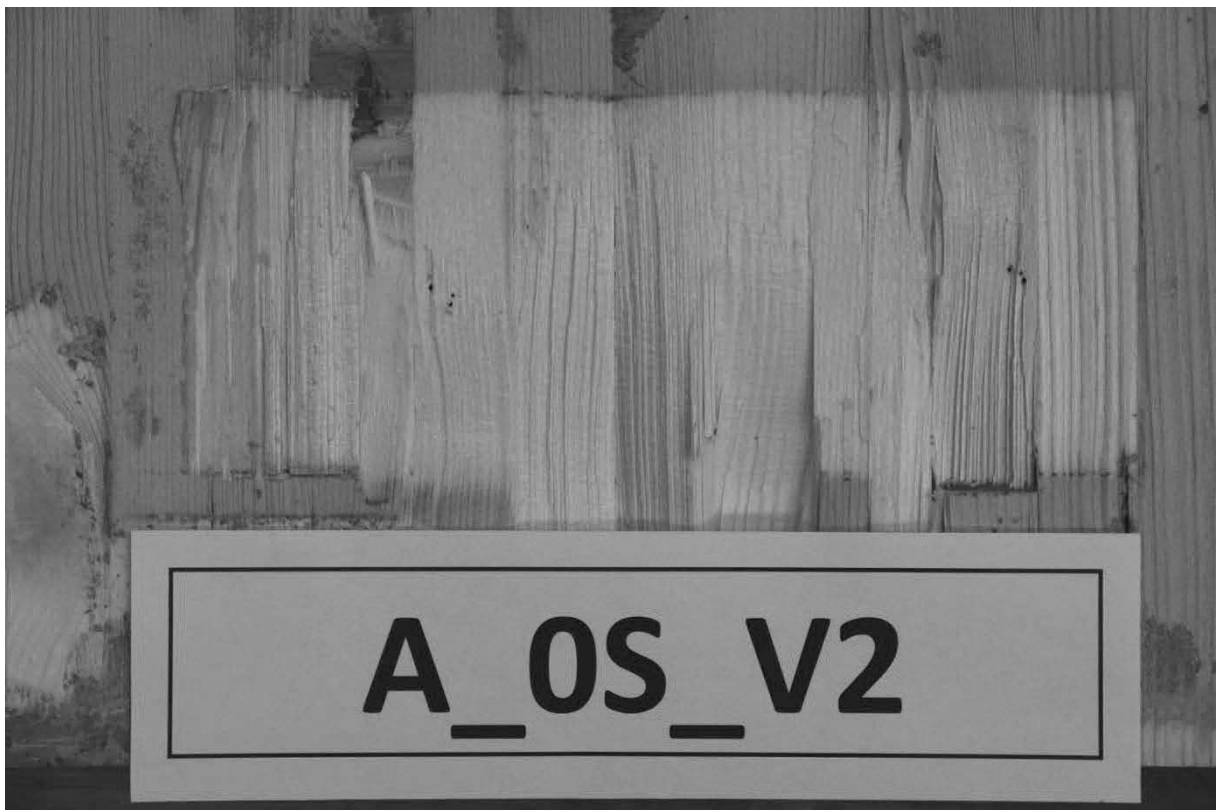
Abb. 0.4: Hersteller A, Schubnocken ohne zusätzliche Verschraubung, Prüfkörper 2, untere Nocken.
