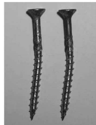
Abb. 5.4: Verwendete Schrauben mit Durchmesser 5 mm und Länge 50 mm.
