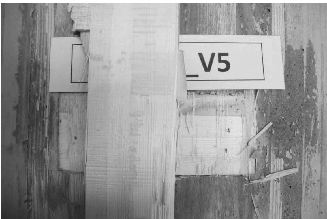
Abb. D.14: Hersteller A, Schubnocken ohne zusätzliche Verschraubung, Prüfkörper 5, Detailaufnahme.
