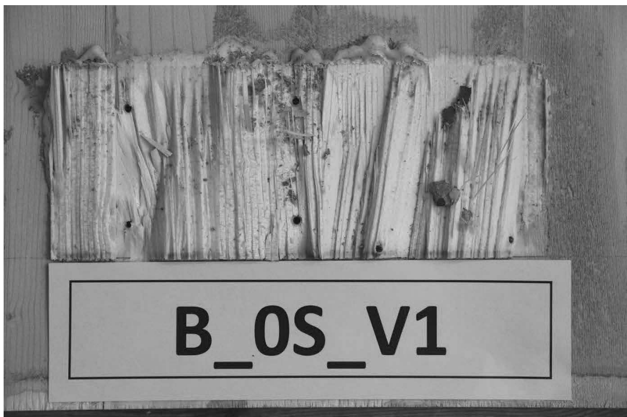
Abb. A.20: Hersteller B, Schubnocken ohne zusätzliche Verschraubung, Prüfkörper 1, untere Nocken.
