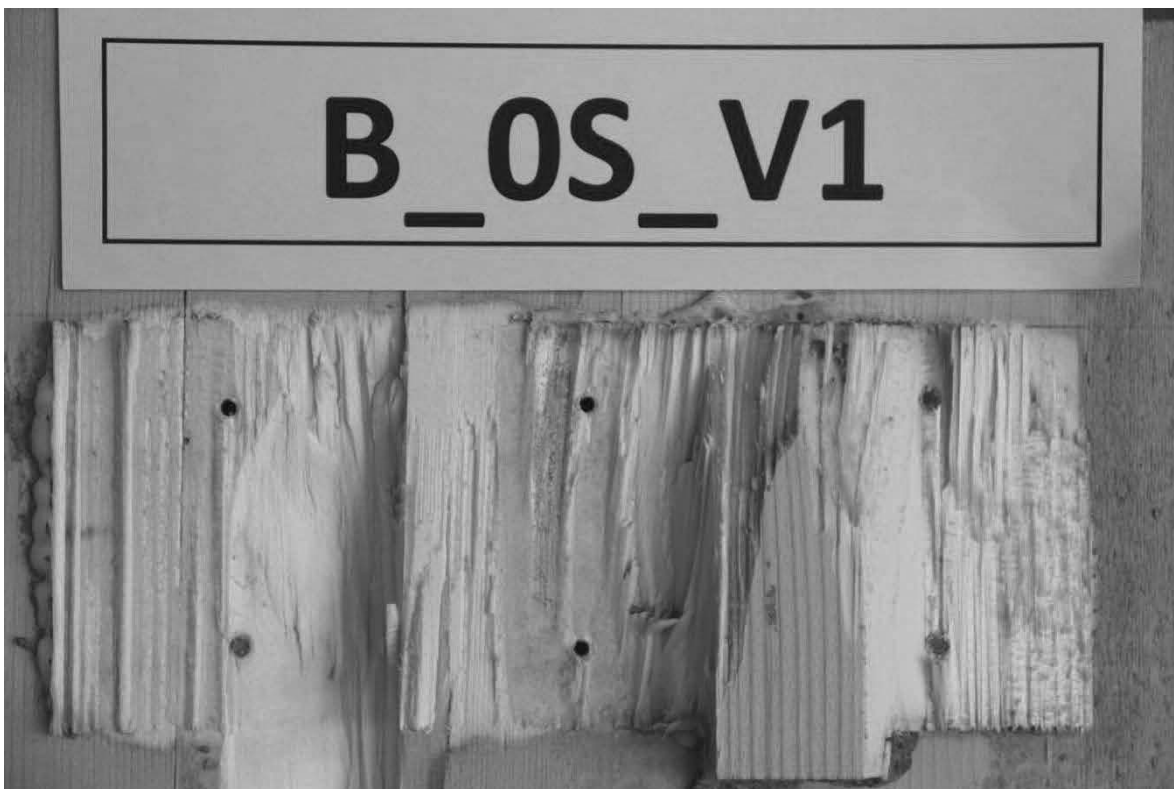
Abb. A.19: Hersteller B, Schubnocken ohne zusätzliche Verschraubung, Prüfkörper 1, obere Nocken.
