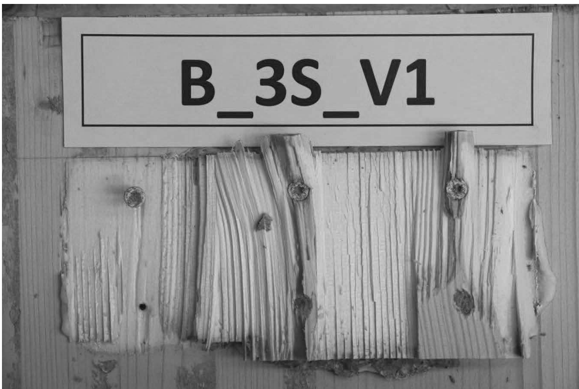
Abb. A.25: Hersteller B, Schubnocken zusätzlich verschraubt mit 3 Schrauben, Prüfkörper 1, obere Nocken.
