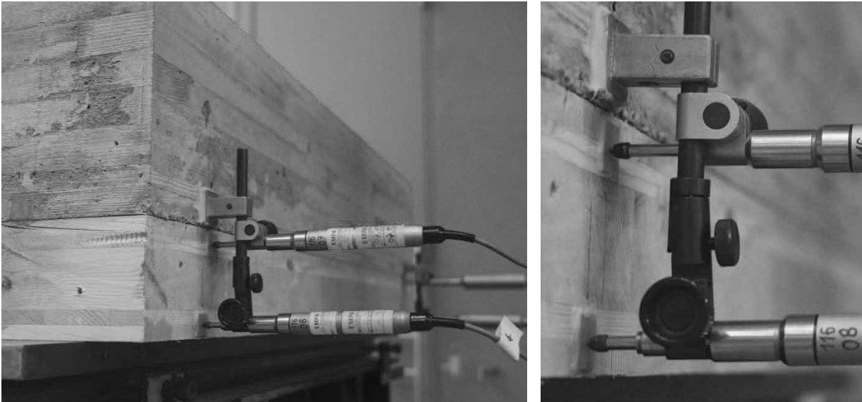
Abb. 4.16: Messung der differentiellen Verschiebung zwischen Beton und MHP mit Wegaufnehmern des Typs Sylvac P25 bzw. P50 (Log. Nr. 30.420 bzw. 30.440).
