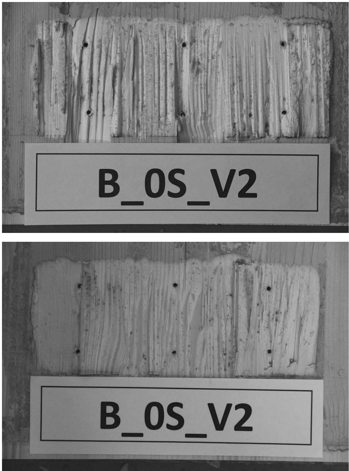
Abb. A.22: Hersteller B, Schubnocken ohne zusätzliche Verschraubung, Prüfkörper 2, untere Nocken.
