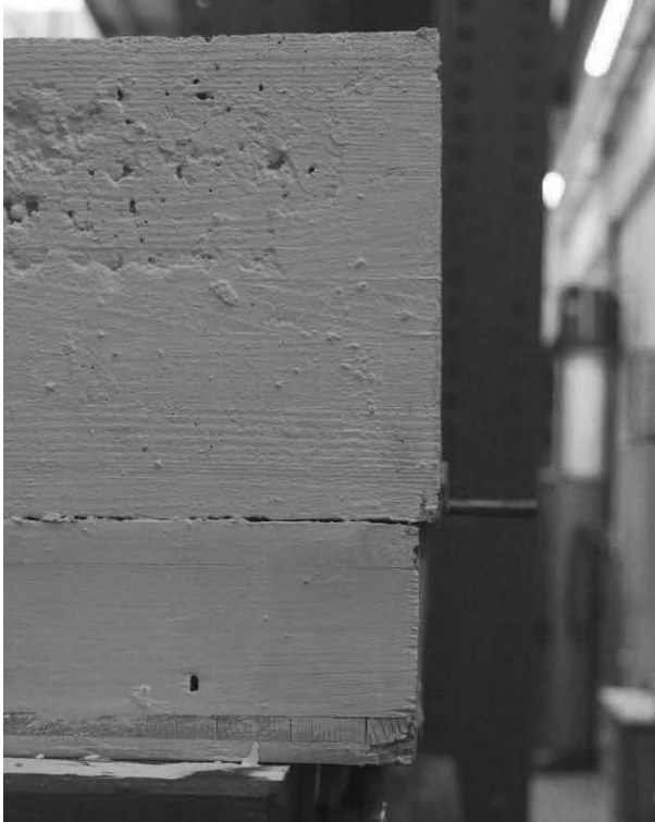
Abb. 4.32: Differentielle Verschiebung zwischen Beton und MHP am Auflager auf derjenigen Seite des Prüfkörpers des Herstellers PS, welche näher beim Bruch lag.
