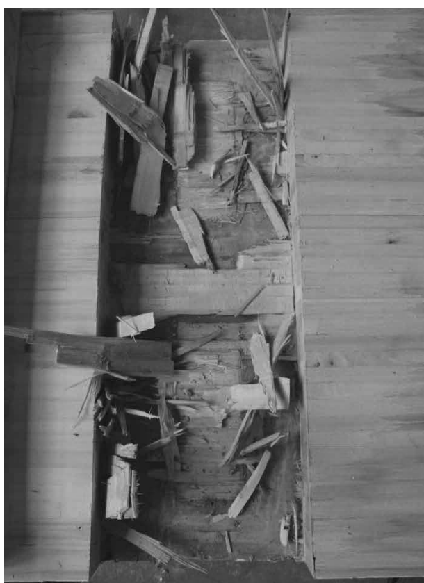
Abb. 4.34: Geöffneter Prüfkörper des Herstellers PS: Seite mit unverschraubten Schubnocken.
