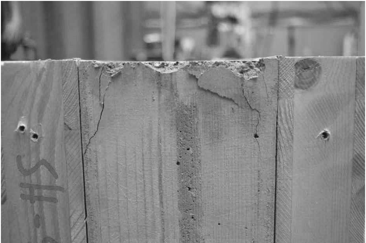
Abb. D.24: Hersteller B, Schubnocken zusätzlich verschraubt mit 6 Schrauben, Prüfkörper 4, Überschreiten der Betondruckfestigkeit.
