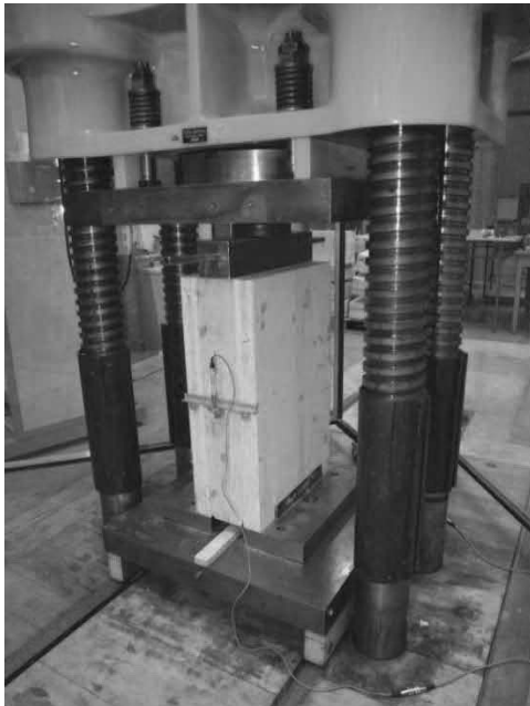
Abb. 3.1: Prüfkörper in der 5 MN-W&B-Druck-Prüfmaschine der Empa (links) und Belastungsschema (rechts).
