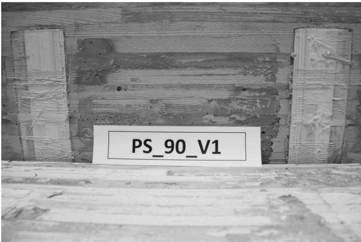
Abb. D.3: Hersteller A, Schubnocken ohne zusätzliche Verschraubung, Prüfkörper 1, Nocken Seite 1.
