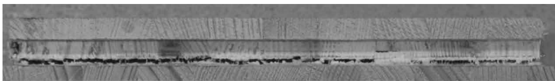
Abb. 2.17: Typischer Schubbruch einer mit der MHP verklebten Schubnocke - Prüfkörper S-7 / obere Kante (Hersteller PS).
