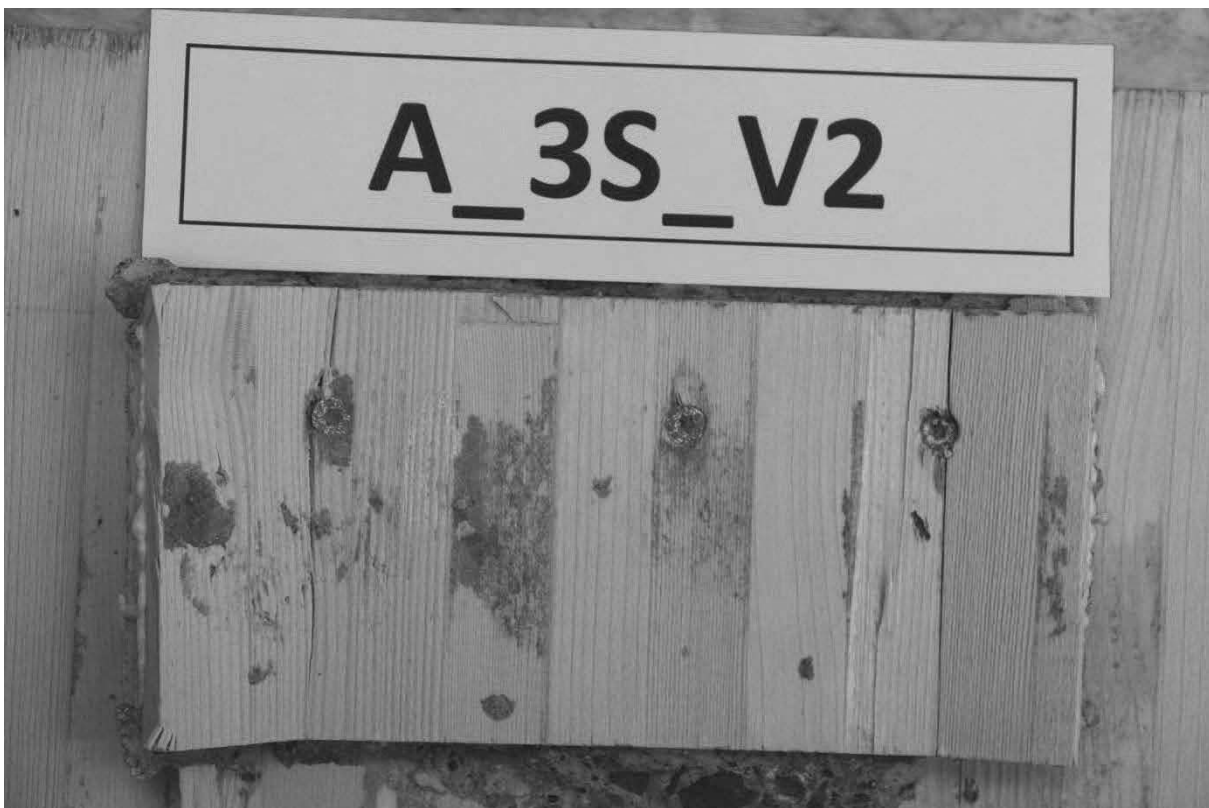
Abb. A.9: Hersteller A, Schubnocken zusätzlich verschraubt mit 3 Schrauben, Prüfkörper 2, obere Nocken.
