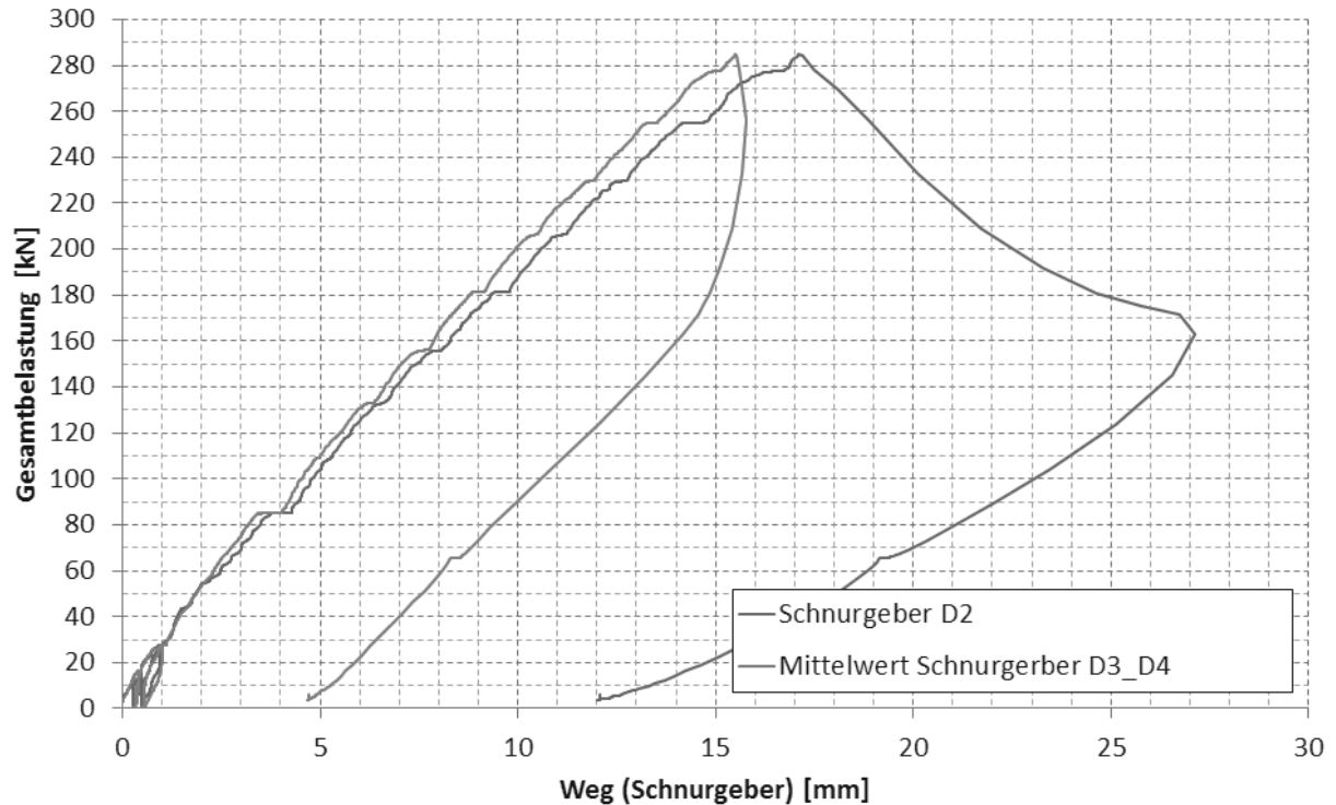
Abb. 5.22: Versuch am 2-feldrigen Prüfkörper mit mittigem Stoss: Vertikale Durchbiegung an den Messstellen D2* sowie D3 und D4 (Mittelwert).
