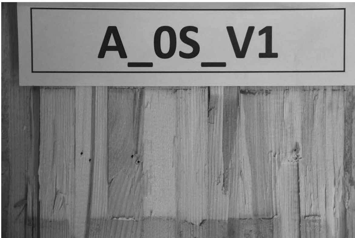
Abb. A.1: Hersteller A, Schubnocken ohne zusätzliche Verschraubung, Prüfkörper 1, obere Nocken.
