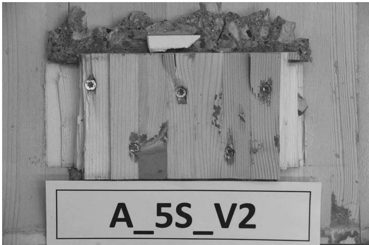
Abb. A. 16: Hersteller A, Schubnocken zusätzlich verschraubt mit 5 Schrauben, Prüfkörper 2, untere Nocken.
