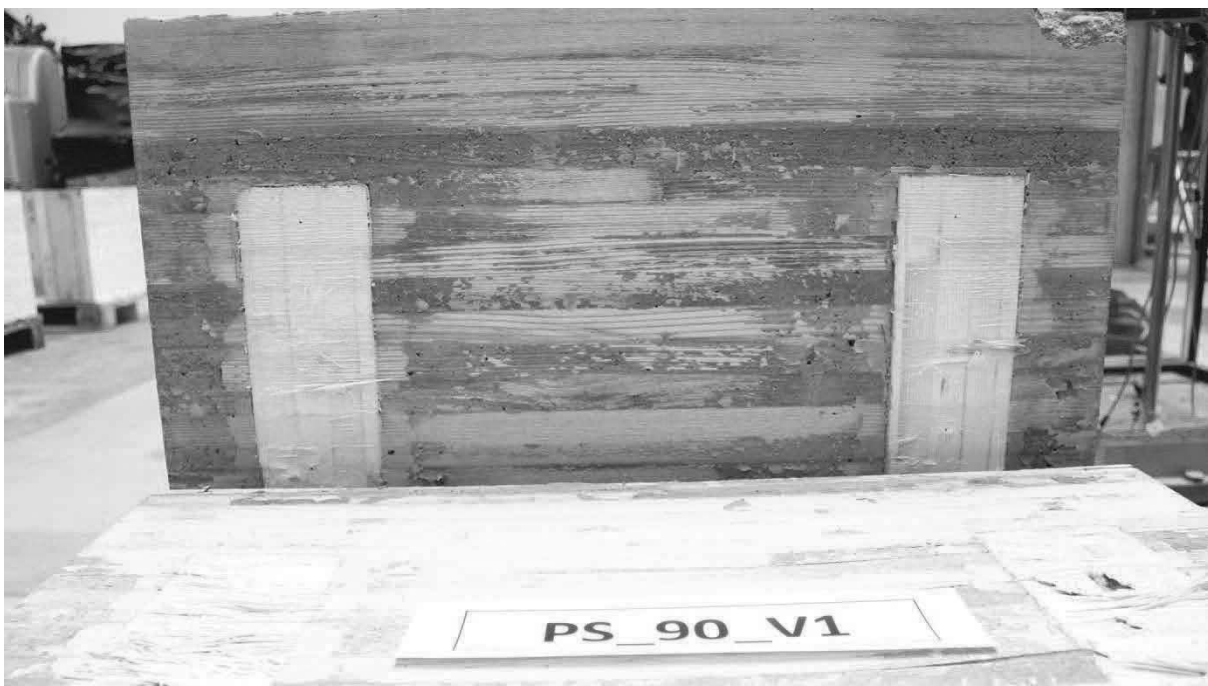
Abb. D.4: Hersteller A, Schubnocken ohne zusätzliche Verschraubung, Prüfkörper 1, Nocken Seite 2.
