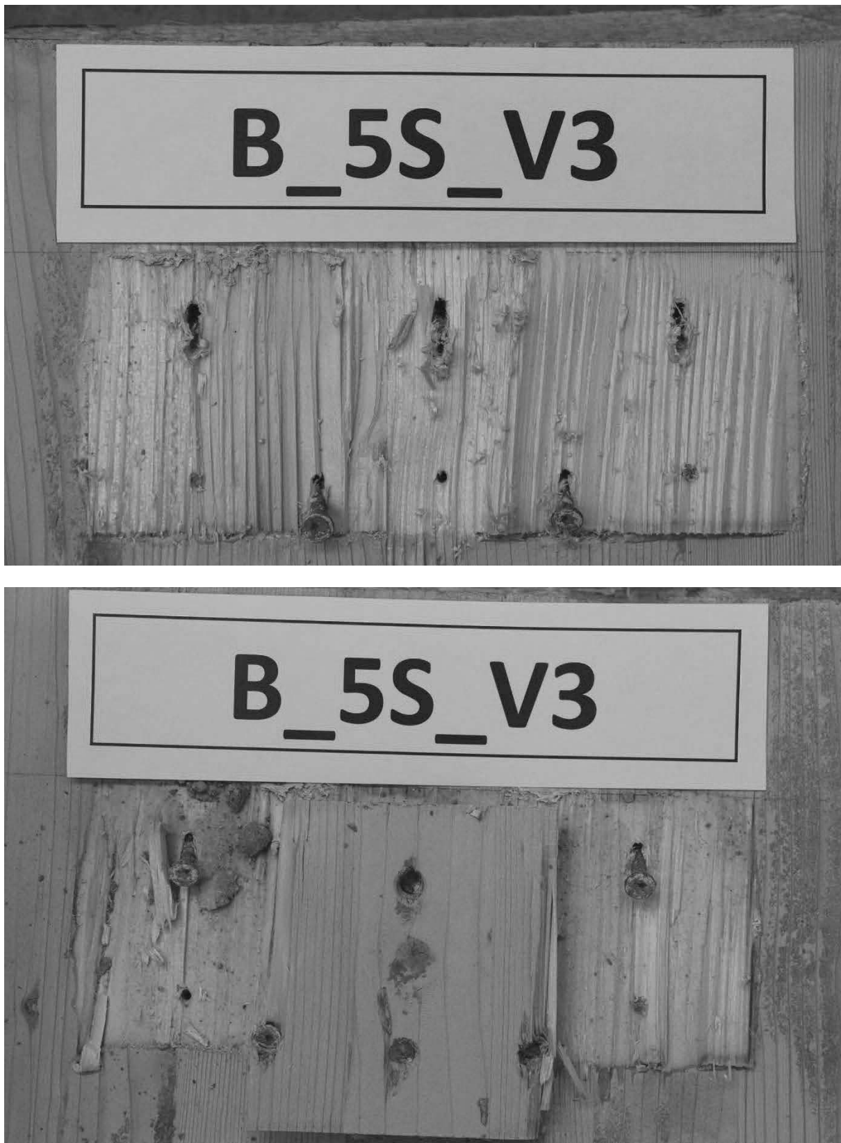
Abb. A.35: Hersteller B, Schubnocken zusätzlich verschraubt mit 5 Schrauben, Prüfkörper 3, obere Nocken.
