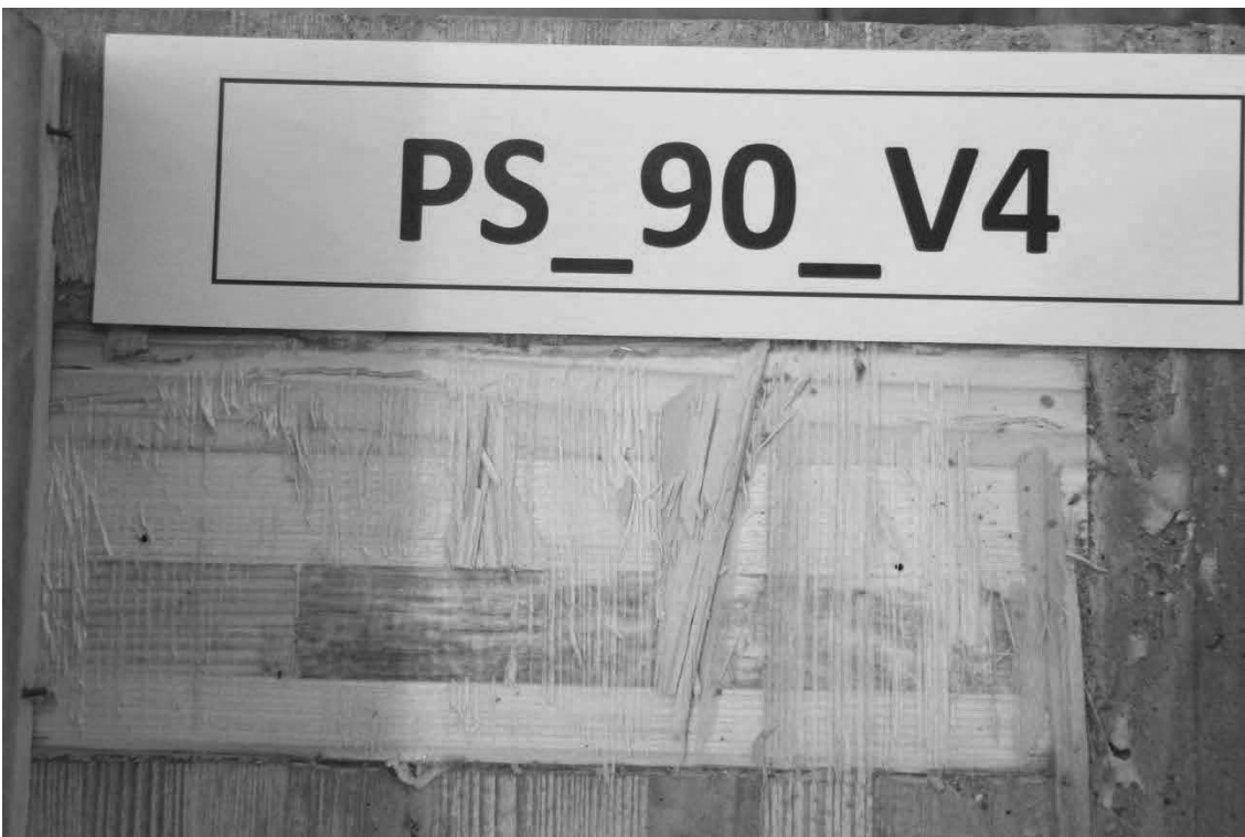
Abb. D.12: Hersteller A, Schubnocken ohne zusätzliche Verschraubung, Prüfkörper 4, Nocken Seite 2.
