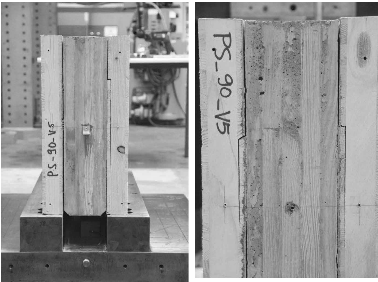
Abb. D.15: Hersteller A, Schubnocken ohne zusätzliche Verschraubung, Prüfkörper 5, Detailaufnahmen.
