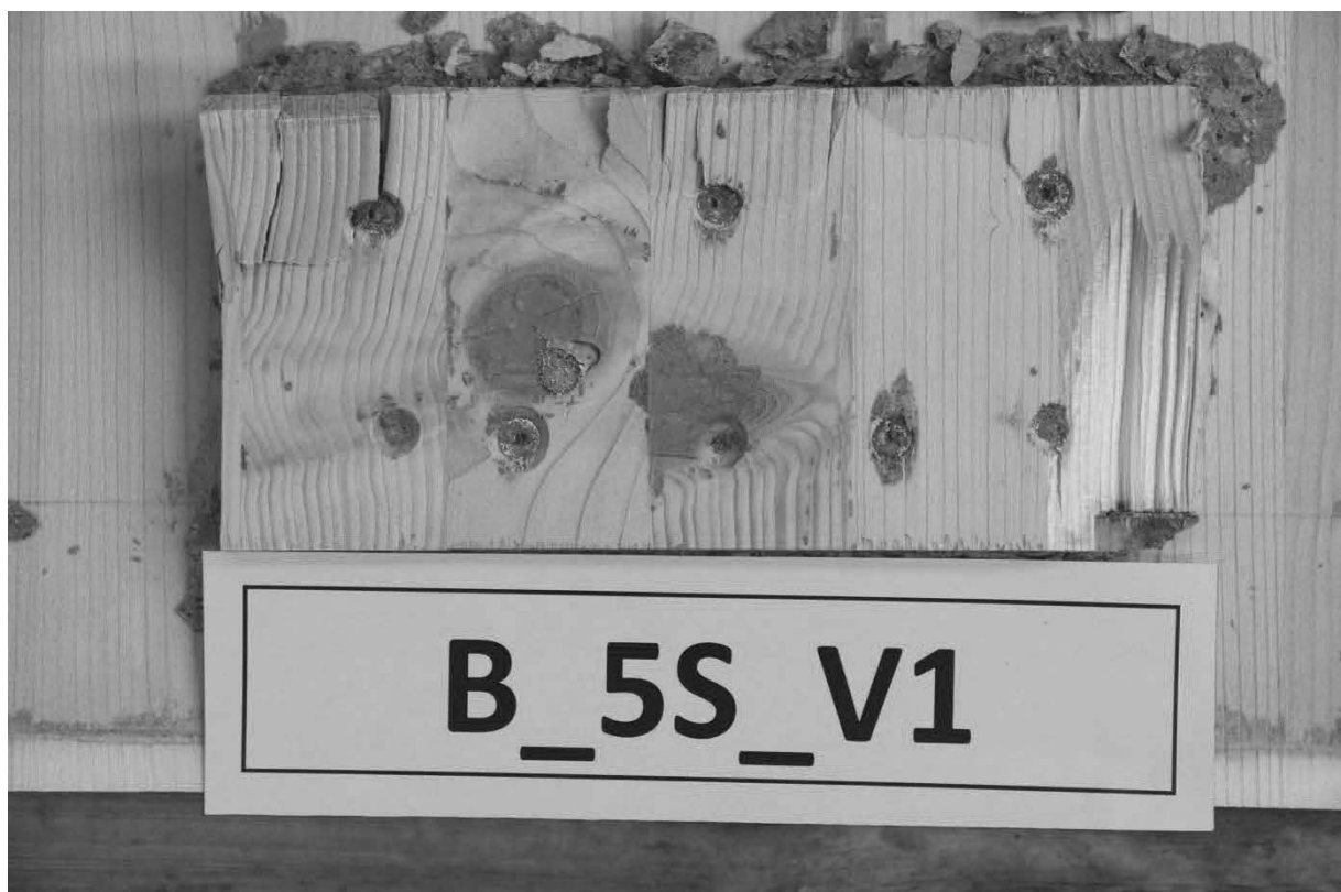
Abb. A.32: Hersteller B, Schubnocken zusätzlich verschraubt mit 5 Schrauben, Prüfkörper 1, untere Nocken.
