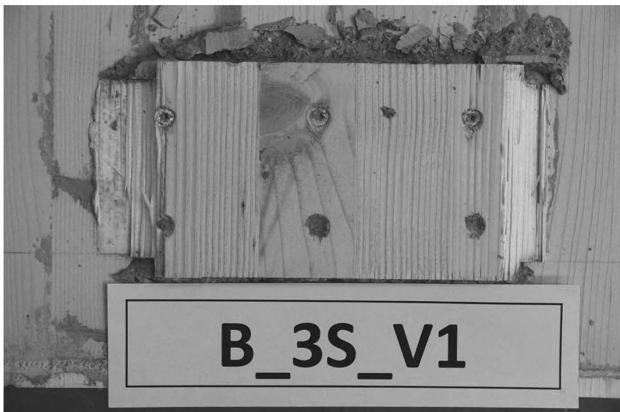
Abb. A.26: Hersteller B, Schubnocken zusätzlich verschraubt mit 3 Schrauben, Prüfkörper 1, untere Nocken.
