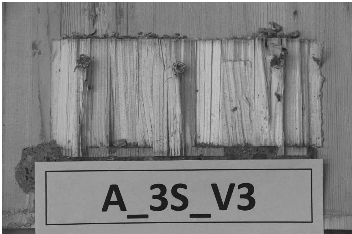
Abb. A. 12: Hersteller A, Schubnocken zusätzlich verschraubt mit 3 Schrauben, Prüfkörper 3, untere Nocken.
