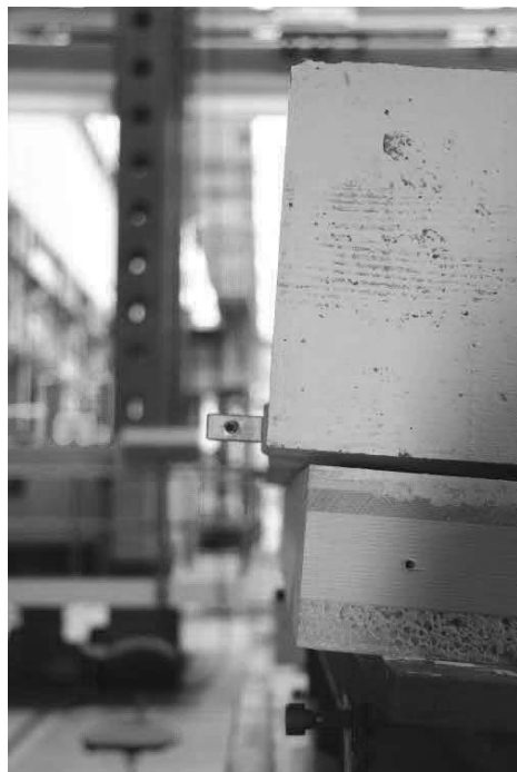
Abb. 4.53: Endversatz auf der Bruchseite.
