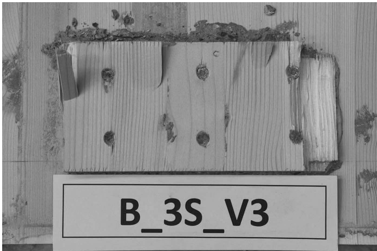
Abb. A.30: Hersteller B, Schubnocken zusätzlich verschraubt mit 3 Schrauben, Prüfkörper 3, untere Nocken.
