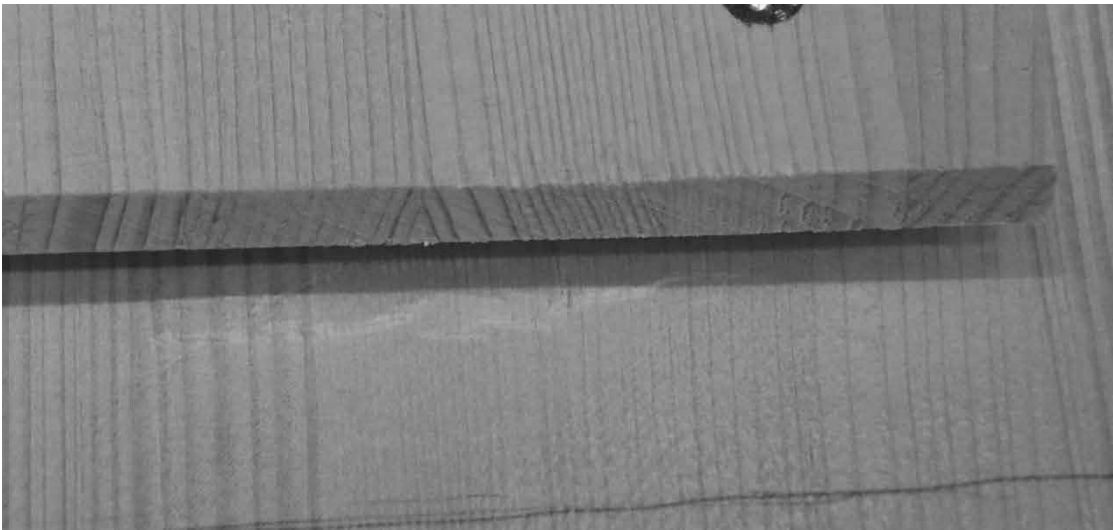
Abb. 2.21: Faserstauchung - Prüfkörper S-S-1 (Hersteller PS).
