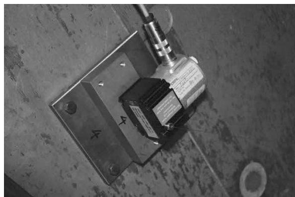
Abb. 5.15: Messung der Durchbiegungen in den Punkten D1 – D4 mit Seilsensoren des Typs WDS-1000-P60 (Log. Nr. 40.490).
