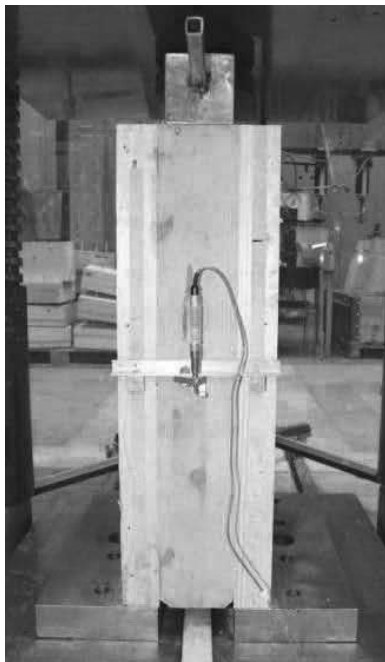
Abb. 3.12: Messung der Relativverschiebung zwischen Holz und Beton auf beiden Schmalseiten der Prüfkörper (Weg E bzw. Weg F).
