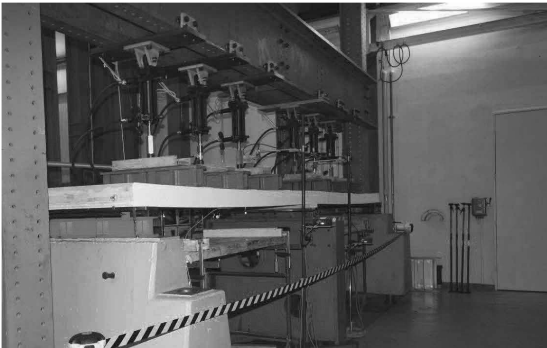
Abb. 5.31: Durchbiegung des Prüfkörpers mit mittigem Stoss nach 480 Minuten Belastung mit der 3-fachen Gebrauchslast.
