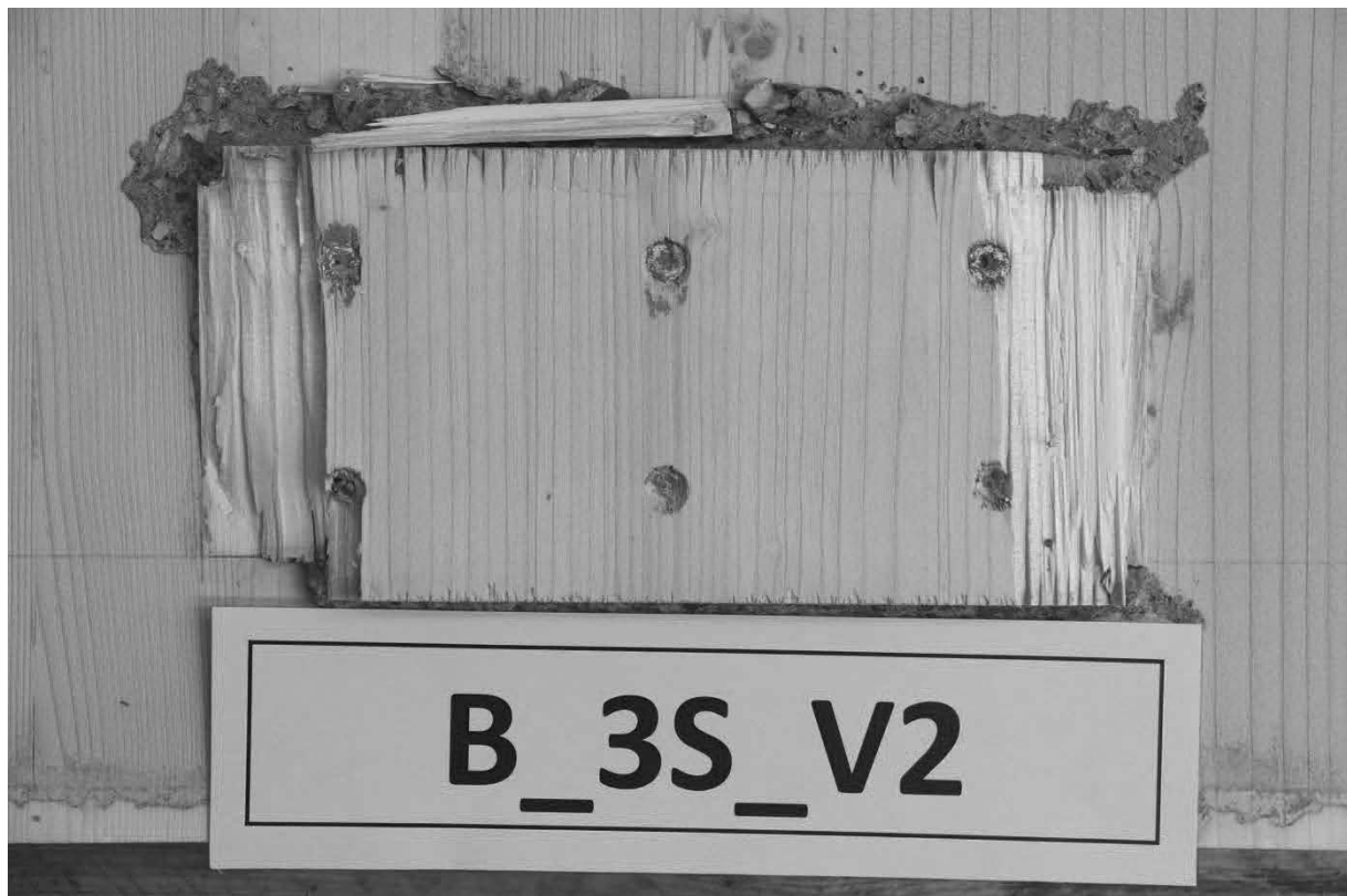
Abb. A.28: Hersteller B, Schubnocken zusätzlich verschraubt mit 3 Schrauben, Prüfkörper 2, untere Nocken.
