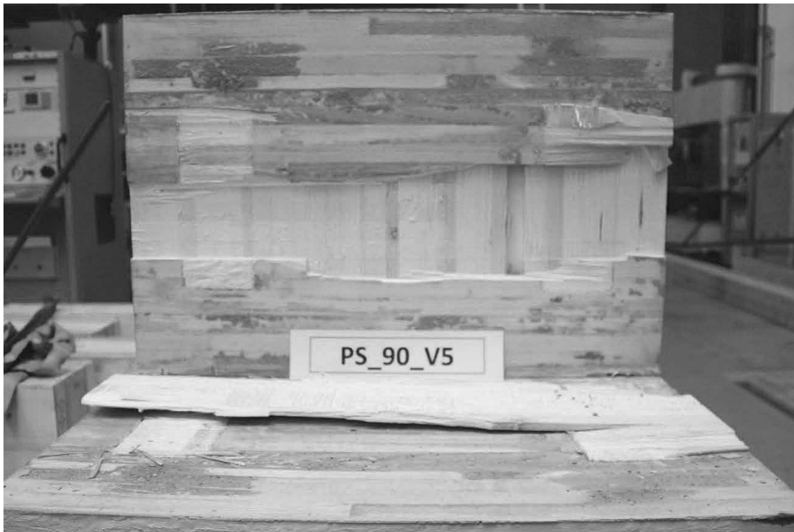
Abb. D.13: Hersteller A, Schubnocken ohne zusätzliche Verschraubung, Prüfkörper 5, Seite 1.
