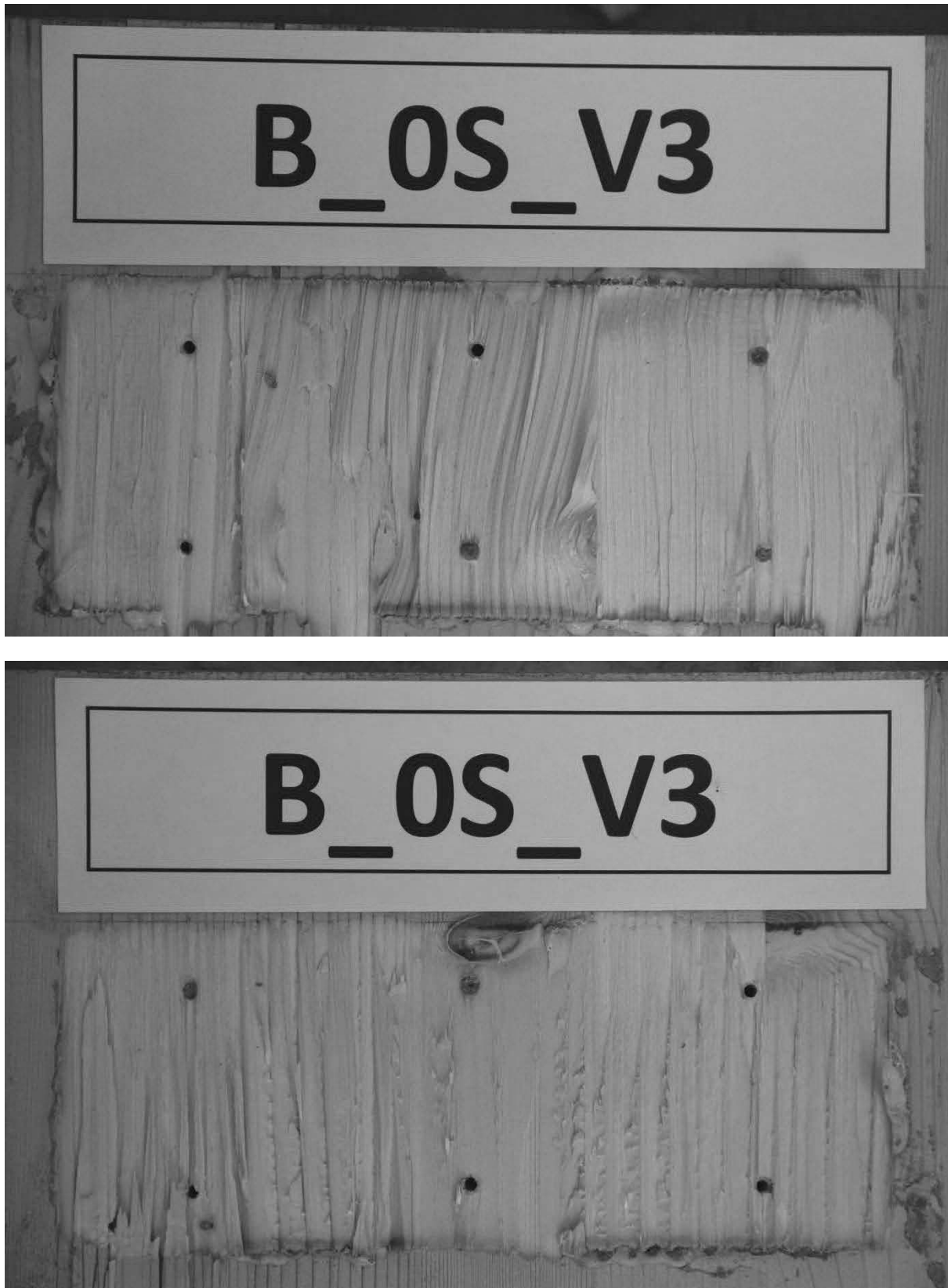
Abb. A.23: Hersteller B, Schubnocken ohne zusätzliche Verschraubung, Prüfkörper 3, obere Nocken.
