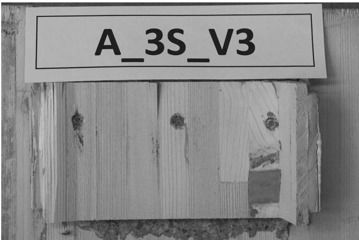
Abb. A.11: Hersteller A, Schubnocken zusätzlich verschraubt mit 3 Schrauben, Prüfkörper 3, obere Nocken.
