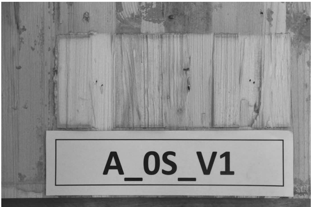
Abb. A.2: Hersteller A, Schubnocken ohne zusätzliche Verschraubung, Prüfkörper 1, untere Nocken.
