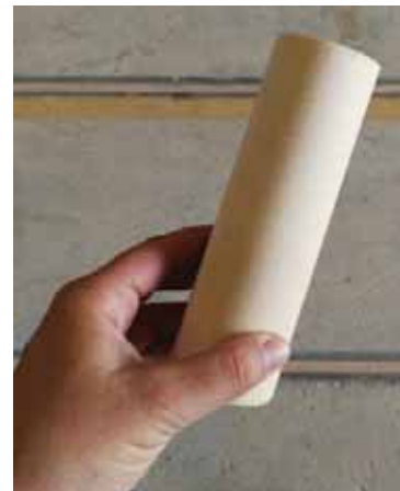
Abbildung 8: Holzdübel aus Fichte zum Verschluss der Bohrungen.
