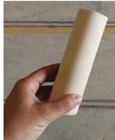
Abbildung 6: Holzdübel aus Fichte zum Verschliessen der Bohrungen.
