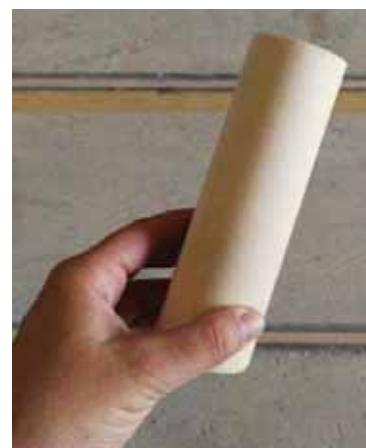
Abbildung 8: Holzdübel aus Fichte zum Verschluss der Bohrungen.
