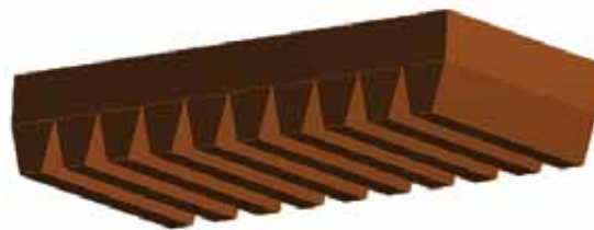
Abbildung 31: Trapezprofilierung der Unterdecke
