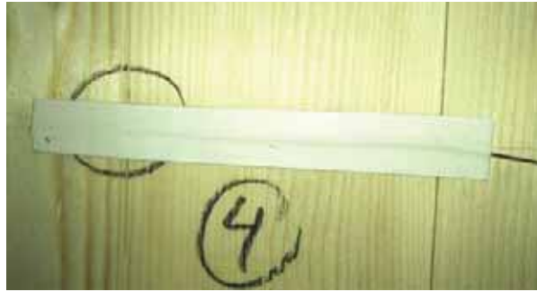
Abbildung 13: Befestigung eines Thermoelements.
