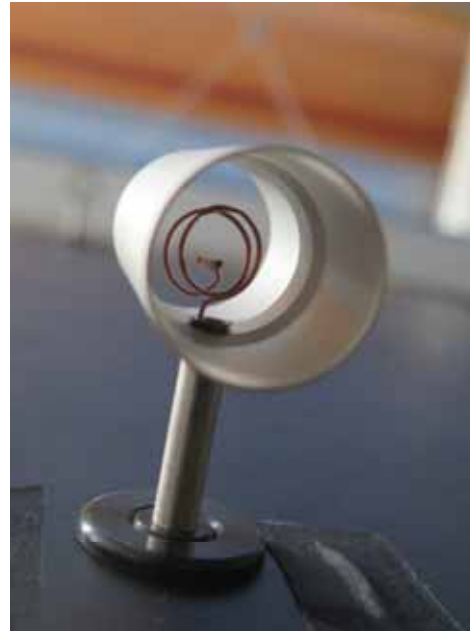
Abbildung 4: Detail des Thermoelementes innerhalb des Stahlzylinders.
