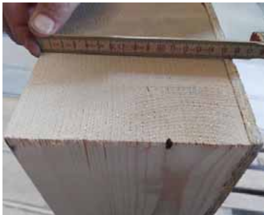
Abbildung 7: Schichtenaufbau des Probekörpers.
