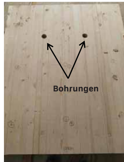
Abbildung 6: Ansicht des Prüfkörpers auf der Seite mit der Brettstapeldecke.
