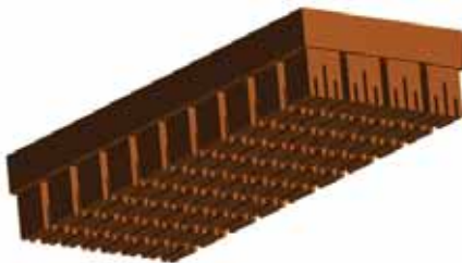
Abbildung 30: Doppelprofilierung der Unterdecke
