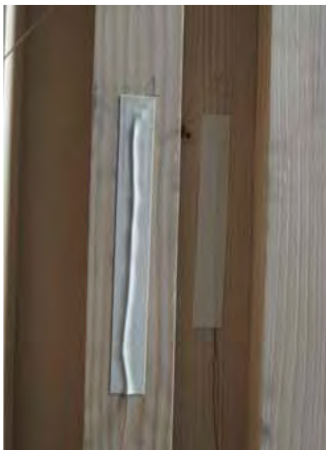
Abbildung 17: Befestigung zweier Thermoelemente. (links an der Oberseite des herausstehenden Brettes, rechts zwischen den Brettern)
