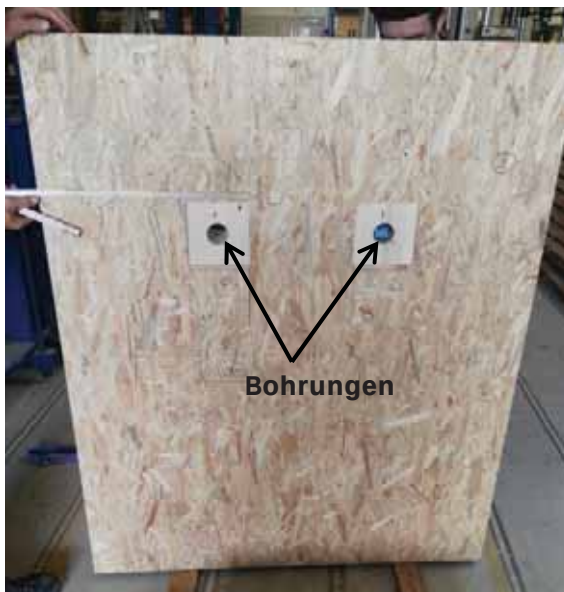
Abbildung 3: Ansicht der Seite des Probekörpers mit OSB-Platte.
