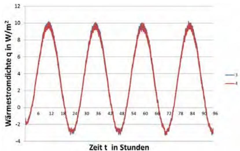
Abbildung 23: Wärmestromdichte des Testelementes aufgetragen über der Zeit für die Positionen 3 und 4 (an den Seiten der Bretter) der Wärmestromplatten.
