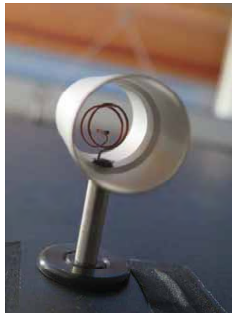
Abbildung 4: Detail des Thermoelementes innerhalb des Stahlzylinders.
