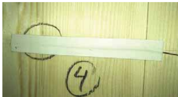
Abbildung 15: Befestigung eines Thermoelements.
