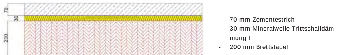
Abbildung 2 : Aufbau der Rohdecke des Deckentyps Brettstapeldecke
