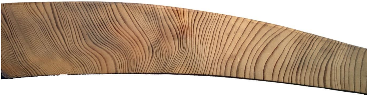
Fig. 12 Des tensions dans le bois entraînent des zones d'extension ou de réduction de la largeur des cernes
