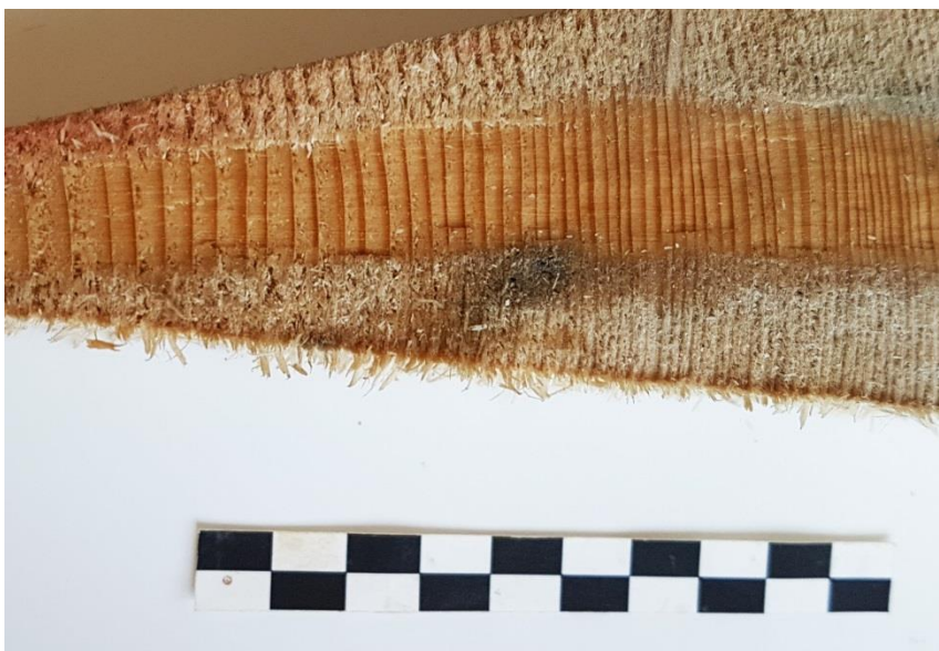
Fig. 16 Un chemin de mesure réalisé à l'aide d'une lame de rasoir.
