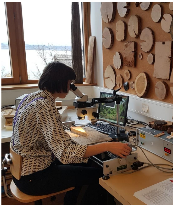
Fig. 17 Mesure d'un échantillon au 1/100 mm sur une table micrométrique.
