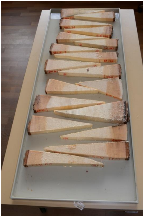
Fig. 15 Les prélèvements destinés aux mesures dendrométriques sont obtenus à l'aide d'une scie à ruban. Chaque section d'épicéa bénéficie de deux tranches permettant de définir la croissance moyenne.
