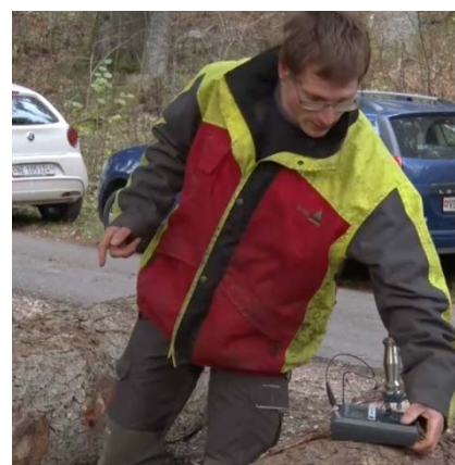
Fig. 4 Mesures de la vitesse longitudinale sur le billon
