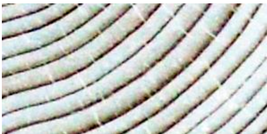
Fig. 27 La proportion de bois final ne doit pas dépasser 20% de la largeur totale du cerne de croissance.
