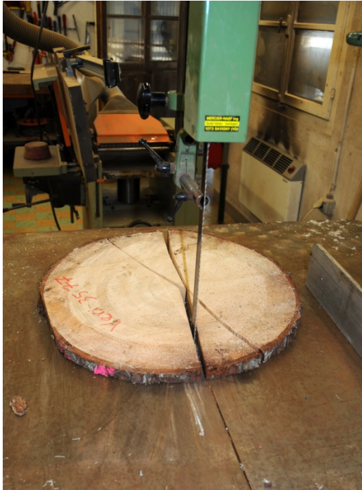
Fig. 5 Les prélèvements destinés aux mesures dendrométriques sont obtenus à l'aide d'une scie à ruban. Chaque section d'épicéa bénéficie de deux tranches permettant de définir la croissance moyenne.
