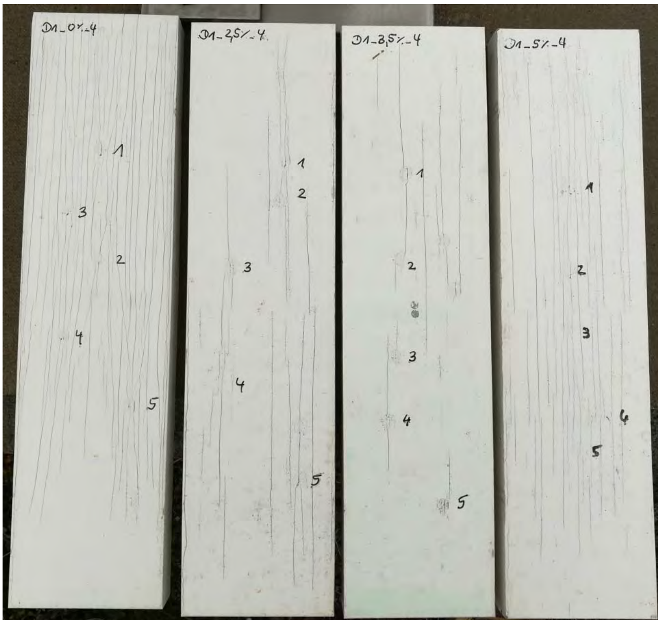
Abbildung 92 Beschichtung D1 mit Hageleinschlägen nach 1 Jahr Freibewitterung
