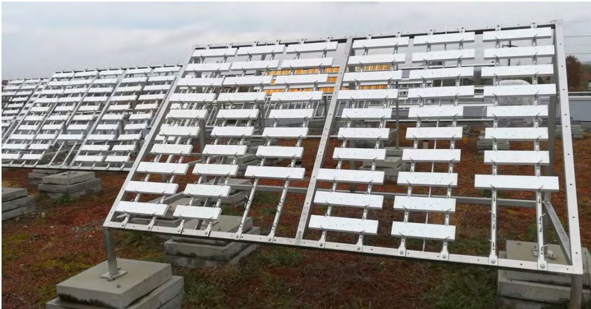
Abbildung 85 Behagelte Proben auf dem Freibewitterungsstand der Empa in Dübendorf
