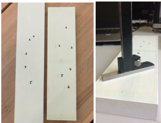
Abbildung 61 Markierung der Hageleinschüsse (links) und Messung der Eindringtiefe (rechts)
