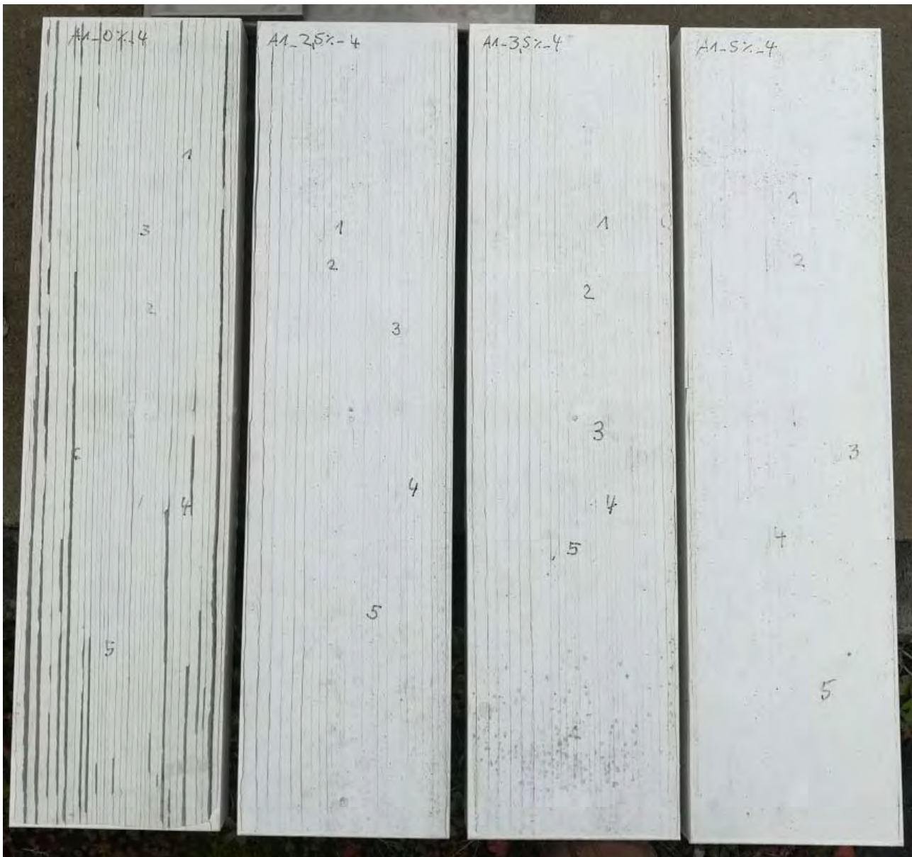
Abbildung 89 Beschichtung A1 mit Hageleinschlägen nach 1 Jahr Freibewitterung
