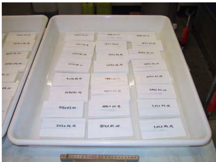
Abbildung 55 Wasserlagerung der Proben zur Bestimmung der Wasseraufnahme
