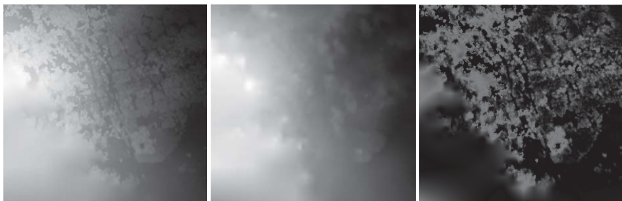
Abbildung 32: Aus den Drohnendaten errechnete Modelle: DOM (links), DGM (Mitte), nDOM (rechts) (Quelle: Bücken 2017)
