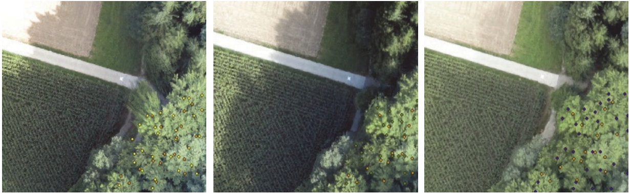
Abbildung 44: Sichtbarkeit des Maschinenstandorts (weisses Kreuz) auf verschiedenen Flughöhen (Links = 100m, Mitte = 140m, Rechts = 180m; orange = terrestrische Referenzbäume; gelb / grün / blau = mit FINT detektierte Bäume) in einem Ausschnitt der Marteloskopfläche Williwald (Massstab 1:500)
