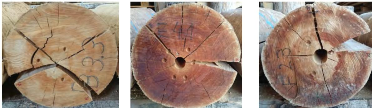
Abbildung 4.13: Rissausbreitung nach 14 Wochen Trocknung - Probenreihe B, E und F - Ø 50 cm
