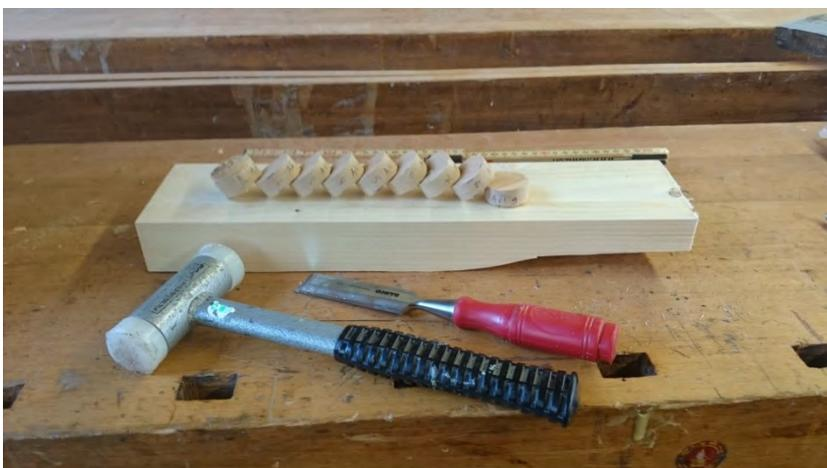
Abbildung 3.11: Ein Probestück zur Bestimmung der Holzfeuchte
