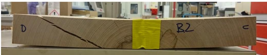
Abbildung 4.15: Verformung getrockneter Holzbohlen nach 2 Wochen über dem Wasserbad
