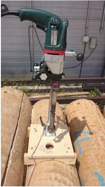
Abbildung 3.8: Bohrung der Kerne mittels Zapfenbohrer
