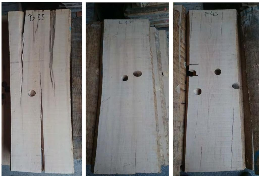
Abbildung 4.18: Aufgeschnittenes Buchenrundholz; ohne Kernbohrung (links), mit zentrierter Kernbohrung (Mitte) und mit dezentrierter Kernbohrung (rechts)
