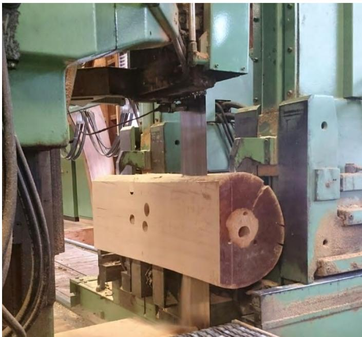
Abbildung 3.13: Zuschnitt der Bohlen mittels Bandsäge
