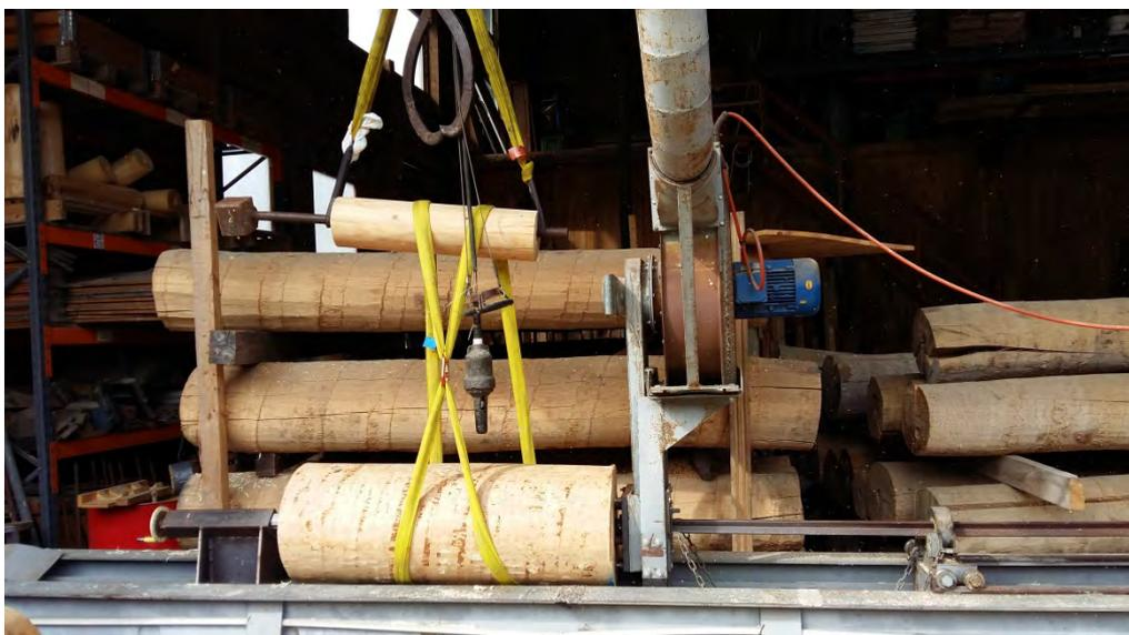
Abbildung 3.3: Kernbohrung der Rundhölzer für den laborbasierten Trocknungsversuch
