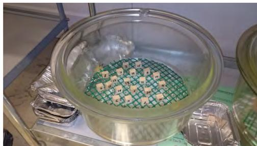
Abbildung 3.12: Holzwürfel zur Bestimmung des FSP    Abbildung 3.13: Exsikkator zur Befeuchtung (20°C / 100% rel. LF)
