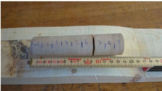
Abbildung 3.10: Aufteilen der Bohrkerns in 9 Probestücke
