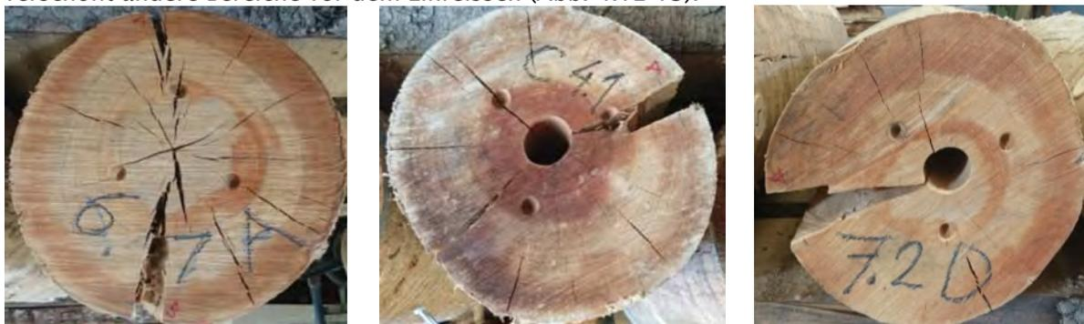
Abbildung 4.12: Rissausbreitung nach 14 Wochen Trocknung - Probenreihe A, C und D - Ø 30 cm
