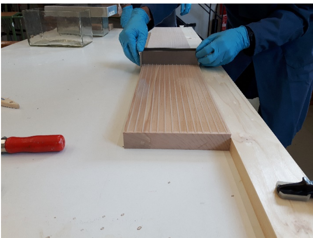
Bild 7: Klebstoffauftrag mit einem Rakel (links) und zwei BSH-Abschnitte in der Presse (rechts)
