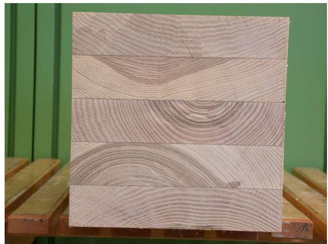
Bild 10: BSH-Abschnitte des Wirtschaftspartners neue Holzbau AG (links) und Beispiel-Querschnitt (B x H 200 x 200 mm 2 ) eines BSH-Abschnittes aus Esche (rechts)
