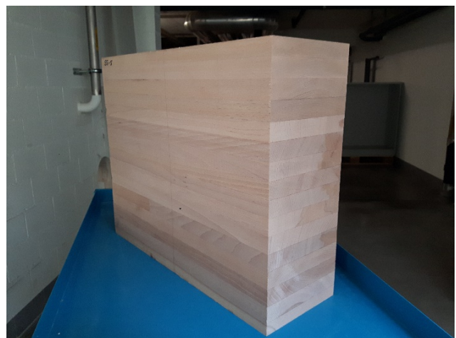
Bild 4: Entnahme von End-Abschnitten von geprüften BSH-Biegeträgern des Aktionsplan Holz Projektes 'Buchen-BSH' (links) und Beispiel eines BSH-Abschnittes für den nachfolgenden Zuschnitt von Delaminierungs- und Scherproben (rechts)
