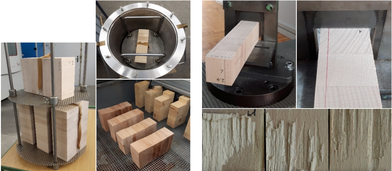
Bild 2: Prinzip der Delaminierungs- (links) und der Blockscher-Prüfung (rechts)
