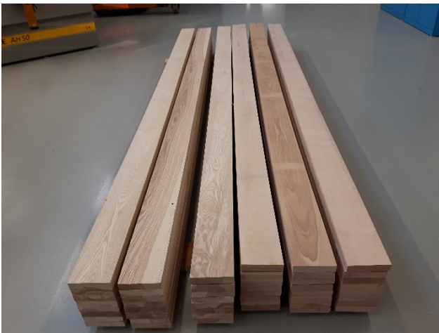
Bild 5: In Paketen zu 8 Stück sortierte, 4 m lange BSH-Rohlamellen (links) und frisch verklebte BSH-Abschnitte zur Konditionierung im Klimaraum vor der Prüfkörper-Entnahme (rechts)
