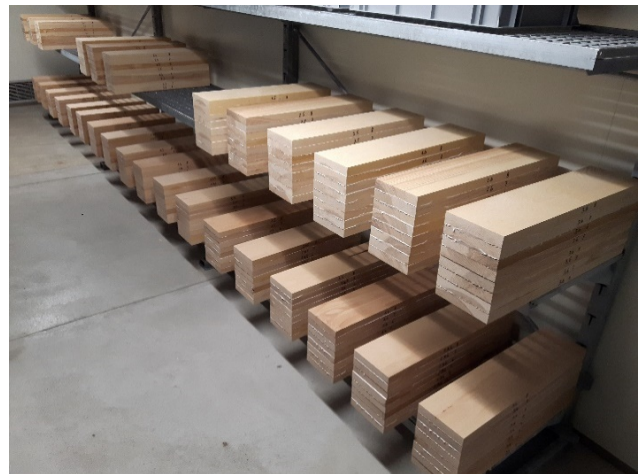
Bild 5: In Paketen zu 8 Stück sortierte, 4 m lange BSH-Rohlamellen (links) und frisch verklebte BSH-Abschnitte zur Konditionierung im Klimaraum vor der Prüfkörper-Entnahme (rechts)
