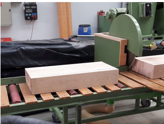
Bild 4: Entnahme von End-Abschnitten von geprüften BSH-Biegeträgern des Aktionsplan Holz Projektes 'Buchen-BSH' (links) und Beispiel eines BSH-Abschnittes für den nachfolgenden Zuschnitt von Delaminierungs- und Scherproben (rechts)
