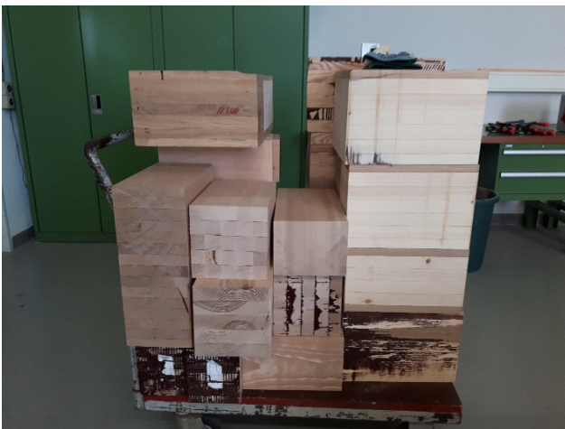
Bild 10: BSH-Abschnitte des Wirtschaftspartners neue Holzbau AG (links) und Beispiel-Querschnitt (B x H 200 x 200 mm 2 ) eines BSH-Abschnittes aus Esche (rechts)
