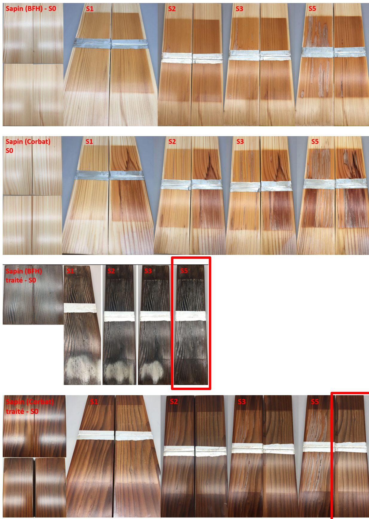
Figure 26 : Evolution de l'apparence des échantillons soumis à l'essai de vieillissement artificiel pendant 5 semaines (S0 à S5)
