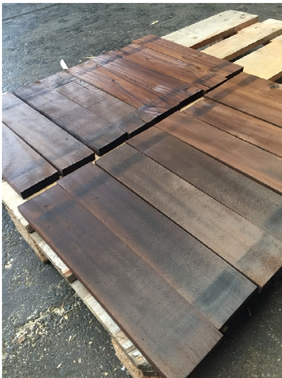
Figure 11: Photographies des échantillons après traitement thermique dans la chambre de traitement (Corbat Holding SA)
