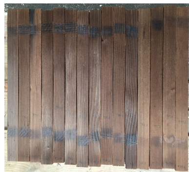
Figure 10: Photographie d'échantillons imprégnés disposés pour le traitement thermique à l'entrée de la chambre de traitement de Corbat holding
