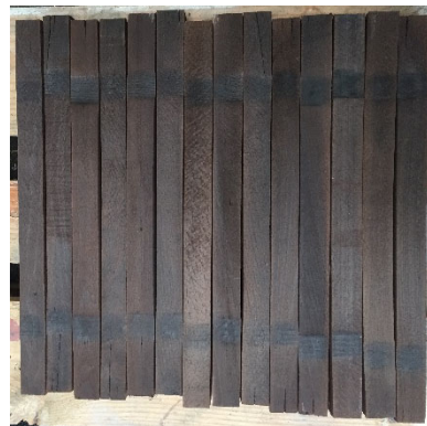
Figure 11: Photographies des échantillons après traitement thermique dans la chambre de traitement (Corbat Holding SA)
