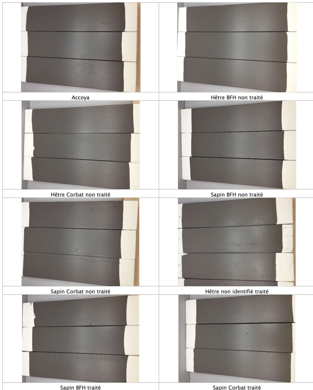
Figure 20 : Photographies d'échantillons revêtus par la peinture de pré-grisaillement en phase aqueuse
