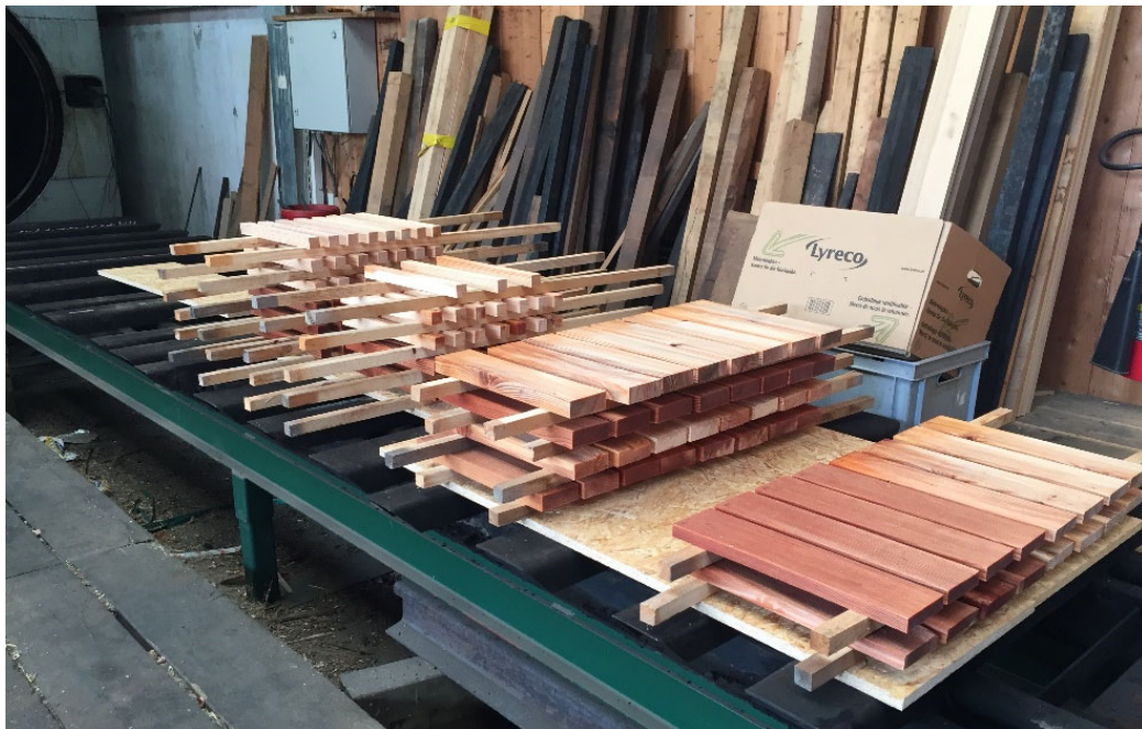
Figure 10: Photographie d'échantillons imprégnés disposés pour le traitement thermique à l'entrée de la chambre de traitement de Corbat holding
