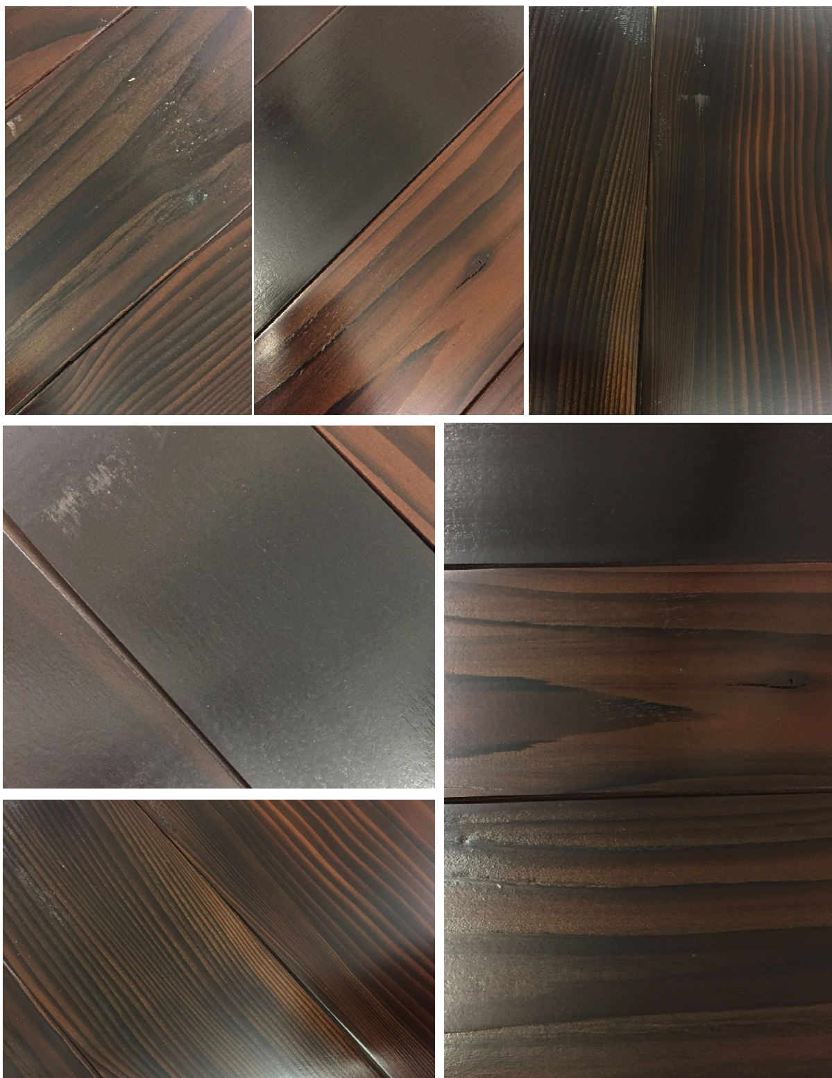
Figure 19 : Photographies d'échantillons de hêtre, sapin (Corbat) et sapin (BFH) traités, revêtus par le revêtement solvanté (Owedur 4126, Feyco Teknos), 2 couches – illustration de l'effet vivifiant du revêtement
