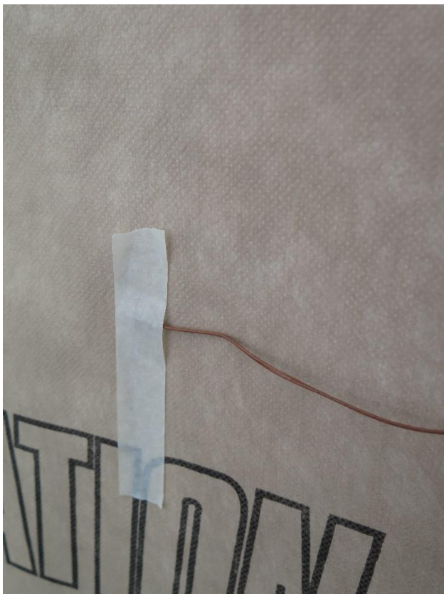
Abbildung 11 : Linkes Bild: Befestigung der Oberflächentempersensoren auf der Aussenseite der Prüfwände. Rechtes Bild: Installation der Aussenlufttemperatursensoren in einem Wetterschutzgehäuse.
