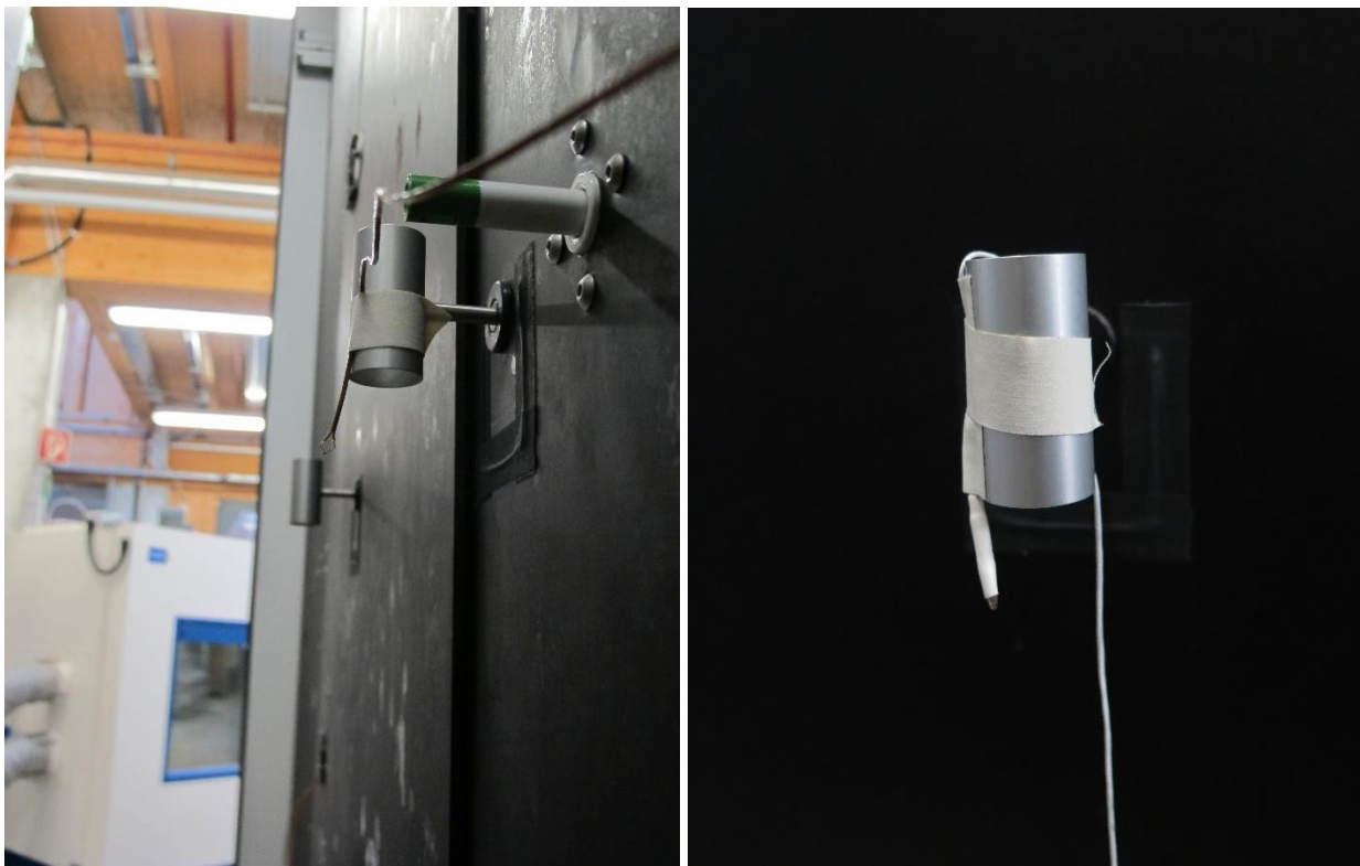
Abbildung 51 : Befestigung der Lufttemperatursensoren der In-Situ-Messgeräte (linkes Bild Almemo, rechtes Bild gSKIN) an den Strömungsabschirmungen der Lufttemperatursensoren der Hotbox.
