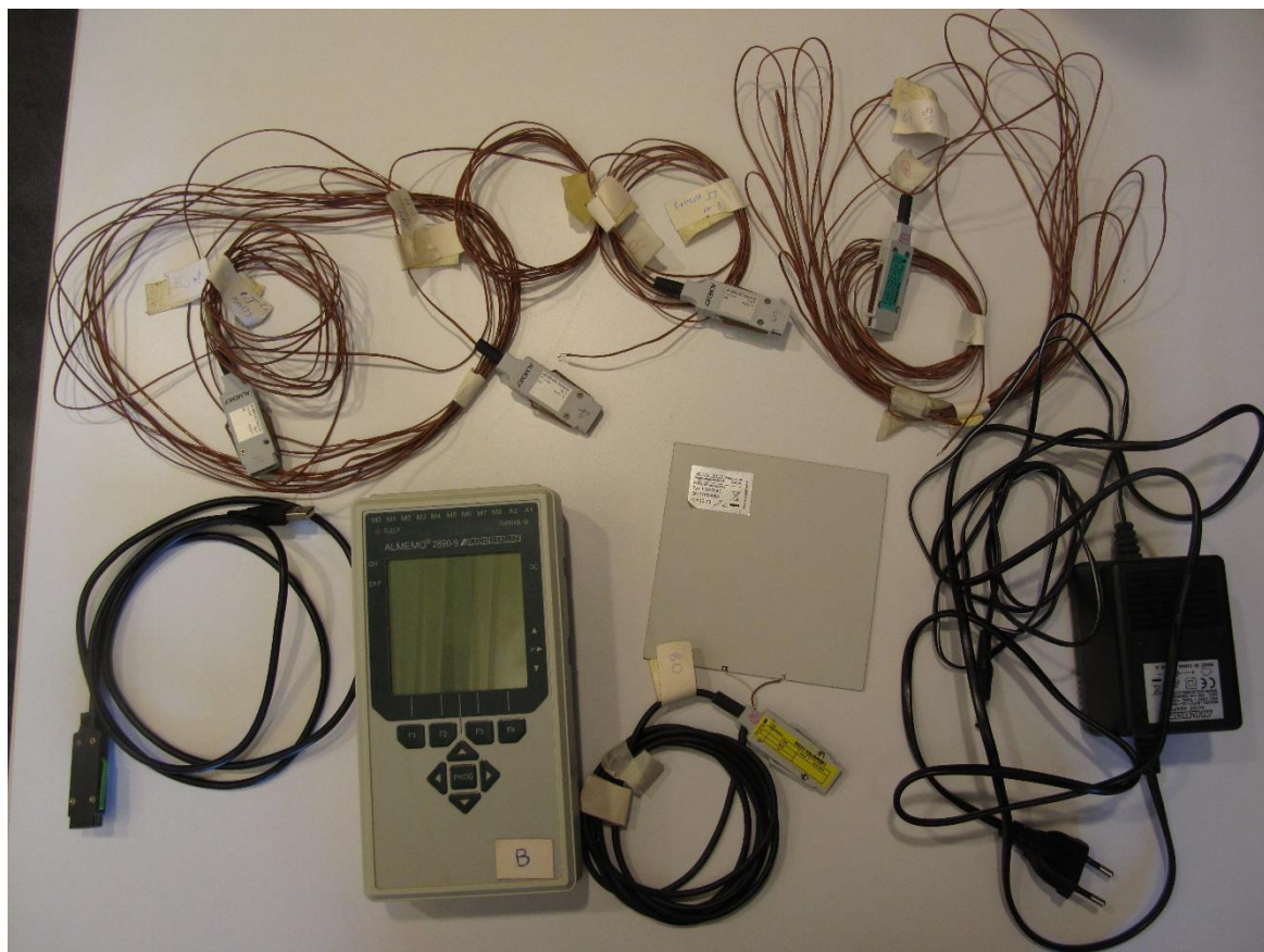
Abbildung 4 : Beispielhafte Aufnahme des Messsystems «Almemo®» der Firma Ahlborn GmbH, bestehend aus einer Wärmeleitfähigkeitsplatte (grau), vier Temperatursensoren (braun), einem Datenlogger (grau) mit Netzgerät (schwarz) sowie einem USB-Auslesekabel (schwarz).
