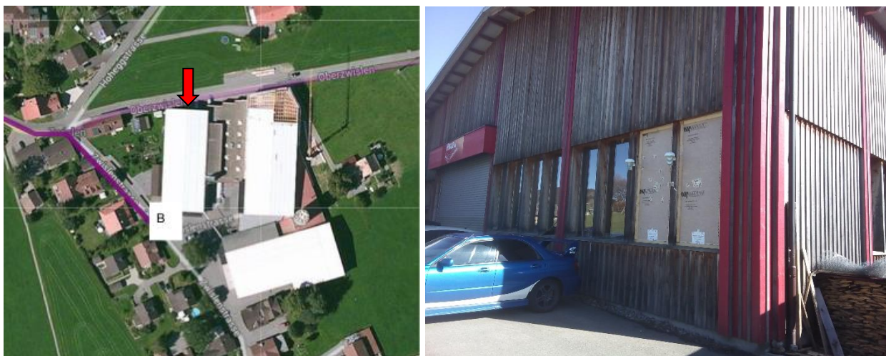
Abbildung 7: Links: Luftaufnahme des Produktionsgeländes der Firma Nägeli (Quelle: Google Earth). Die Fassade, in der die Prüfelemente eingebaut werden, ist mit einem roten Pfeil gekennzeichnet. Rechts: Ansicht der Testfassade mit Prüfelementen, eingebaut in Fensteröffnungen.
