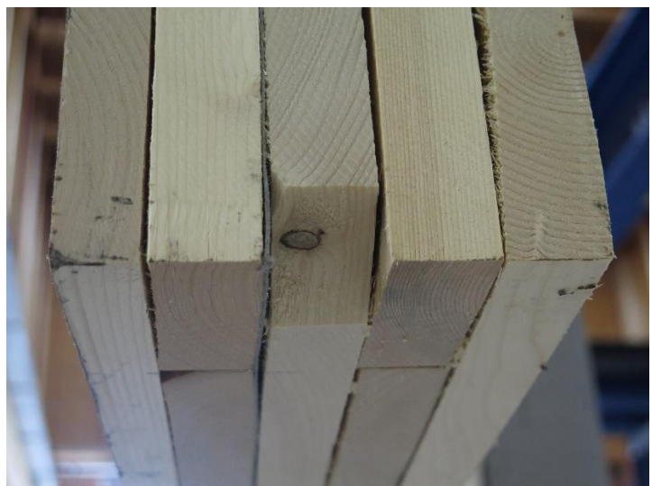
Abbildung 1 : Links: Schematische Zeichnung der untersuchten Massivholzelemente bestehend aus fünf Lagen Fichtenholz, verbunden mit Buchenholzdübeln. Zwischen den sägerauen Holzlagen befinden sich ca. 1 mm starke Luftspalte. In der Mitte und an der Aussenseite des Bauteils sind Winddichtungsbahnen angebracht. Rechts: Fotografie Prüfkörper.
