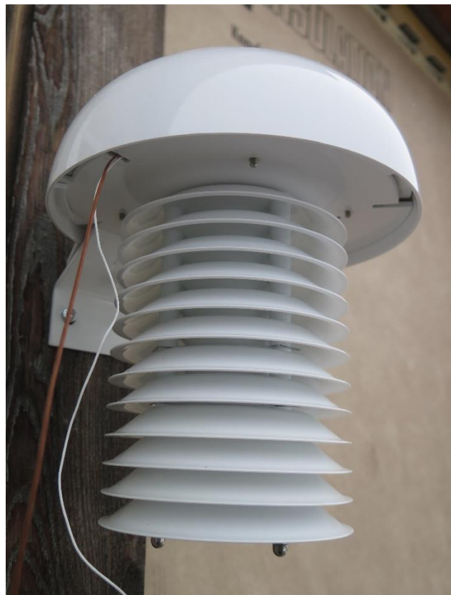
Abbildung 11 : Linkes Bild: Befestigung der Oberflächentempersensoren auf der Aussenseite der Prüfwände. Rechtes Bild: Installation der Aussenlufttemperatursensoren in einem Wetterschutzgehäuse.
