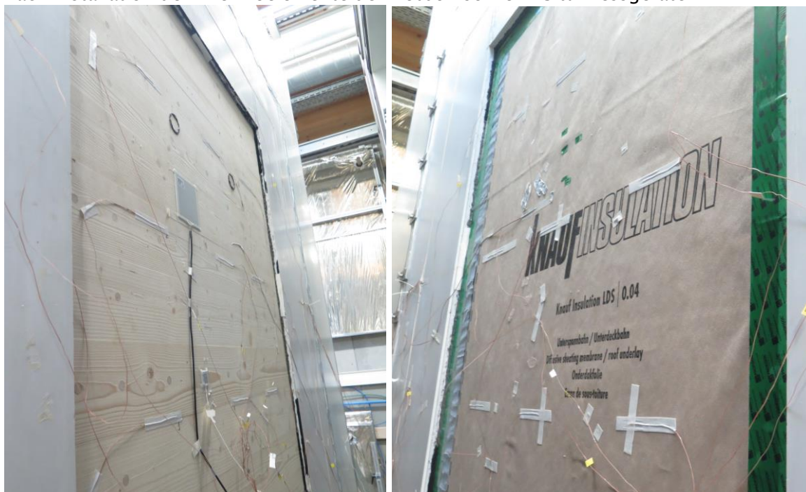
Abbildung 44 : Ansicht Prüfkörper Massivholzwand auf der Warm- (links) sowie Kaltseite (rechts) nach Installation der Thermoelemente der Hotbox sowie der Sensoren der In-Situ-Messgeräte.
