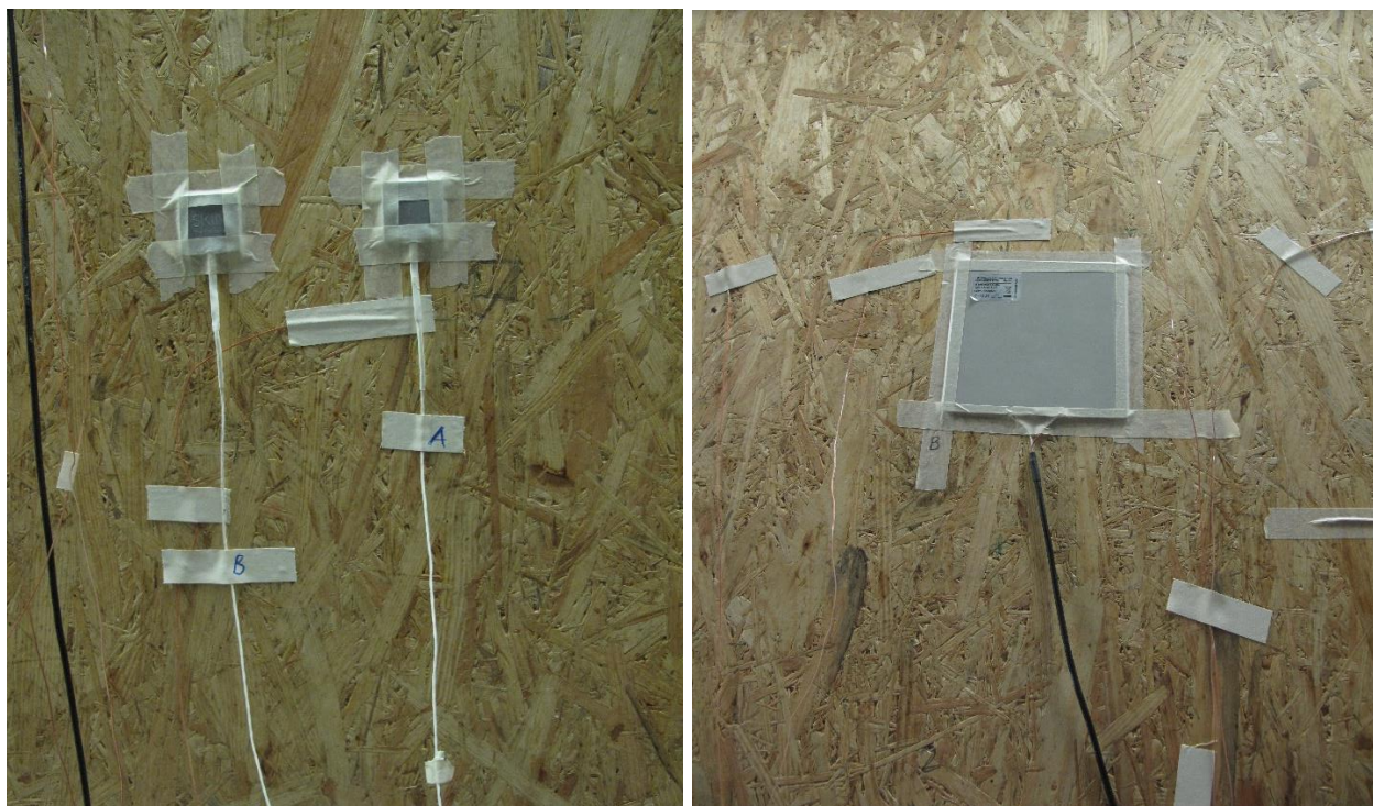
Abbildung 47 : Befestigung der gSKIN- (links) sowie Almemo-Wärmeflussplatten (rechts) mittels Klebeband auf der Holzständerwand.
