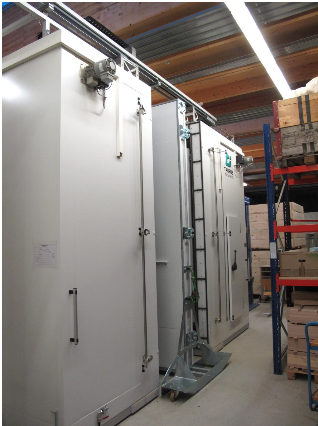
Abbildung 5 : Ansicht des geregelten Heizkastens im Labor der BFH AHB. Die linke Kammer stellt die Kaltseite dar, die rechte Kammer die Warmseite. Zwischen den zwei Kammern steht ein auf Rollen verfahrbarer Prüfrahm.
