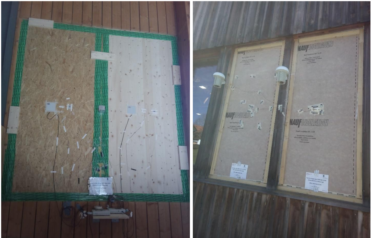
Abbildung 8 : Linkes Bild: Ansicht der Prüfkörper von innen. Auf der linken Seite die Holzständer- und auf der rechten Seite die Massivholzwand. Rechtes Bild: Ansicht der Prüfkörper von aussen. Auf der linken Seite die Massivholz- und auf der rechten Seite die Holzständerwand.
