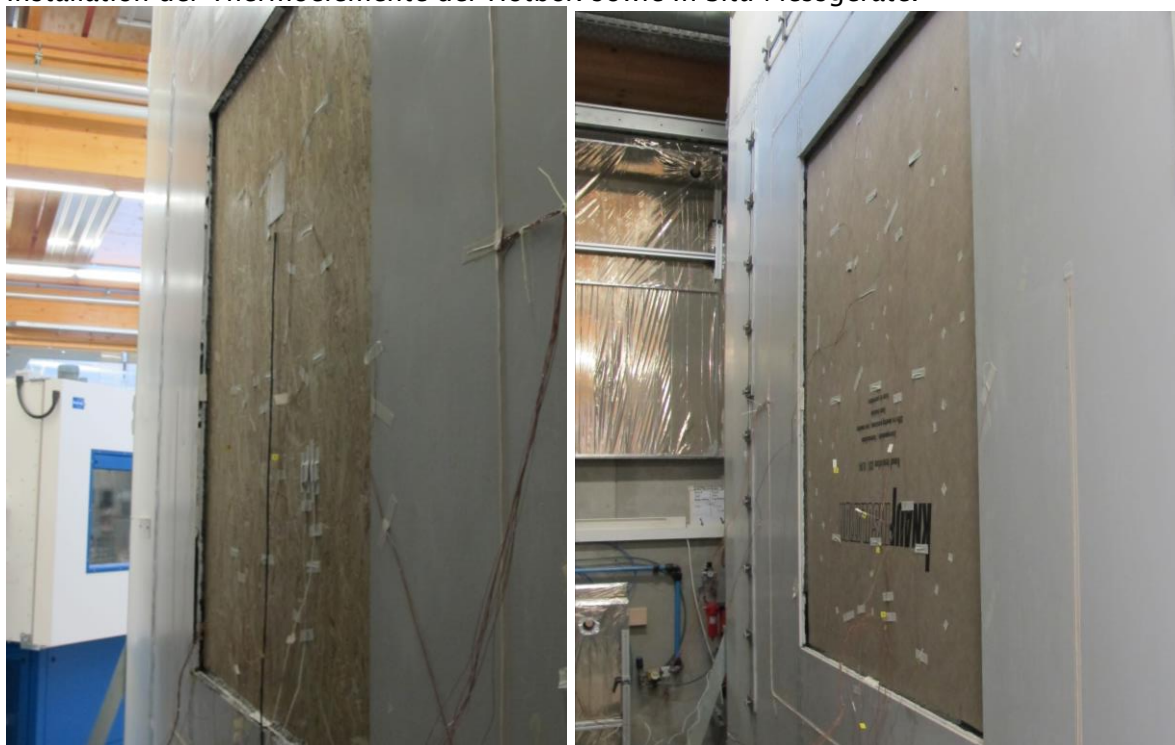
Abbildung 45 : Ansicht Prüfkörper der Holzrahmenwand auf der Warm- (links) sowie Kaltseite (rechts) nach Installation der Thermoelemente der Hotbox sowie der Sensoren der In-Situ-Messgeräte.
