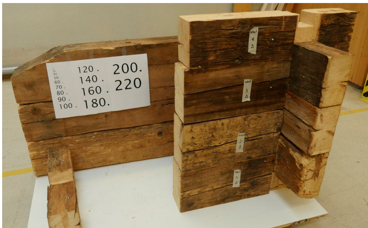
Abbildung 42: Modell der Walliser Blockbauwand: Ansicht von «innen» mit Markierungen für Abbund und Beschriftung
