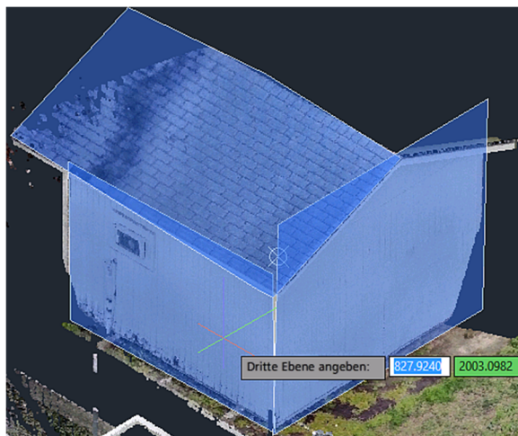
Abbildung 34: Segmentflächen zur Ermittlung des exakten Schnittpunktes/ Schittlinie
