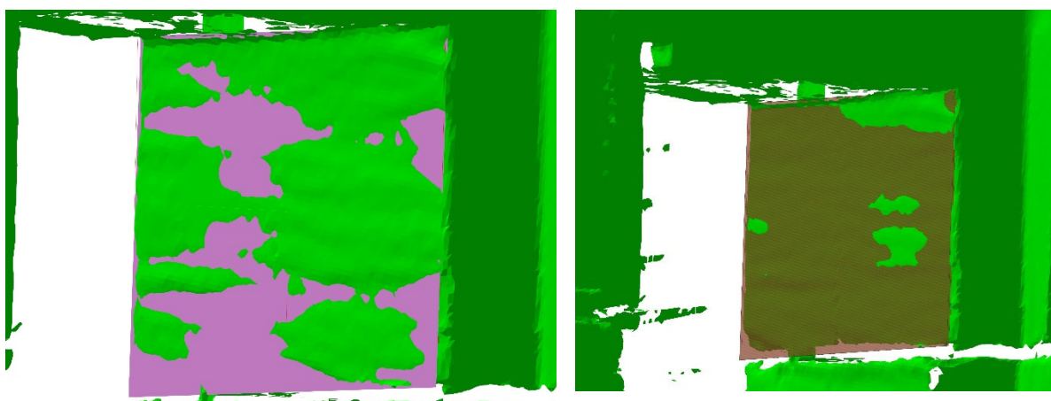
Abbildung 82: Verschieben und Rotieren der Fläche bis zur guten Übereinstimmung
