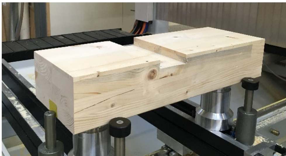
Abbildung 101: gefräste Aussparung der ersten Fläche
