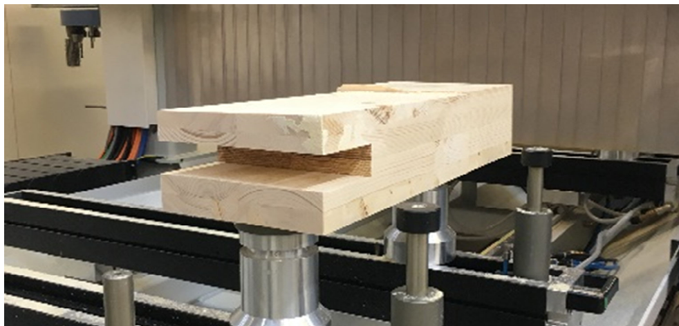
Abbildung 100: gefräste erste Fläche und gefräster Schlitz
