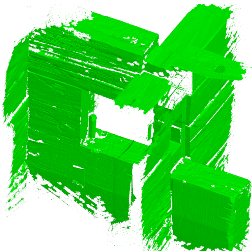
Abbildung 74: Drahtmodell/ Mesh des Scans mit «Handyscan 700»
