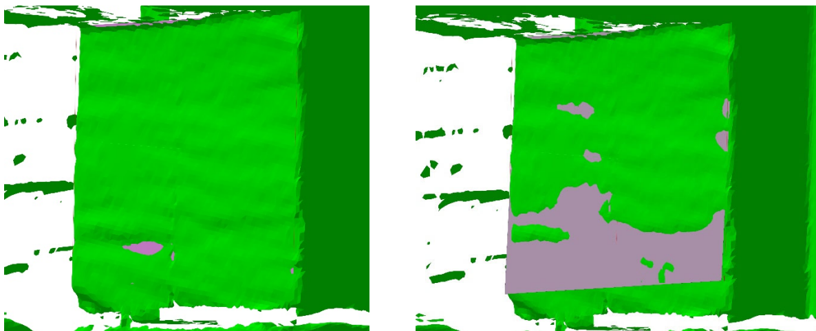
Abbildung 81: Verschieben und Rotieren der Fläche bis zur besseren Übereinstimmung
