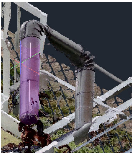
Abbildung 36: Segmentflächen zur Ermittlung der exakten Mittellinie des Volumens
