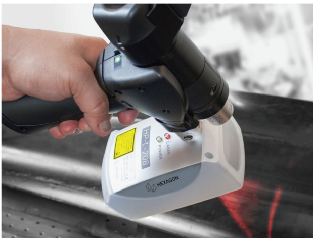
Abbildung 4: Rohmer Absolut Arm mit Laserscanner und generierte Oberfläche des Prüfstückes
