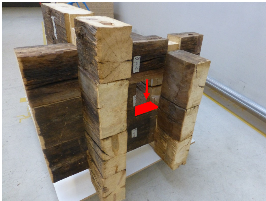
Abbildung 103: Referenzebene für den Winkel der Längsverbindung
