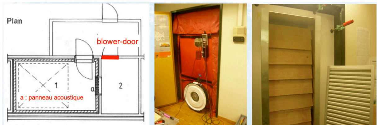
Figure 11 : Montage expérimental pour mesurer l'absorption acoustique et la résistance de l'air de grilles de protection d'un aérateur.
