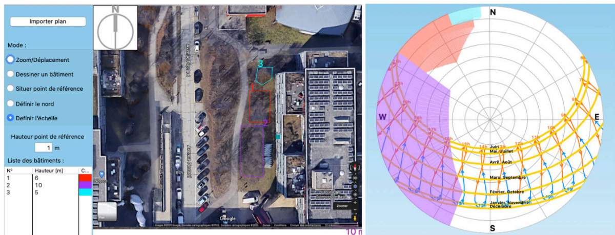
Figure 33 : Simulation des ombrages des arbres devant un des bâtiments de l'EPFL. Le bureau simulé est au rez-de-chaussée au milieu du bâtiment et les arbres de l'ensemble 1 sont de 6 m de hauteur, ceux de l'ensemble 2 de 10 m de hauteur et ceux de l'ensemble 3 aussi de 6 m de hauteur. Les arbres sont moins de 5 m de distance de la fenêtre. Sur le diagramme stéréoscopique, on voit qu'entre midi et 16 heures la façade est ensoleillée.
