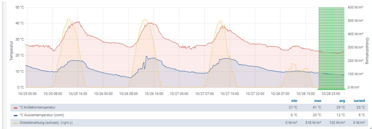
Abbildung 3: Anlage Nr. 4045 mit nachweislicher Nachtauskühlung einer Flachkollektor-Anlage.
