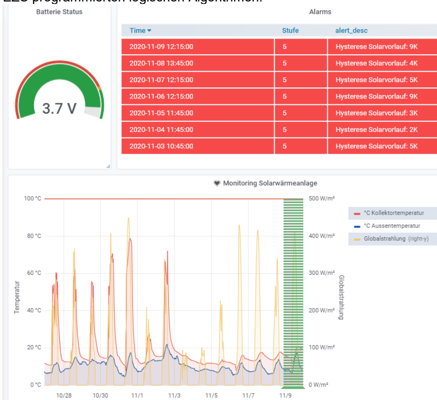
Abbildung 10: Automatische Fehlererkennung einer realen Anlagestörung im Herbst 2020.
