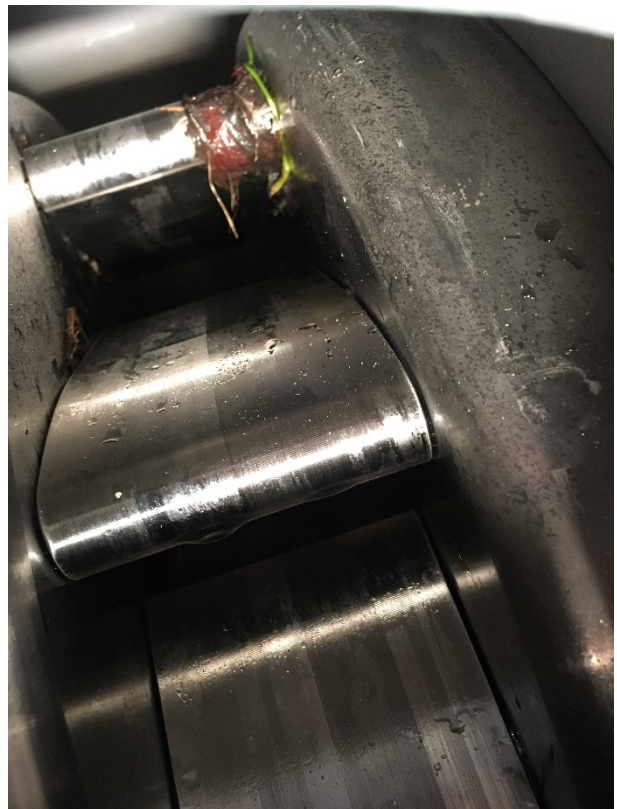
Abbildung 22: Geschwemmsel an den Leitschaufeln, welches sich jedoch durch Abstellen und Wiederanfahren der Turbine abschwemmen lässt (Quelle: Hydro Engineering 2019).
