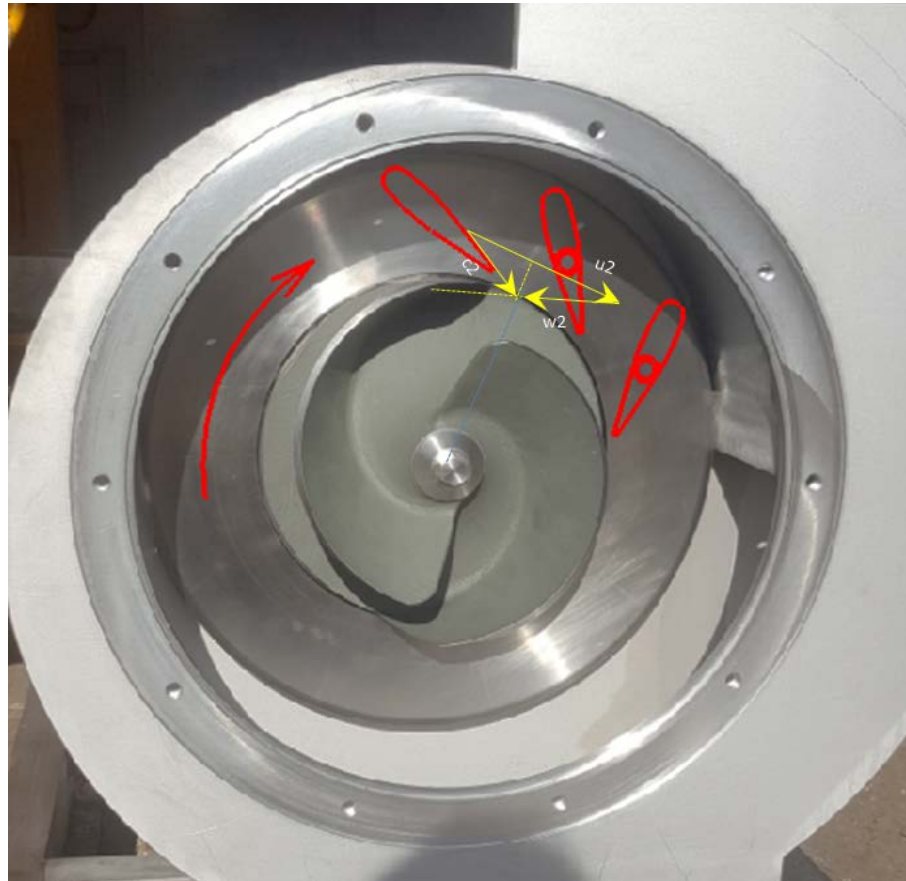
Abbildung 15: Geschwindigkeitsdreieck im Turbinenbetrieb (schematisch):
