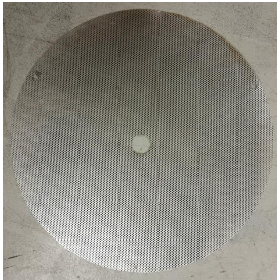
Abbildung 17: Lochblech "klein" mit Aussparungen zur Fixierung an den Halterungen im Klöpperboden und mittigem Ausschnitt für das Bogenrohr.
