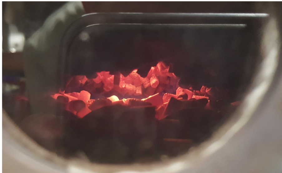
Abbildung 62: Verschlackung während dem Verbrennungsversuch an den Seitenwänden
