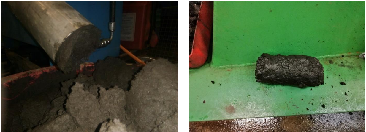
Abbildung 32: Ausgepresste Kohle ca. 50% TS. (a) Austrag bei Presse; b) Kohlepresskuchen)
