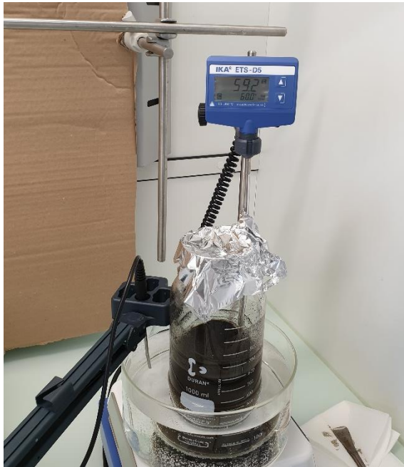
Abbildung A1: Wasserbad für Temperierung von Faulschlamm-HTC-Slurry vor der Pressung.
