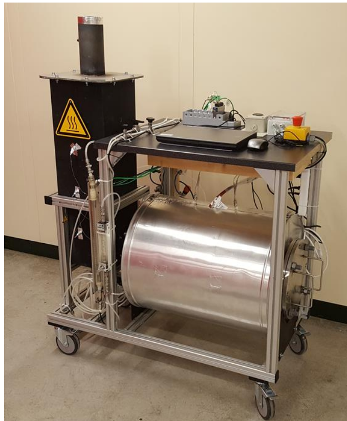
Abbildung 65: Aufbau der Batch-Pyrolyseanlage - PyroTube3000
