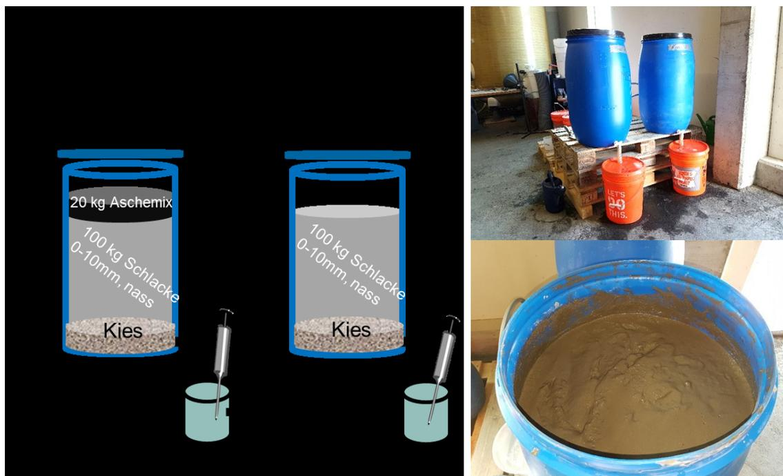
Abb. 4.20: (links) Schematische Darstellung des Technikumsversuches. Kaskade aus zwei mit Schlacke gefüllten Fässern und Sickerwasserbeprobung.
