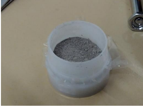
1: Probenbecher mit Mylar Film und Probematerial
