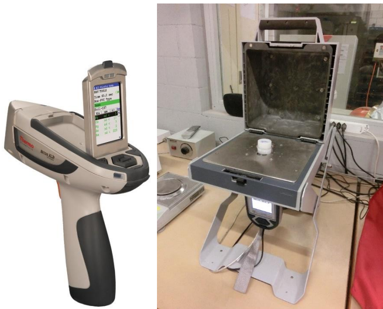
Abb. 2.3: Röntgen-Fluoreszenz Analysator NITON XL3t von Thermo Scientific und Messkammer mit aufgelegtem Probenbehälter.
