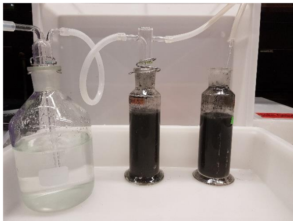
Abb. 3.3: Aufbau Wirkversuch. Gemische aus Holzasche und Eisensulfat in Wasser (Feststoff zu Wasser 1:10 und 1:20) werden mit reinem Sauerstoff begast.
