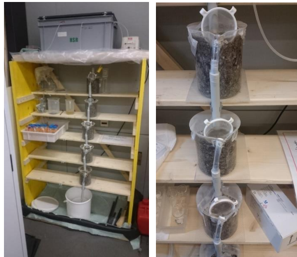
Abb. 4.13: Schema des Kaskadenversuches und Bild der Anlage. Chromatlösung wird in die Rohre in den Schlackenbechern aufgegeben und strömt nach oben durch die KVA-Schlacke. Im Überstand wurde der verfolgt, wann Chromat durchbricht
