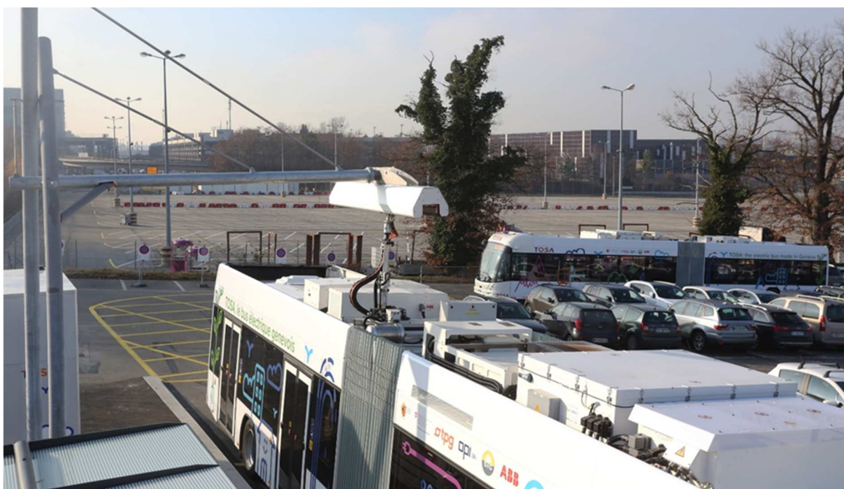
Figure 15 : Vue sur le toit du bus TOSA : le bras de recharge, l'électronique de puissance, les packs batterie. Source : Lumière noire, 2017.
