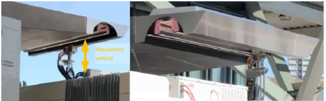
Figure 14 : mouvement vertical final (photo démonstrateur). Source : ABB, 2014.
