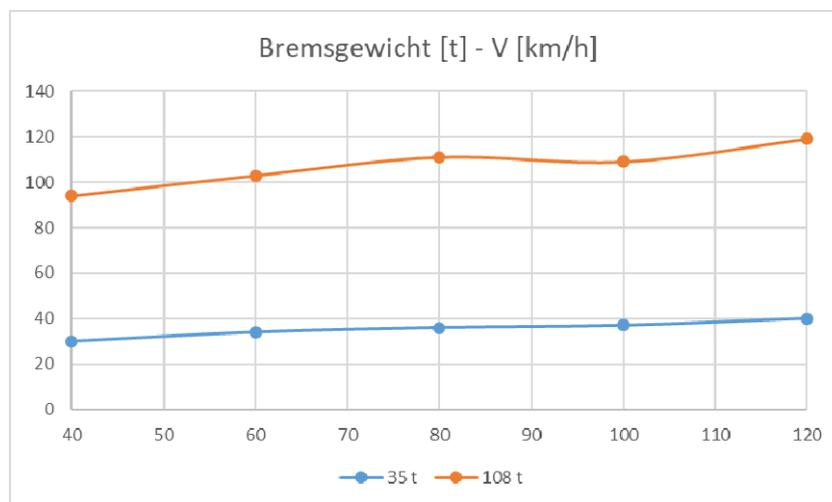
Abbildung 2 – Entwicklung des Bremsgewichts mit der Fahrgeschwindigkeit
