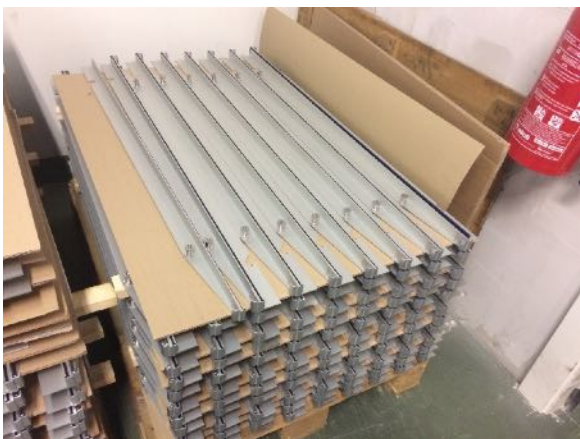
Abb. 33: Vorbereitete Backrails, einseitig mit Acrylschaumtape belegt.
