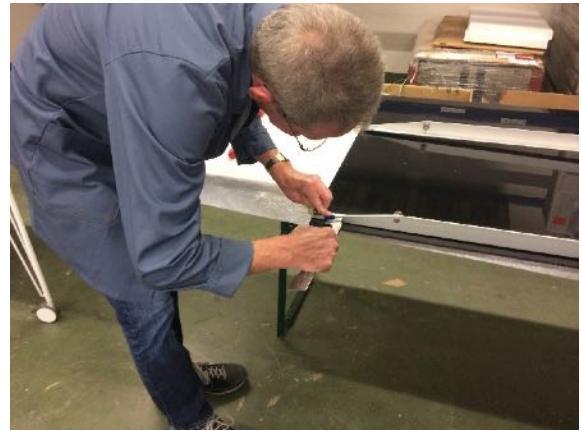
Abb. 36: Verkleben der Backrails auf der Rückseite des PV-Moduls.
