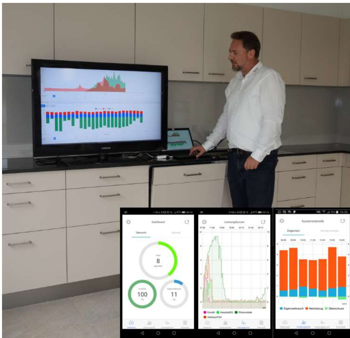
Abbildung 6: Visualisierung für Bewohner und Betreiber. Grosses Bild: Webportal auf PC mit Energiestatistik. Kleine Bilder unten: Portal auf Smartphone mit aktuellem Strompreis, Autarkiegrad/Eigenverbrauchsgrad, Leistungsverläufe, Statistik (Quelle: Smart Energy Control)
