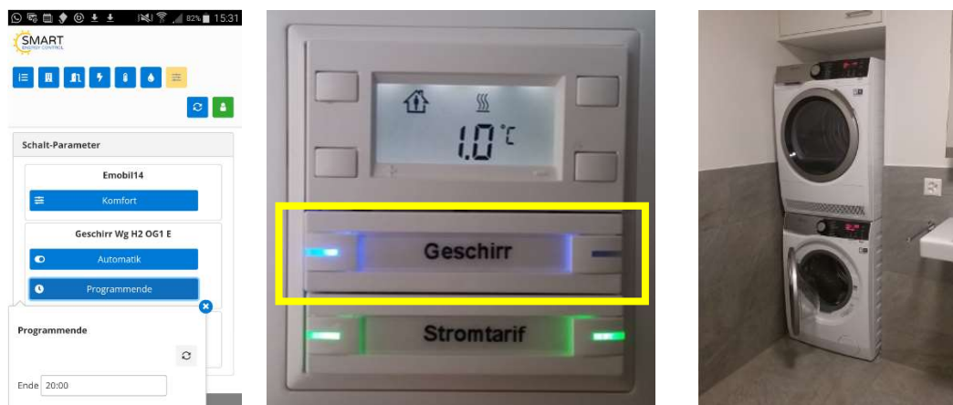
Abbildung 24: Intelligente Einbindung der Haushaltgeräte. Links: Bedienung über das Smartphone, Mitte: Bedienung über die KNX-Station, Rechts: Waschmaschine und Tumbler als Beispiel (Quelle: Smart Energy Control)
