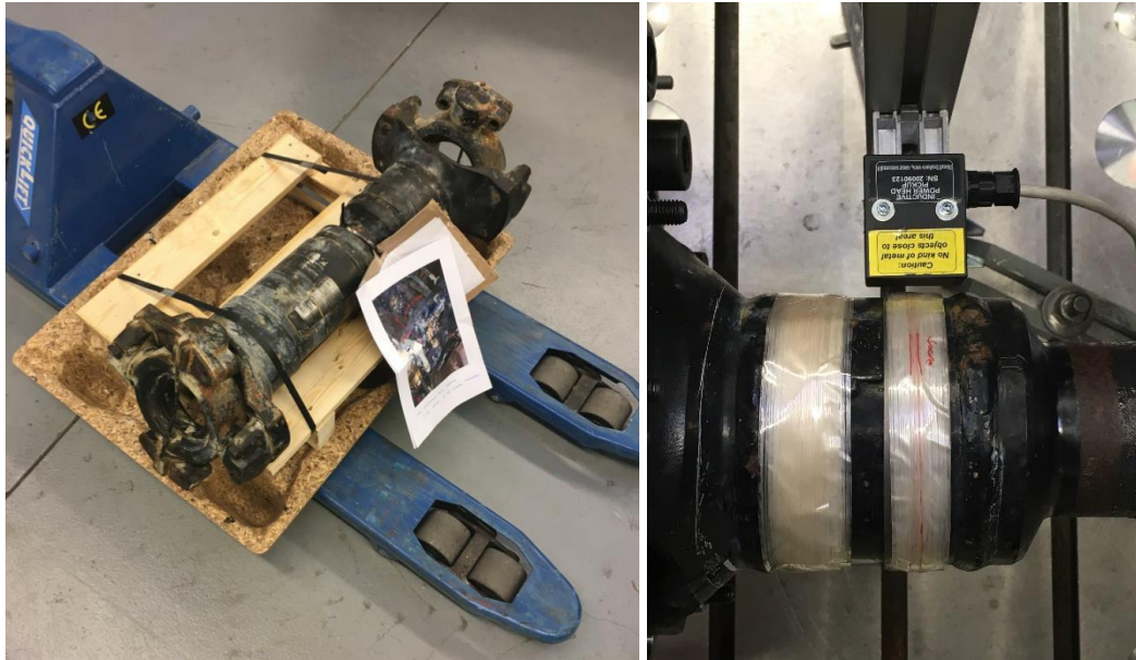
Abb. 1: Kardanwelle vor dem Anbringen der Drehmomentmessung (links) und während der Kalibrierung
