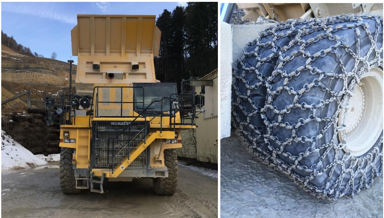
Abb. 2: Komatsu HD605-7 unterhalb der Entladestation / Steinbrecher mit angehobener Mulde (links), sowie die auf den Hinterrädern montierten Schneeketten.
