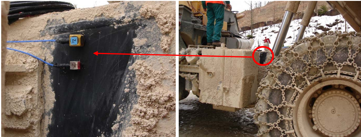
Abbildung 7: Sensorposition hinten links bei der Hydraulik
