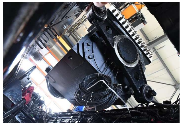
Bilder: Dieselmotor (o.l. und m.l.), Motorraum (o.r.), Elektromotor mit Getriebe (m.r.), Batterie auf dem Teststand (u.l. und Motor beim Einbau von unten (u.r.)
