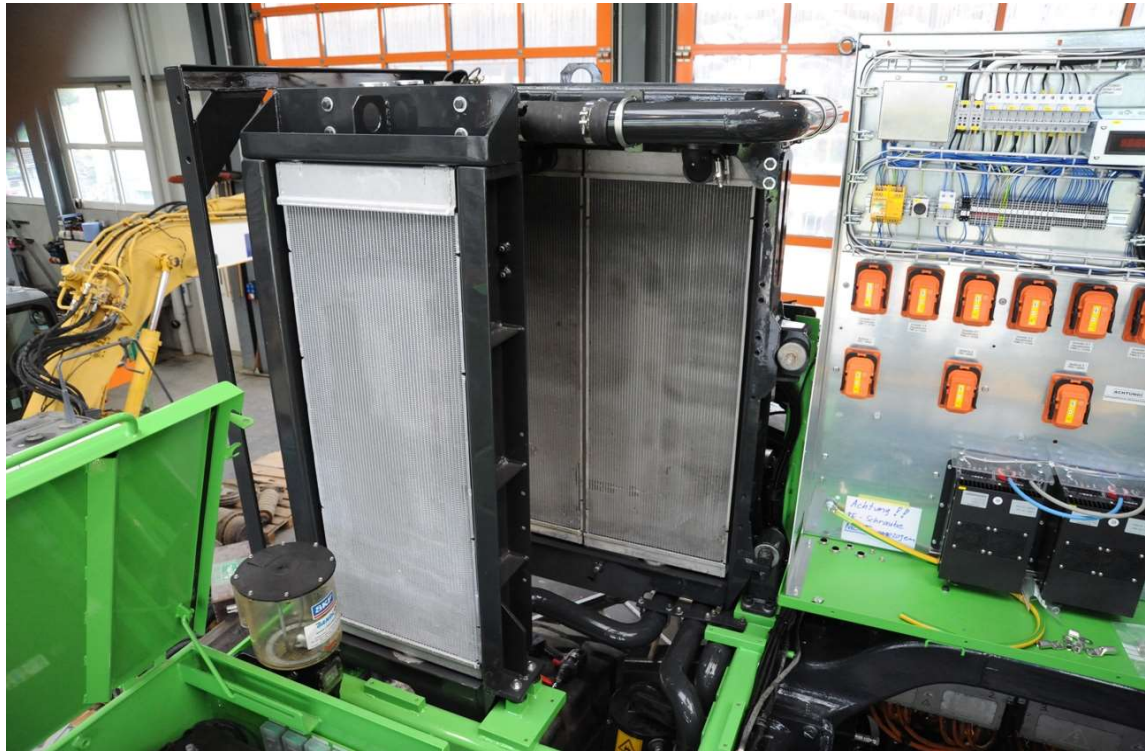
Neue Kühleranlage mit voller Leistung auch beim elektrischen Betrieb
