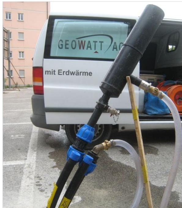
Figura 2-1: Piazzamento della sonda senza cavo NIMO-T per misurazioni della temperatura.
