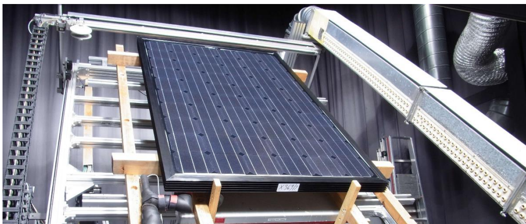
Abbildung 5: PVT-Kollektor auf dem Prüfstand des SPF
