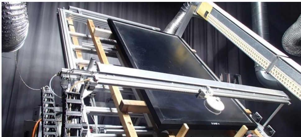
Abbildung 7: Der thermische Kollektor wird im SPF-Simulator getestet
